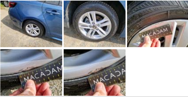
Alloy rim RL, Scratch(es), Repair/replace (lump sum)
