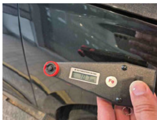
Lackstärke Kotflügel vorne rechts
