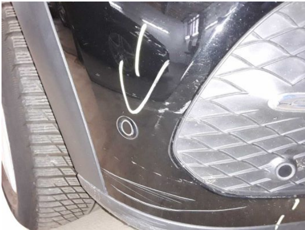
Beschädigung #13: Stossfänger vorn: Stossfänger vorn - verkratzt / verschürft - instandsetzen und lackieren
