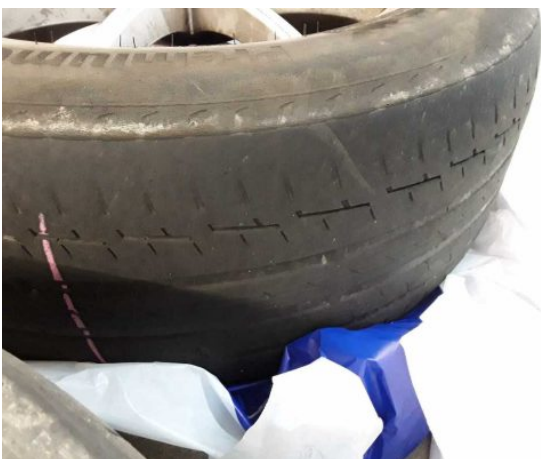
Beschädigung #7: 2.Radsatz: 2 Reifen - verschlissen - erneuern
