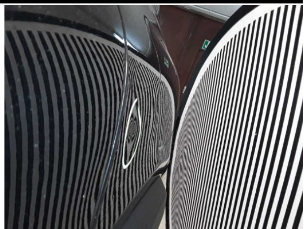
Beschädigung #6: Seitenwand links: Seitenwand - Delle(n) - sanft instandsetzen
