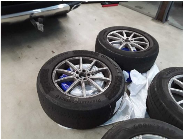
Beschädigung #7: 2.Radsatz: 2 Reifen - verschlissen - erneuern
