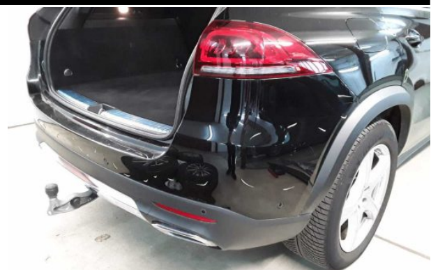
Beschädigung #11: Stossfänger hinten: Stossfänger hinten - verkratzt / verschürft - instandsetzen und lackieren
