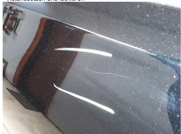
Beschädigung #14: Tür hinten links: Tür - verkratzt / verschü... - instandsetzen und lackieren
