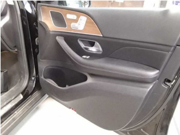
Damage #2: Trim / covers: Trim / covers (Einstiegsbeleuchtung fehlt) - Replace
