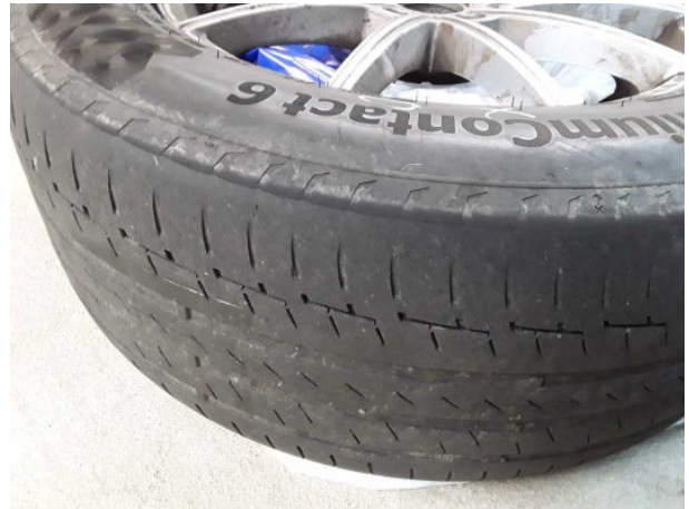
Beschädigung #7: 2.Radsatz: 2 Reifen - verschlissen - erneuern
