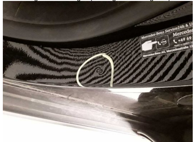
Beschädigung #3: Schweller links: Einstieg - Delle(n) - sanft instandsetzen
