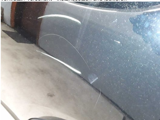
Beschädigung #14: Tür hinten links: Tür - verkratzt / verschüft - instandsetzen und lackieren
