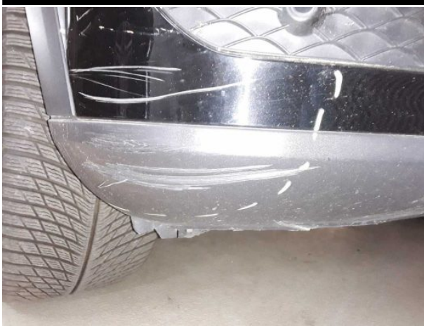
Beschädigung #10: Stossfänger vorn: Spoiler - verkratzt / verschürft - erneuern
