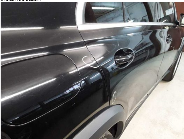
Beschädigung #4: Seitenwand rechts: Seitenwand - Delle(n) - sanft instandsetzen
