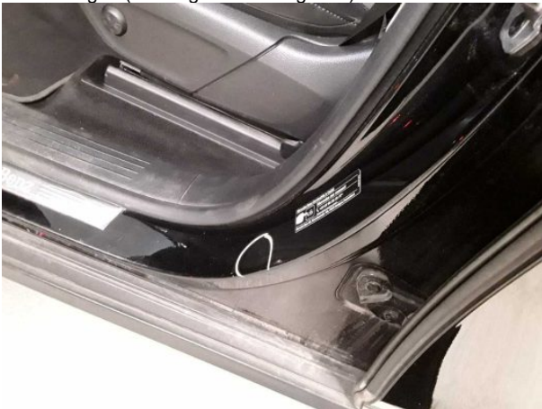
Beschädigung #3: Schweller links: Einstieg - Delle(n) - sanft instandsetzen
