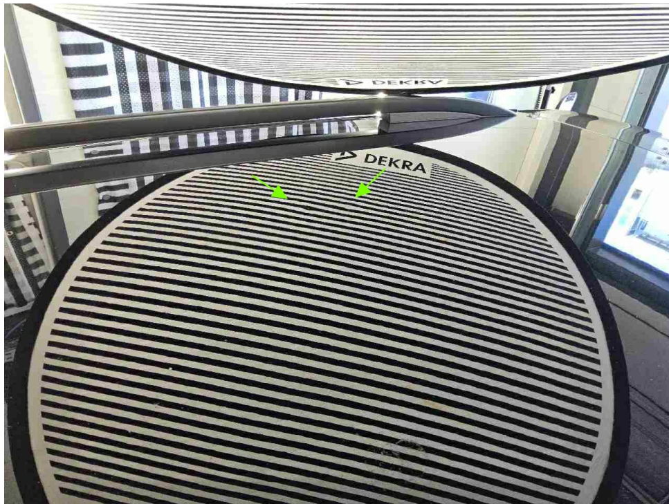
Bild 17 : Dach, mehrfach eingedellt
