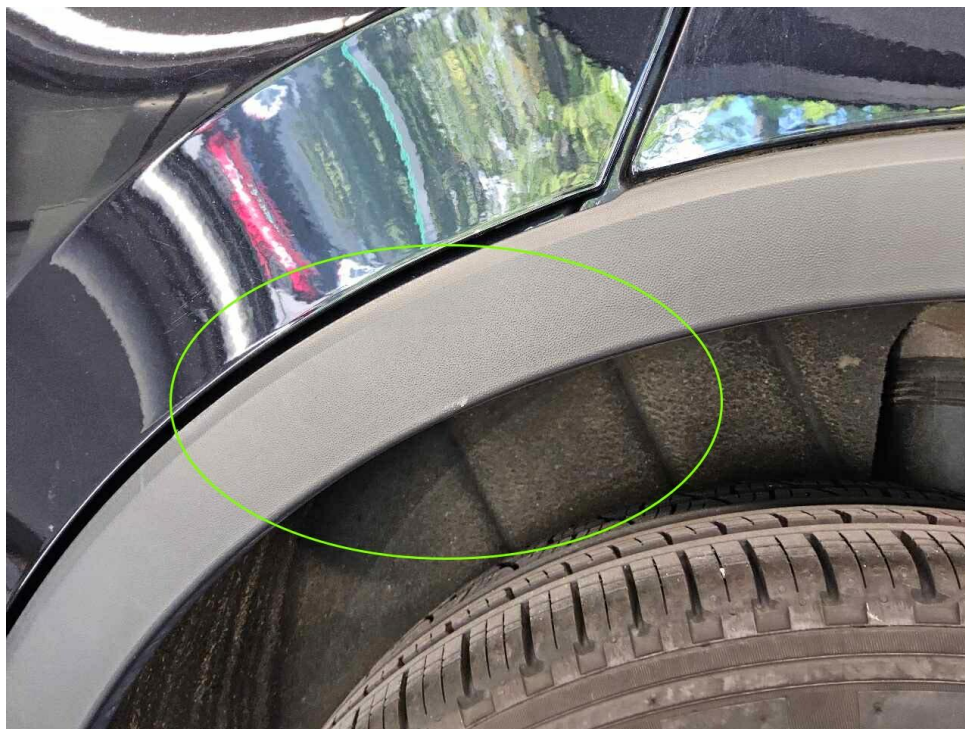
Bild 26 : Radlaufblende hinten links, verkratzt
