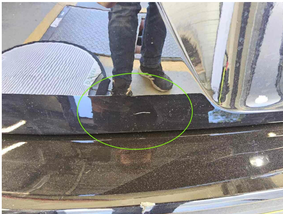
Bild 22 : Stoßfänger hinten, verschrammt mit Materialabtrag/ Heckklappe unterhalb verschrammt
