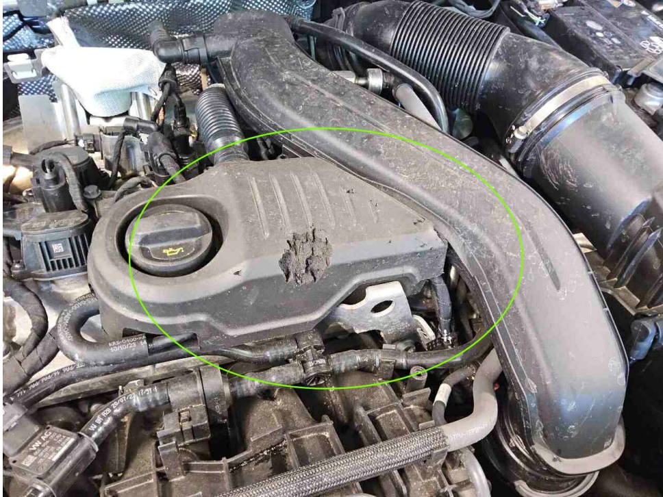
Bild 30 : Dämpfung Motor tierverbiss.
