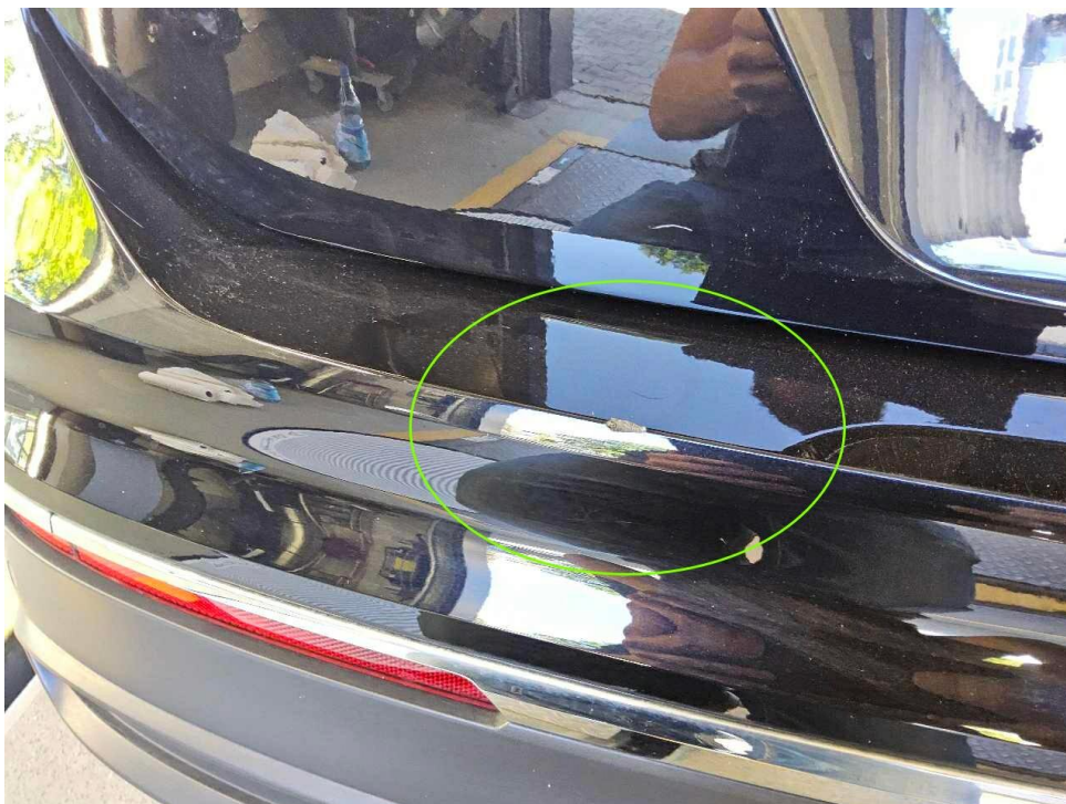
Bild 20 : Stoßfänger hinten, verschrammt mit Materialabtrag/ Heckklappe unterhalb verschrammt
