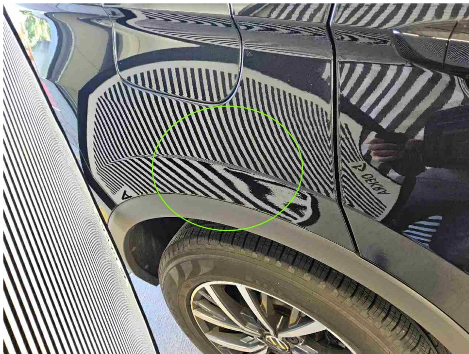
Bild 24 : Seitenteil hinten rechts, eingedellt
