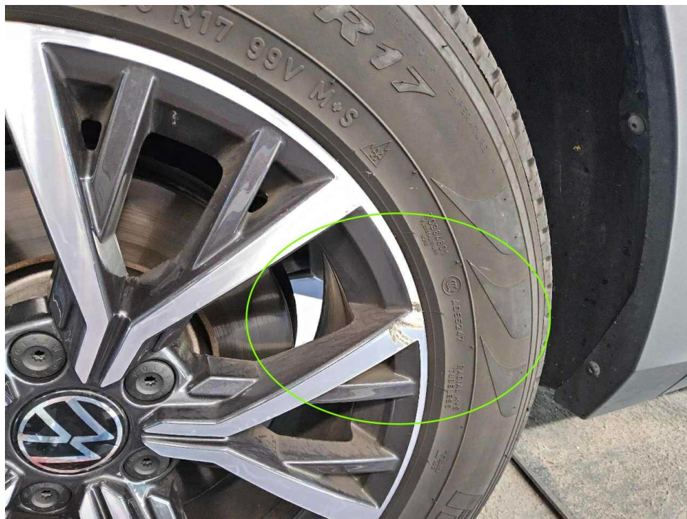
Bild 25 : Felge vorne links, glanzgedreht verschrammt
