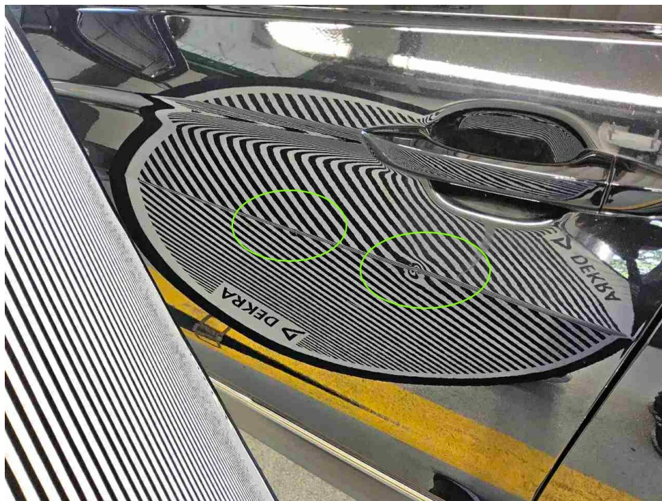
Bild 15 : Tür vorne links, mehrfach im Kantenbereich eingedrückt
