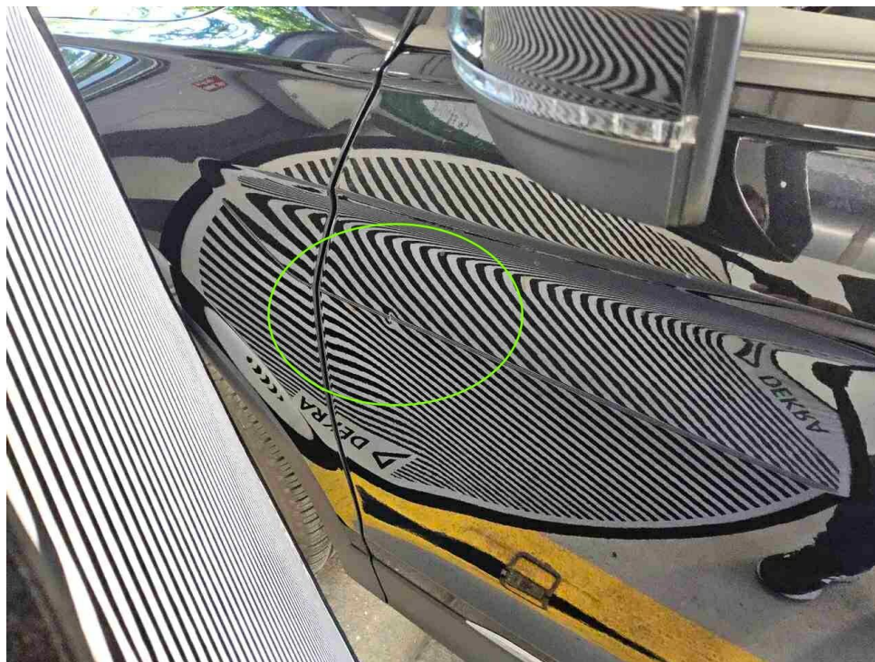
Bild 14 : Tür vorne links, mehrfach im Kantenbereich eingedrückt
