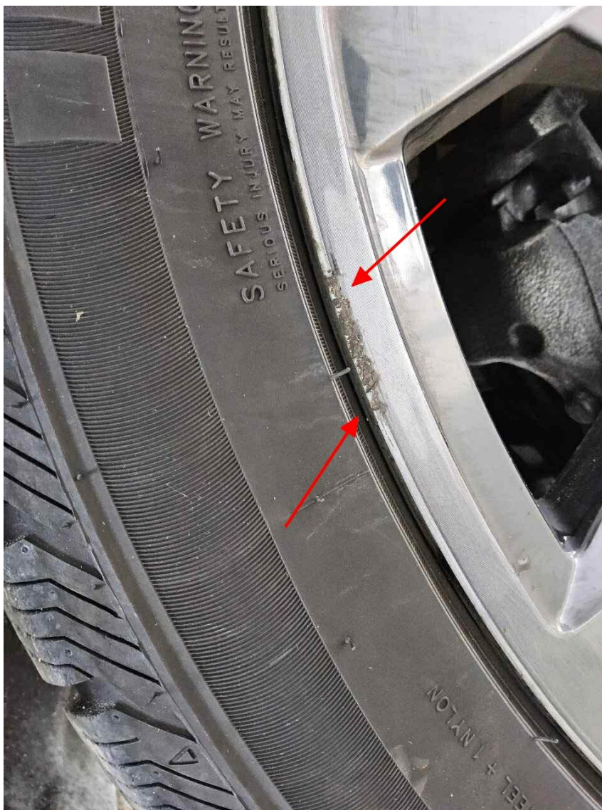
Bild 11 : Leichtmetallfelge vorne links zerkratzt
