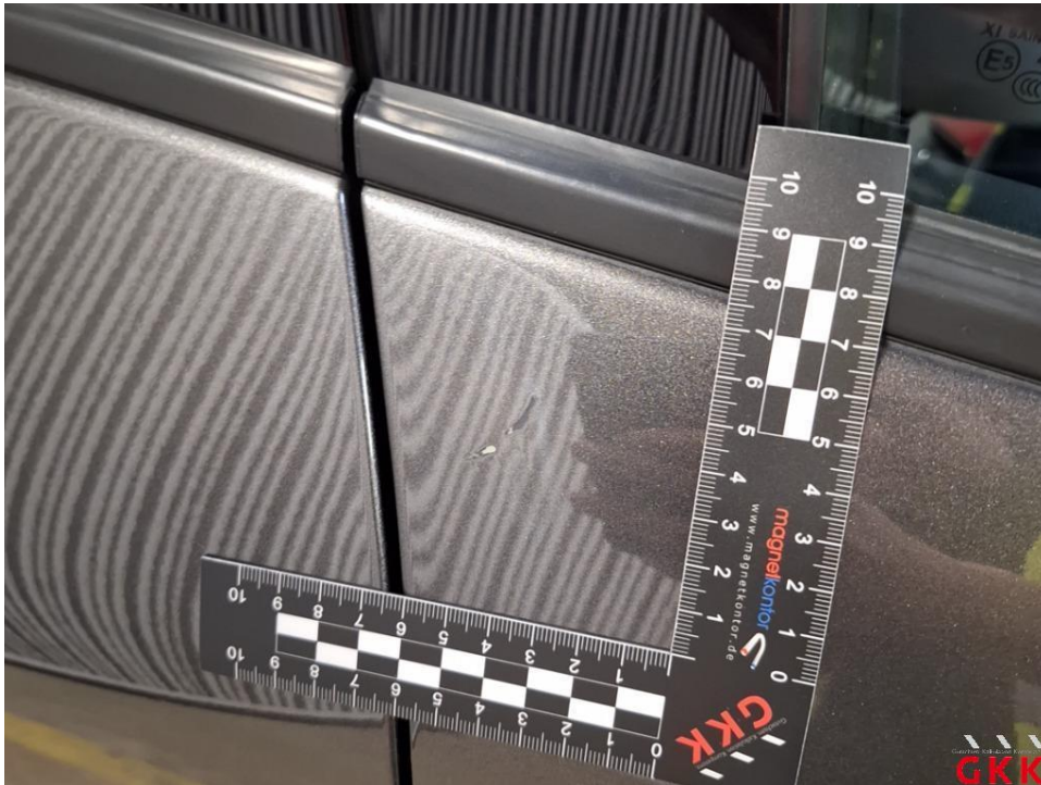
Bild 19 Tür vorne rechts, beschädigt, instand setzen - lackieren
