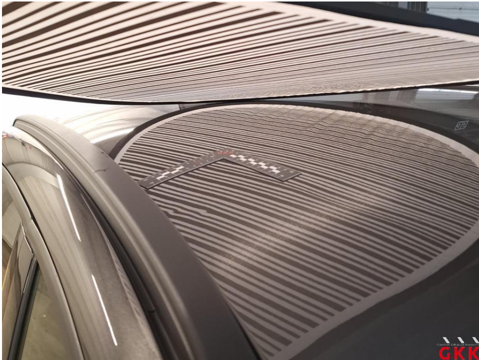
Bild 21 Dach, beschädigt, instand setzen - lackieren
