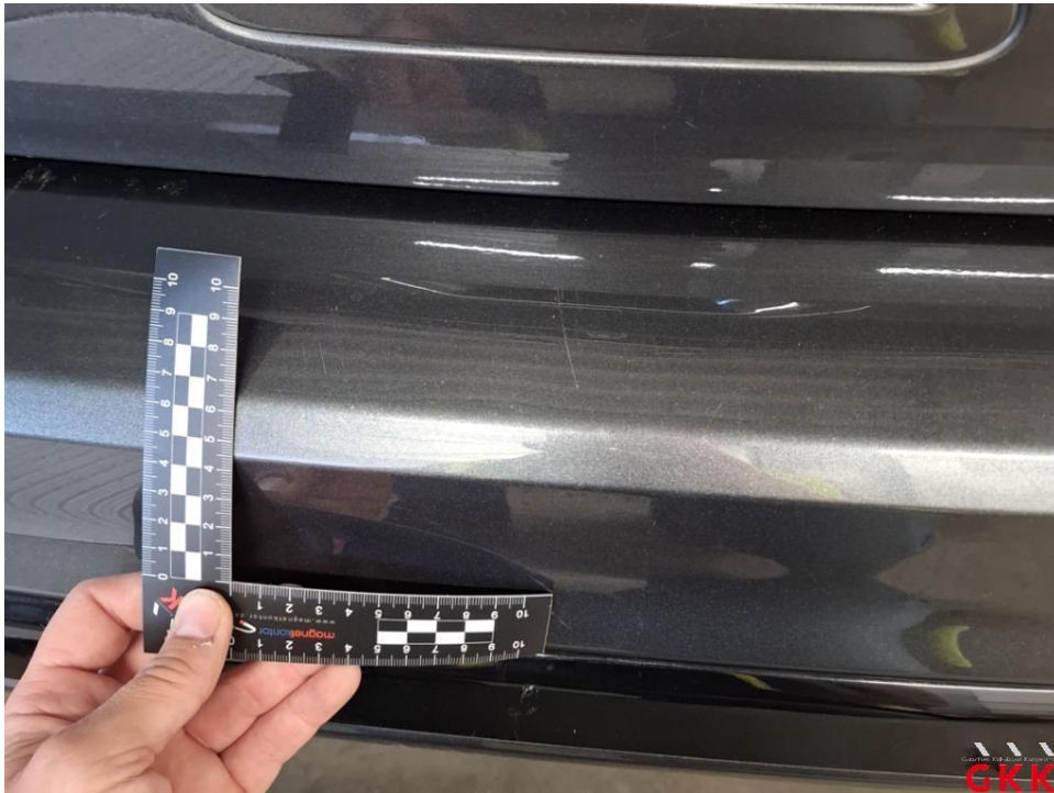
Bild 27 Stoßfänger hinten, Verkleidung -lackiert-, verkratzt, lackieren
