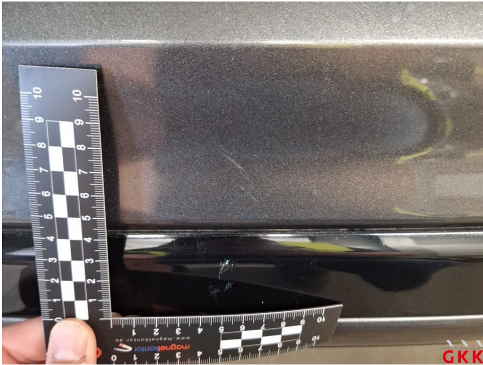
Bild 29 Stoßfänger hinten, Verkleidung -lackiert-, verkratzt, lackieren
