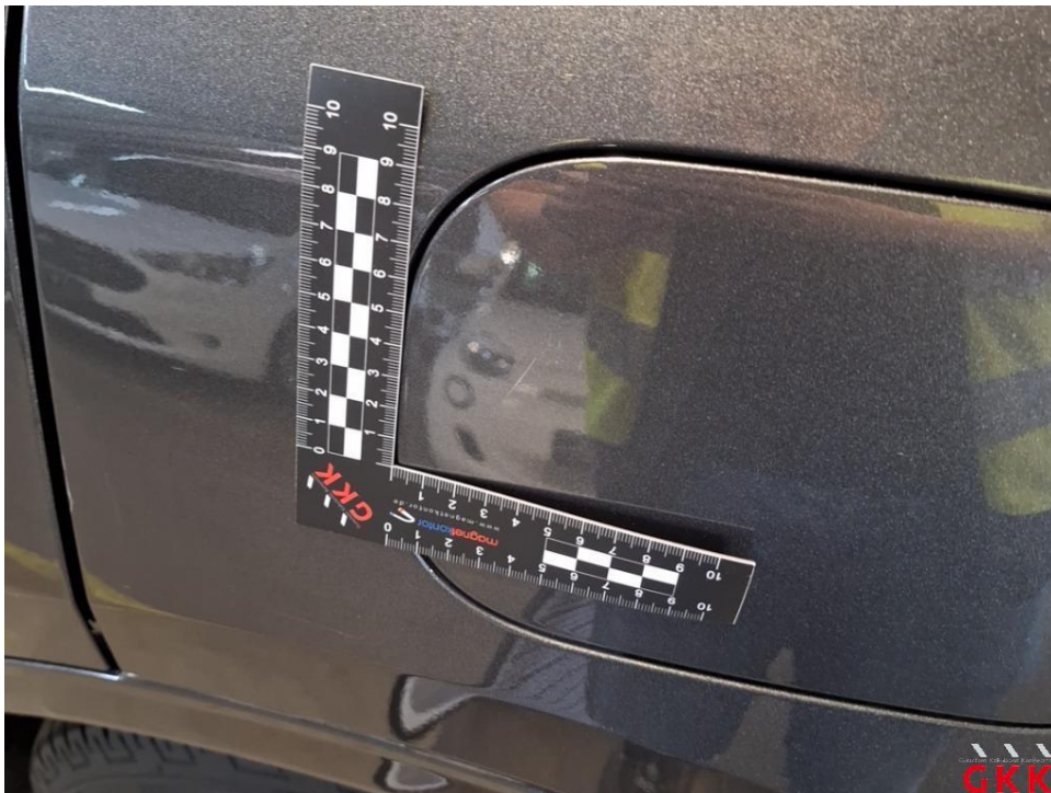
Bild 30 Tankdeckel, verkratzt, lackieren ohne LV
