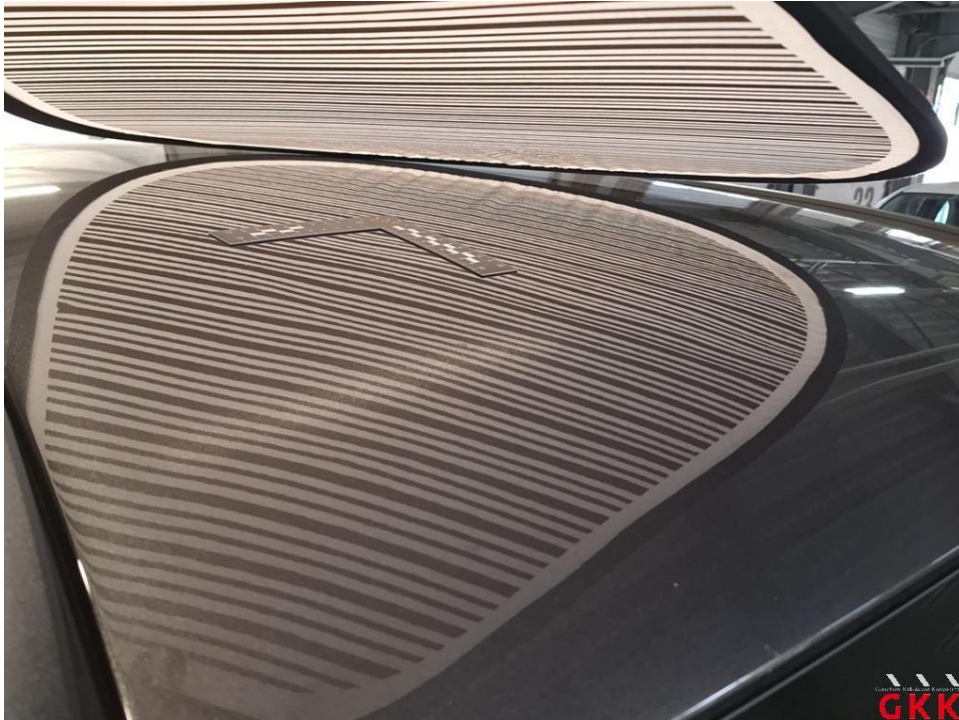
Bild 23 Dach, beschädigt, instand setzen - lackieren
