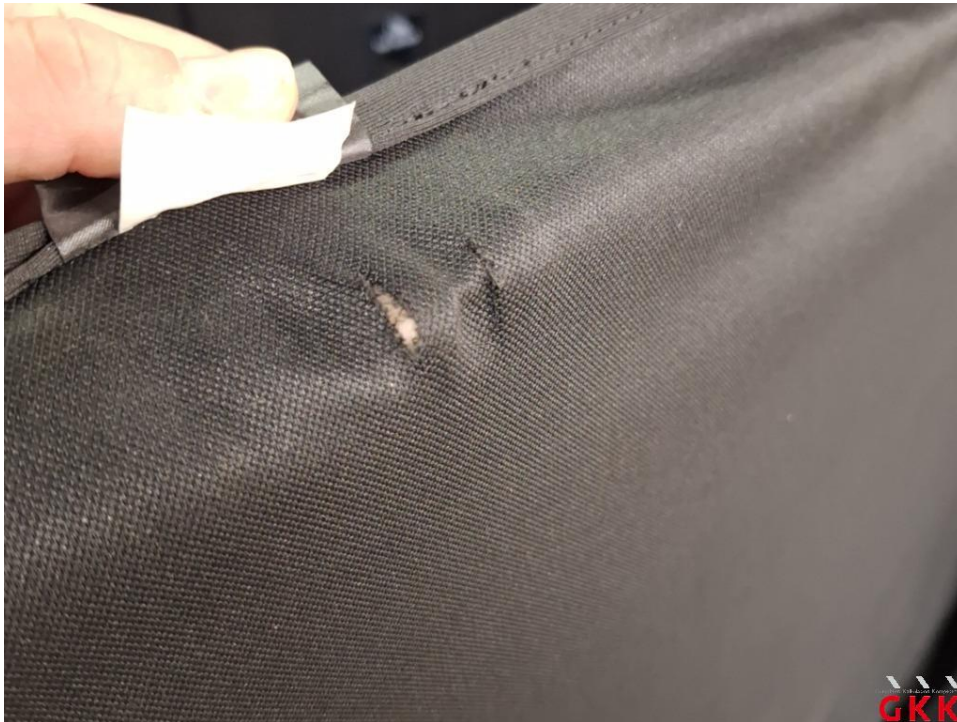
Bild 17 Laderaum, Abdeckung, beschädigt, ersetzen
