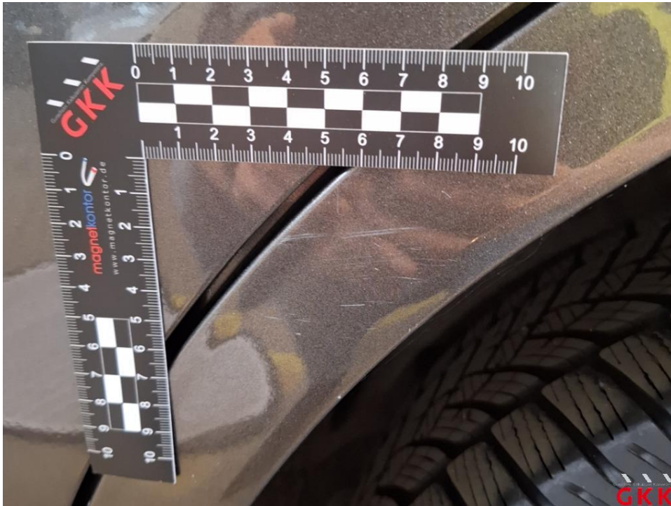
Bild 35 Seitenwand links, Leiste, Radlauf -lackiert-, beschädigt, lackieren
