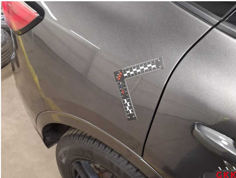
Bild 24 Seitenwand rechts, verkratzt, lackieren
