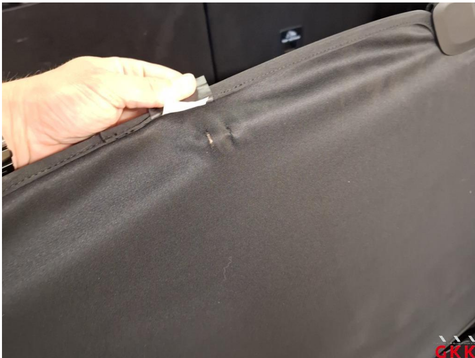
Bild 16 Laderaum, Abdeckung, beschädigt, ersetzen
