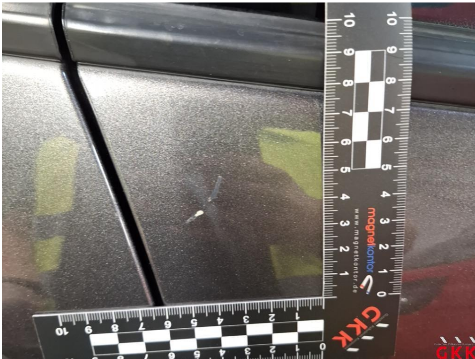
Bild 20 Tür vorne rechts, beschädigt, instand setzen - lackieren
