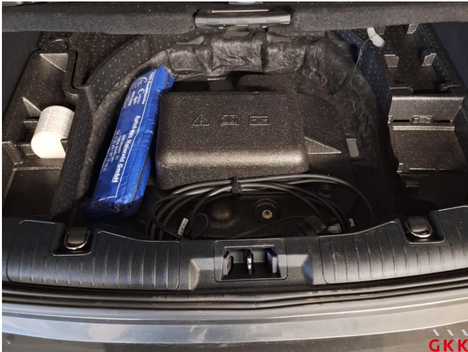
Bild 15 Reifenreparaturset, Füllkompressor, fehlt, ersetzen
