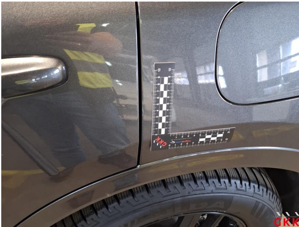
Bild 32 Seitenwand links, verkratzt, auslegen, schleifen, polieren
