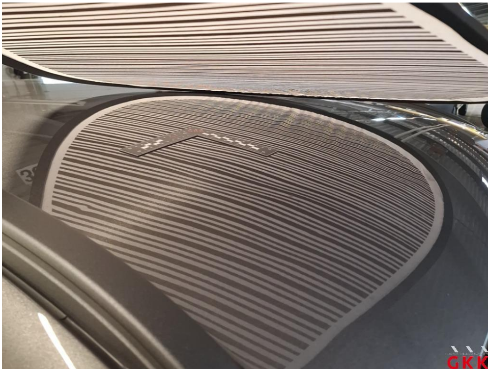
Bild 22 Dach, beschädigt, instand setzen - lackieren
