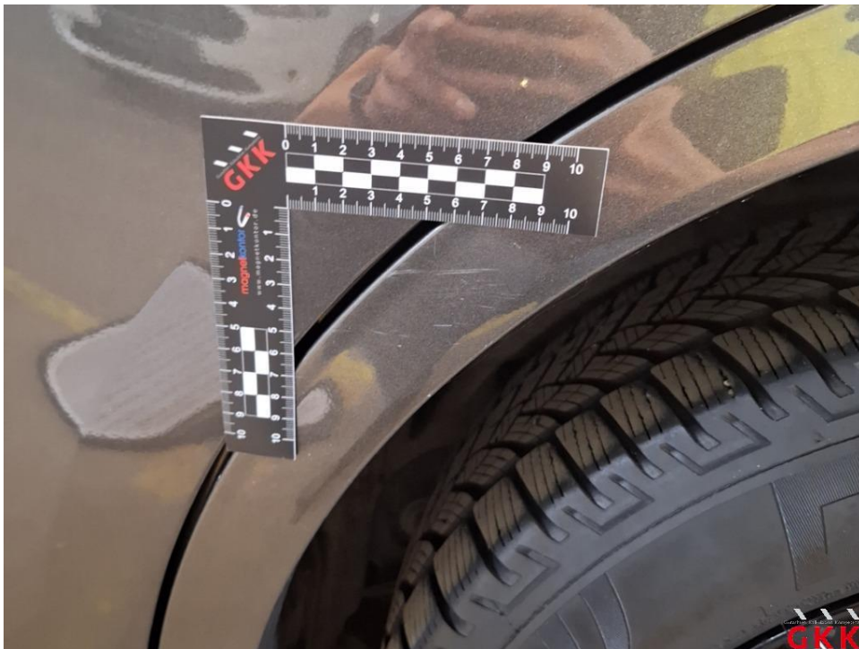
Bild 34 Seitenwand links, Leiste, Radlauf -lackiert-, beschädigt, lackieren
