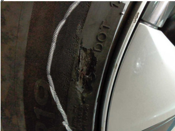
Beschädigung #3: Rad/Reifen: Reifen vorn links - gebrochen / gerissen - erneuern
