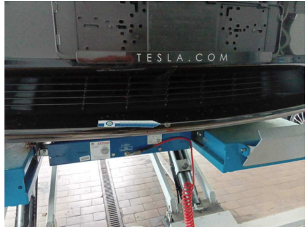
Beschädigung #7: Stossfänger vorn: Stossfänger vorn - beschädigt - instandsetzen und lackieren
