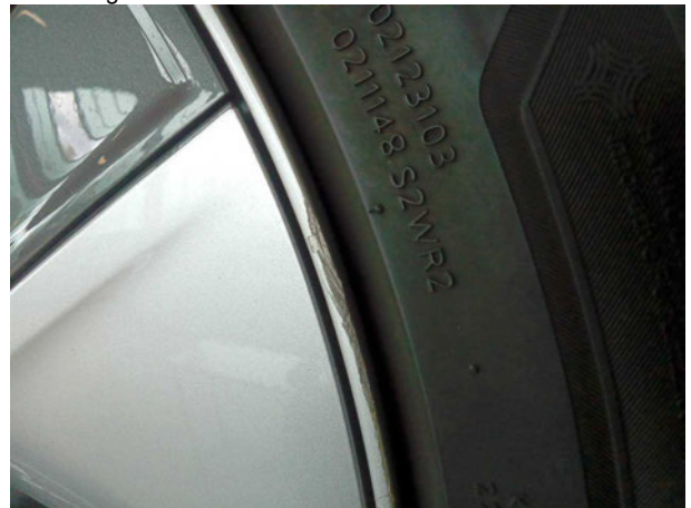
Beschädigung #6: Rad/Reifen: Leichtmetallfelge vorn rechts - beschädigt - erneuern
