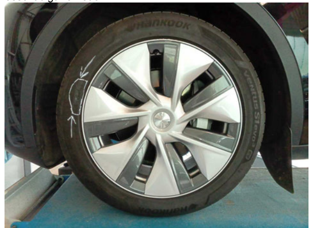
Beschädigung #5: Rad/Reifen: Leichtmetallfelge vorn links - beschädigt - erneuern
