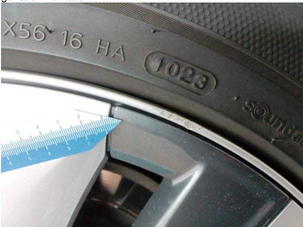
Beschädigung #4: Rad/Reifen: Leichtmetallfelge hinten rechts - beschädigt - erneuern
