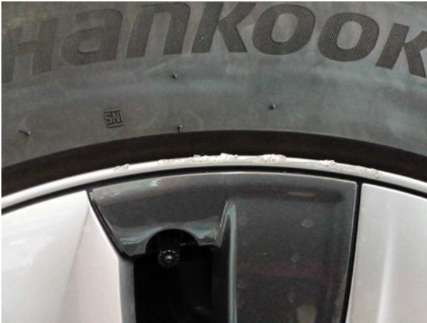
Beschädigung #5: Rad/Reifen: Leichtmetallfelge vorn links - beschädigt - erneuern
