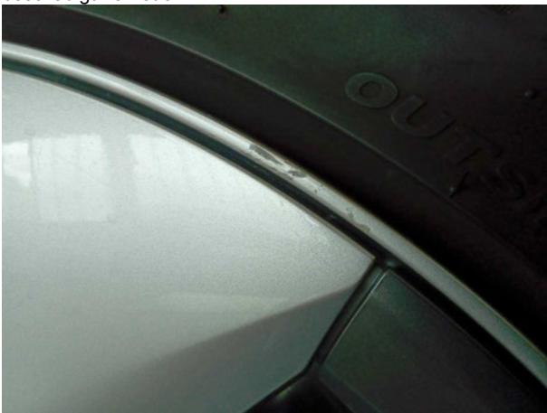
Beschädigung #6: Rad/Reifen: Leichtmetallfelge vorn rechts - beschädigt - erneuern
