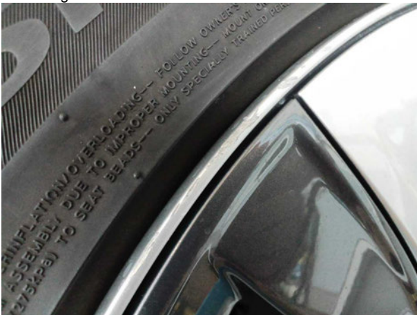
Beschädigung #6: Rad/Reifen: Leichtmetallfelge vorn rechts - beschädigt - erneuern
