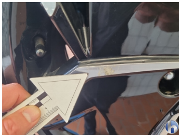
2. Felge Hinten - Rechts Korrodiert - Smart Repair
