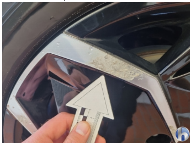
2. Felge Hinten - Rechts Korrodiert - Smart Repair
