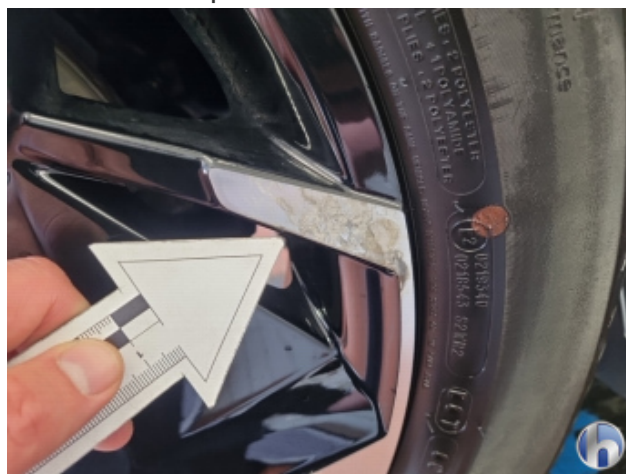
2. Felge Hinten - Rechts Korrodiert - Smart Repair
