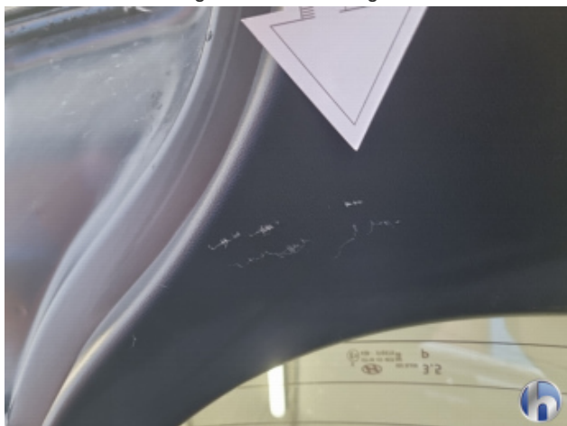
7. Heckdeckelverkleidung Gebrauchsspuren - Ohne Reparatur
