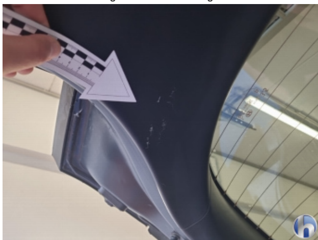
7. Heckdeckelverkleidung Gebrauchsspuren - Ohne Reparatur
