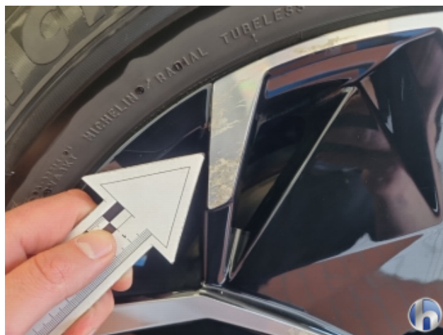
1. Felge Hinten - Links Korrodiert - Smart Repair
