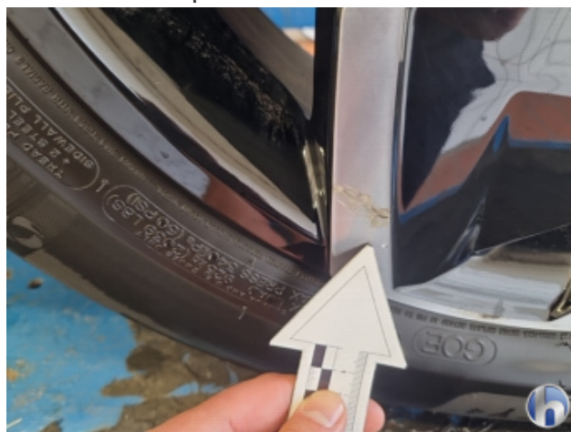
1. Felge Hinten - Links Korrodiert - Smart Repair
