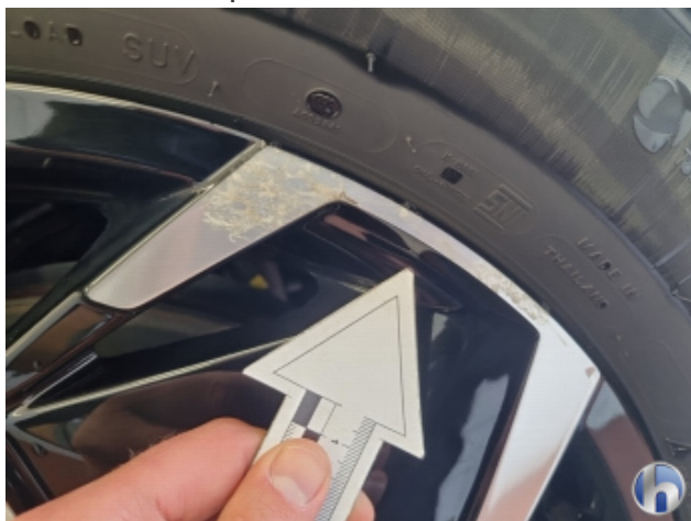
1. Felge Hinten - Links Korrodiert - Smart Repair
