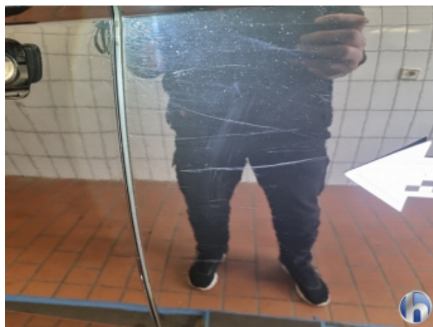
4. Tür Hinten - Links Oberflächenkratzer - Aufbereiten / Polieren
