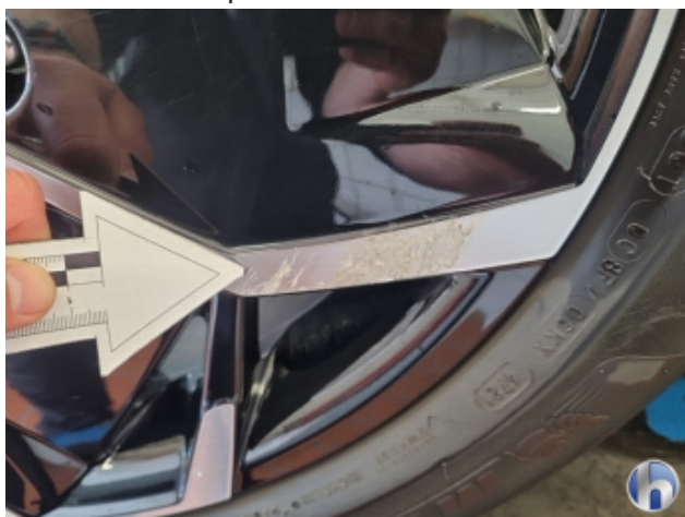
2. Felge Hinten - Rechts Korrodiert - Smart Repair
