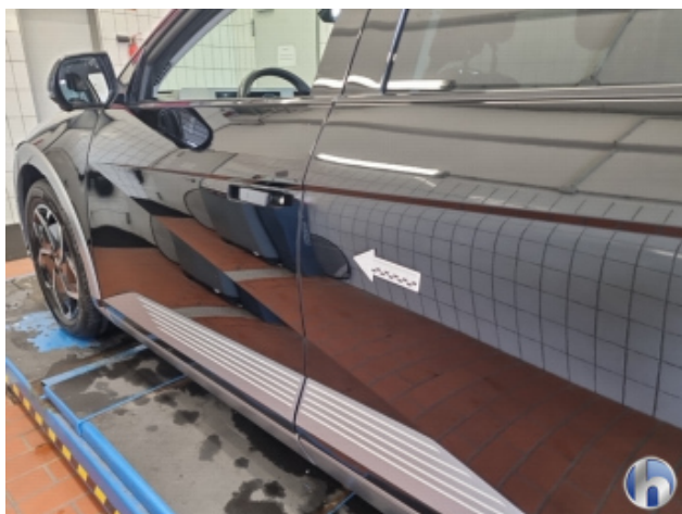
4. Tür Hinten - Links Oberflächenkratzer - Aufbereiten / Polieren
