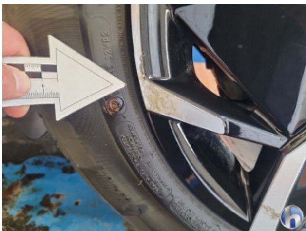
1. Felge Hinten - Links Korrodiert - Smart Repair
