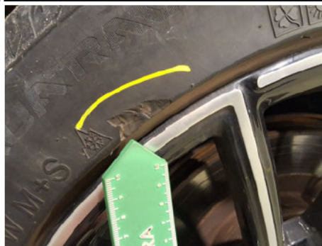
Pneu / Arrière Gauche / Déchiré
