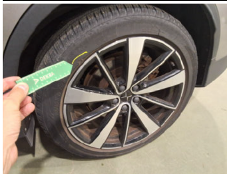
Pneu / Arrière Gauche / Déchiré
