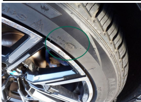
Pneu / Arrière Droit / Déchiré
