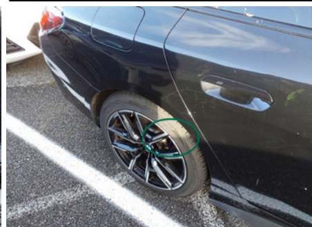
Pneu / Arrière Droit / Déchiré
