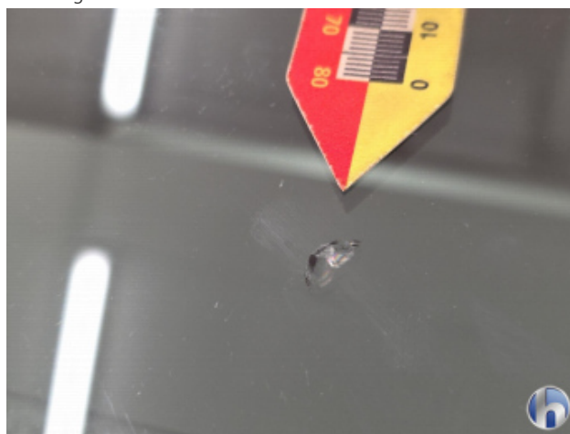
1. Steinschlagreparatur Nicht In Ordnung - Erneuern
