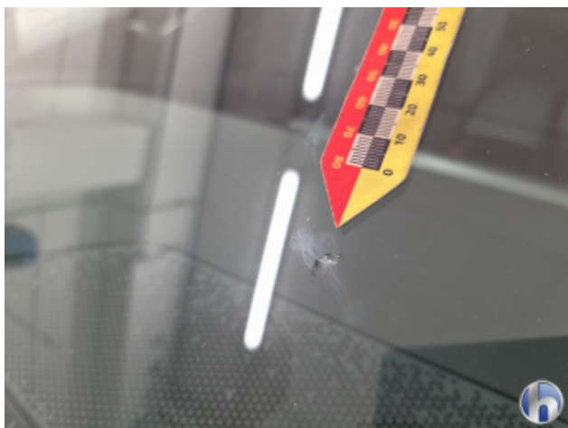
1. Steinschlagreparatur Nicht In Ordnung - Erneuern
