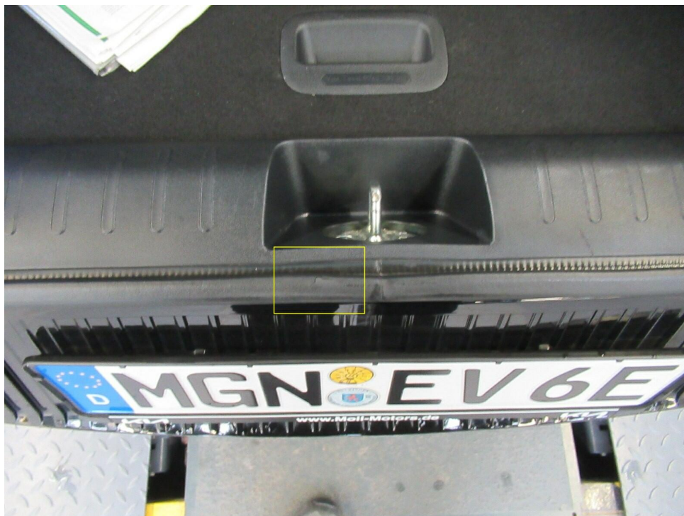
Bild 11 : Dichtung der Heckklappe gebrochen
