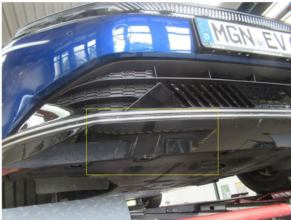
Bild 13 : Stoßfänger vorne Lackierung, verschrammt, smart repair
