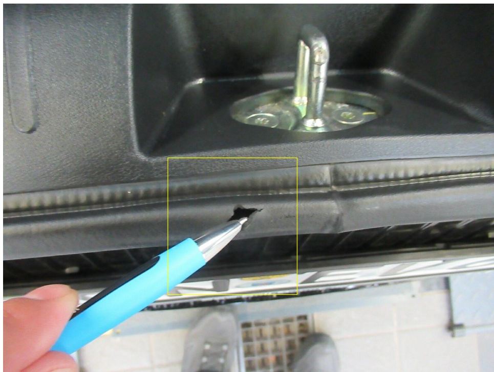
Bild 12 : Dichtung der Heckklappe gebrochen
