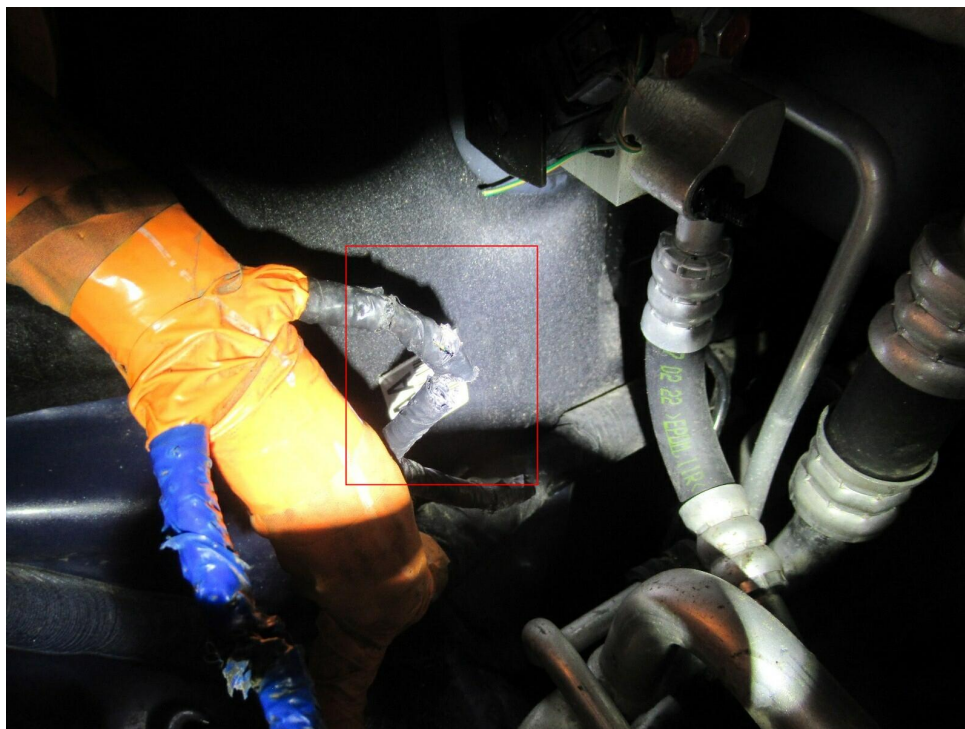
Bild 9 : Motorraum (Kabel) mit Tierverbiss, prüfen, Schadenerweiterung möglich
