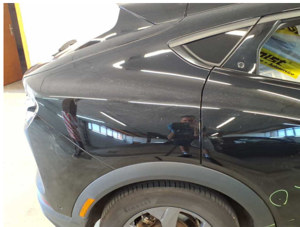
Beschädigung #4: Seitenwand rechts: Seitenwand - Delle(n) - sanft instandsetzen
