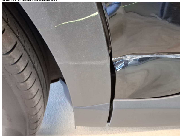
Beschädigung #5: Seitenwand rechts: Radhausverbreiterun... verkratzt / verschürft - erneuern
