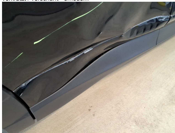
Beschädigung #6: Tür hinten rechts: Zierleiste unten - verkratzt / verschürft - erneuern
