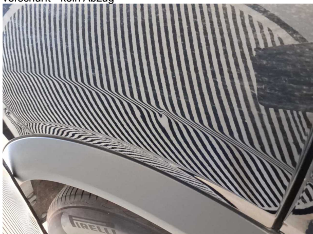
Beschädigung #4: Seitenwand rechts: Seitenwand - Delle(n) - sanft instandsetzen
