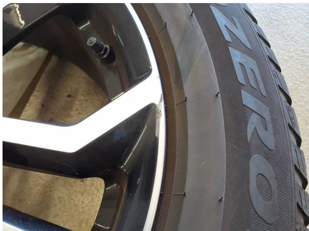
Beschädigung #2: 2.Radsatz: 1 Leichtmetallfelge - verkratzt / verschürft - kein Abzug
