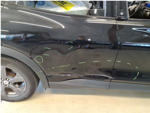
Beschädigung #9: Tür hinten rechts: Tür - Delle / Lackschaden - erneuern
