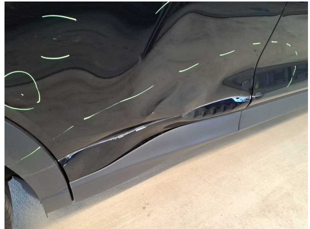
Beschädigung #9: Tür hinten rechts: Tür - Delle / Lackschad... - erneuern
