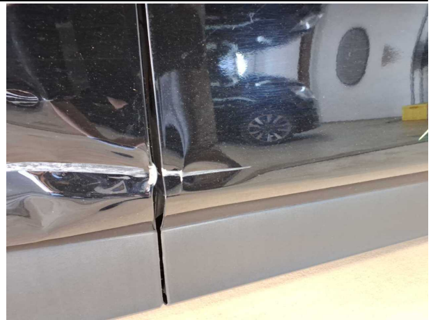
Beschädigung #8: Tür vorn rechts: Tür - Delle / Lackschade... - erneuern
