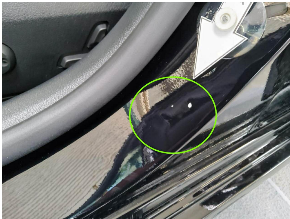
Bild 20 : Tür vorne links Einstieg Lackierung, verschrammt, smart repair
