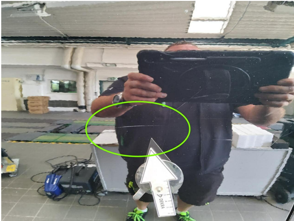
Bild 23 : Tür hinten rechts Lackierung, verschrammt, Gebrauchsspur
