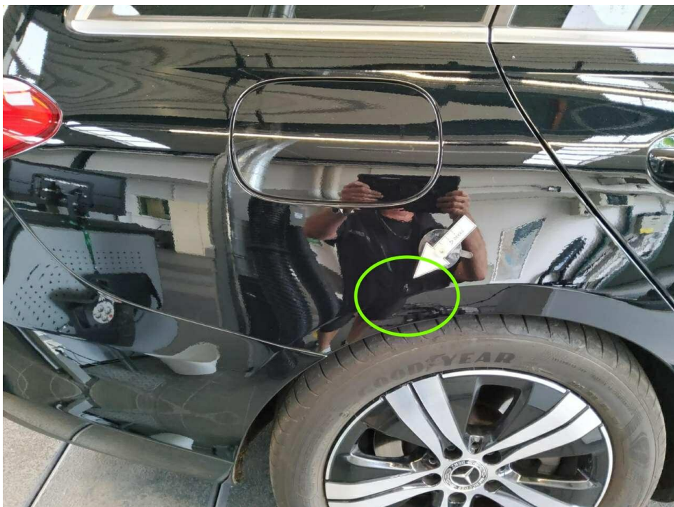
Bild 26 : Seitenteil hinten rechts Lackierung, verschrammt, Gebrauchsspur
