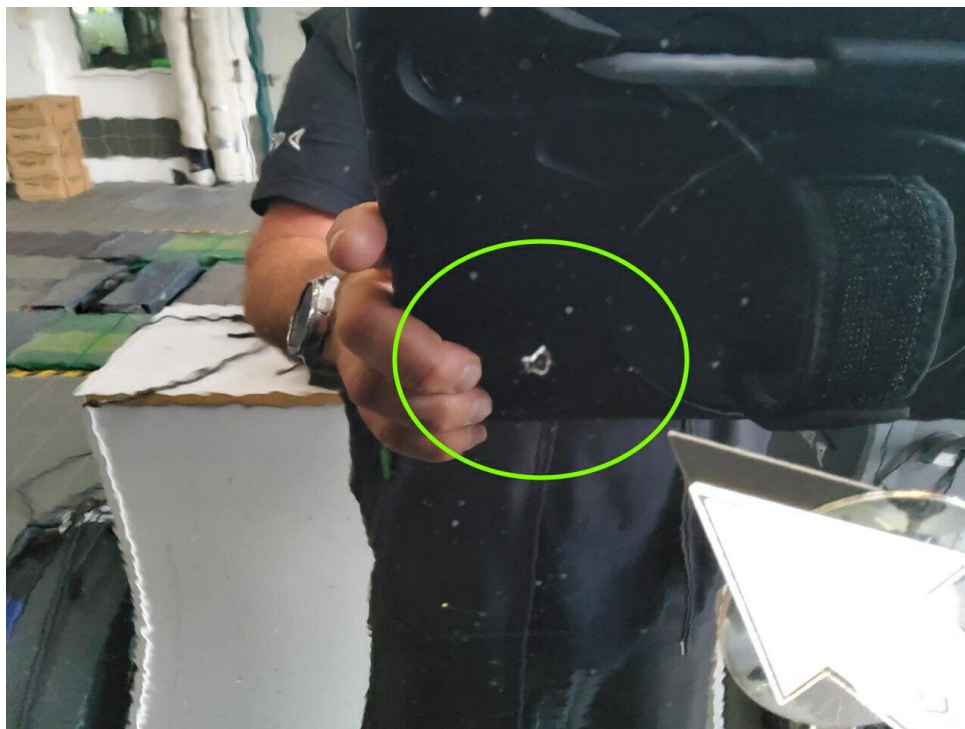
Bild 31 : Tür vorne rechts, eingedellt, instandsetzen und lackieren mit Lackaufbau
