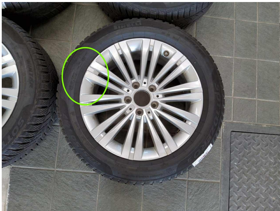
Bild 14 : Felge vorne links Lackierung, verschrammt, lackieren mit Lackaufbau
