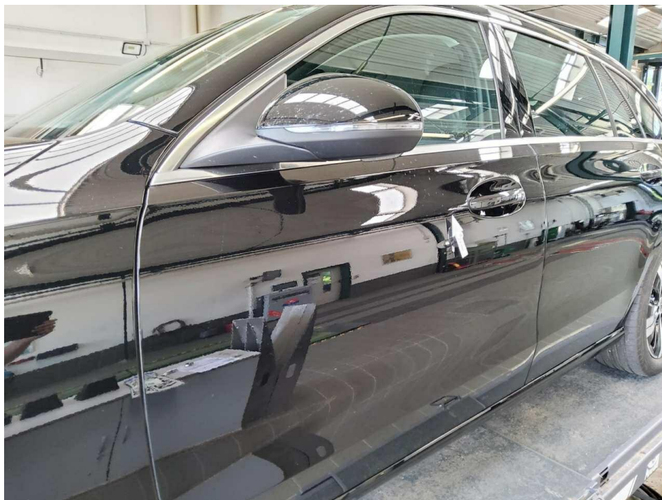
Bild 19 : Tür vorne links, eingedellt, Gebrauchsspur
