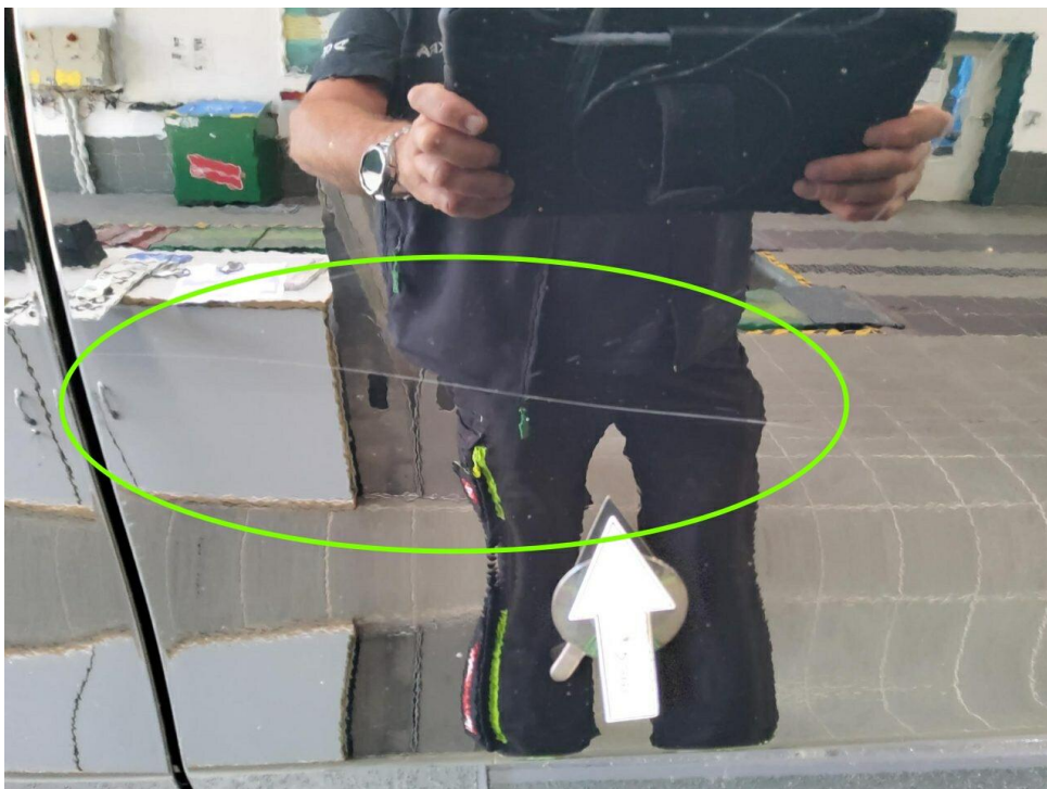
Bild 16 : Tür hinten links Lackierung, verschrammt, Gebrauchsspur
