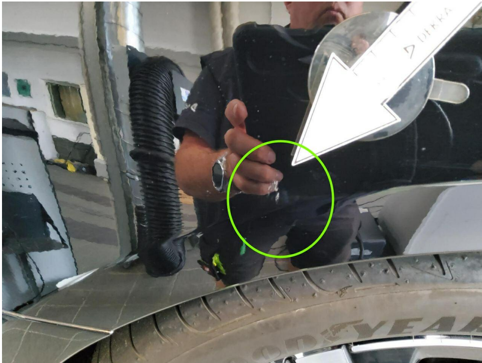
Bild 25 : Seitenteil hinten rechts Lackierung, verschrammt, Gebrauchsspur
