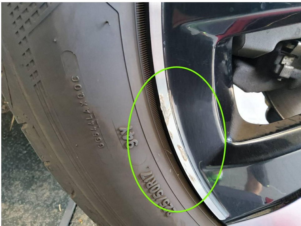
Bild 38 : Glanzgedrehte Alufelge vorn rechts aus Sommerradsatz, verschrammt
