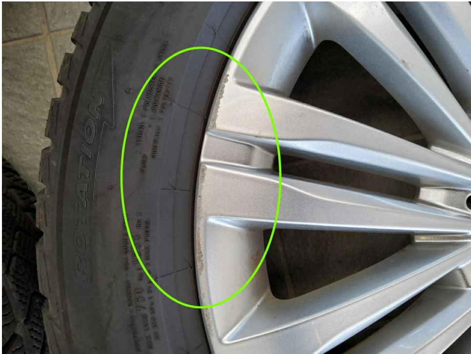
Bild 15 : Felge vorne links Lackierung, verschrammt, lackieren mit Lackaufbau
