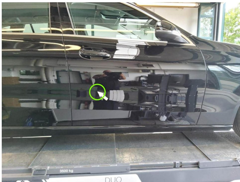
Bild 33 : Tür vorne rechts, eingedellt, instandsetzen und lackieren mit Lackaufbau
