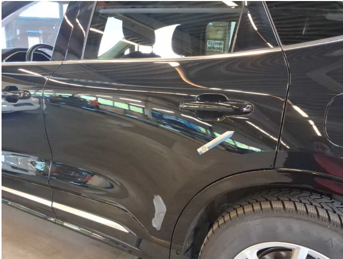
Damage 3: Door - rear left side: Door (Auspolieren) - Scratch(es) - Smart repair
