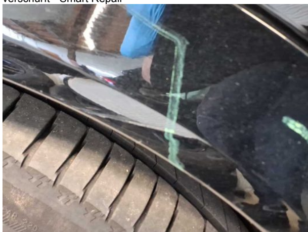
Beschädigung #9: Seitenwand rechts: Radhausverbreiterung - verkratzt / verschürft - Smart Repair
