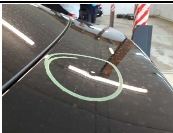
Beschädigung #15: Heckklappe/-tür: Heckklappe - Delle / Lackschaden - instandsetzen und lackieren
