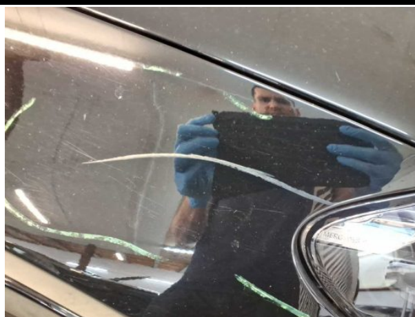
Beschädigung #4: Kotflügel rechts: Kotflügel rechts - Abrieb - auslegen / polieren
