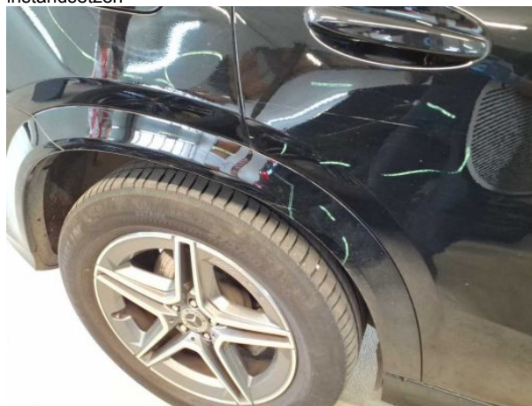
Beschädigung #9: Seitenwand rechts: Radhausverbreiterung - verkratzt / verschürft - Smart Repair
