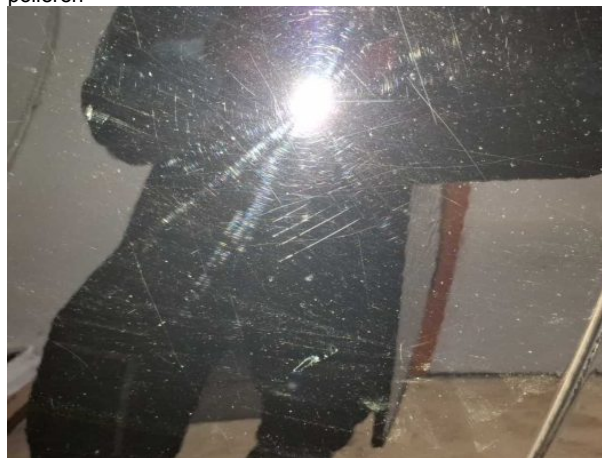
Beschädigung #3: Kotflügel links: Kotflügel links - Kratzer - auslegen / polieren
