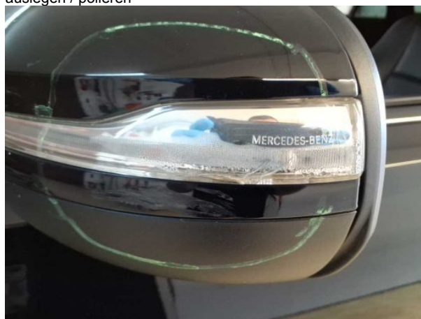
Beschädigung #6: Blinkleuchte: Spiegel links - beschädigt - erneuern
