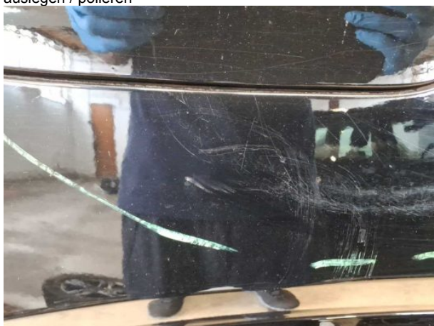
Beschädigung #5: Seitenwand rechts: Seitenwand - Kratzer - auslegen / polieren
