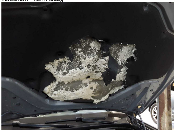
Beschädigung #2: Motorhaube: Dämmmatte - Marderschaden - erneuern
