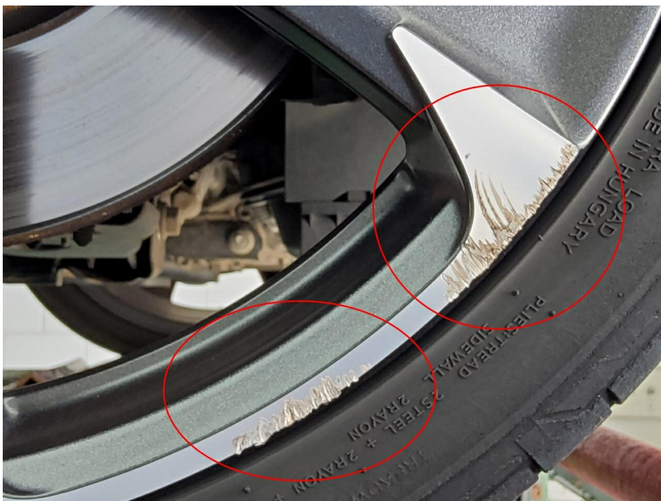
Bild 14 : LM-Felge (glanzgedreht) vorne rechts, beschädigt
