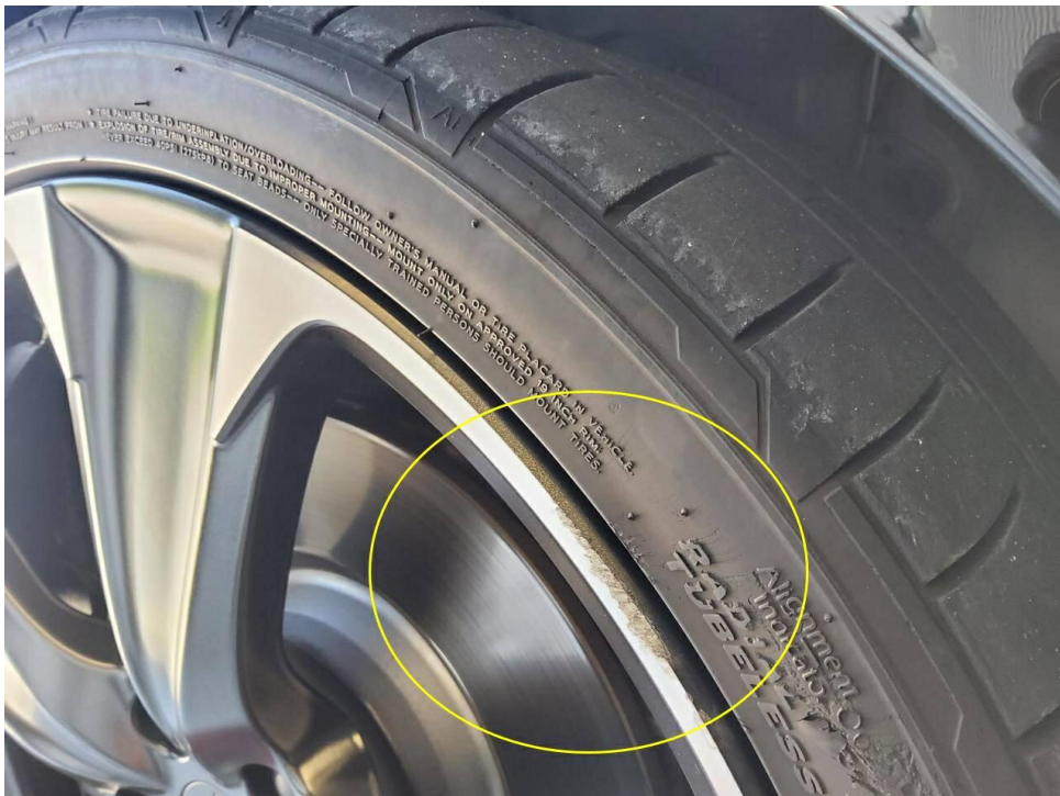
Bild 16 : Glanzgedrehte Alufelge verschrammt VL
