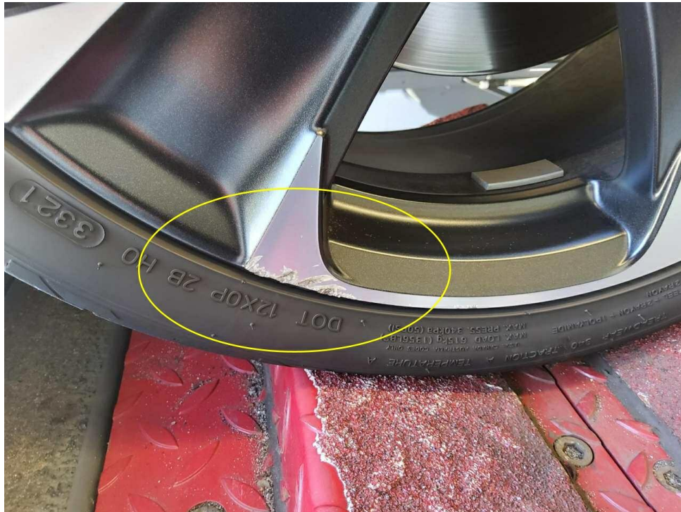
Bild 17 : Glanzgedrehte Alufelge verschrammt VL
