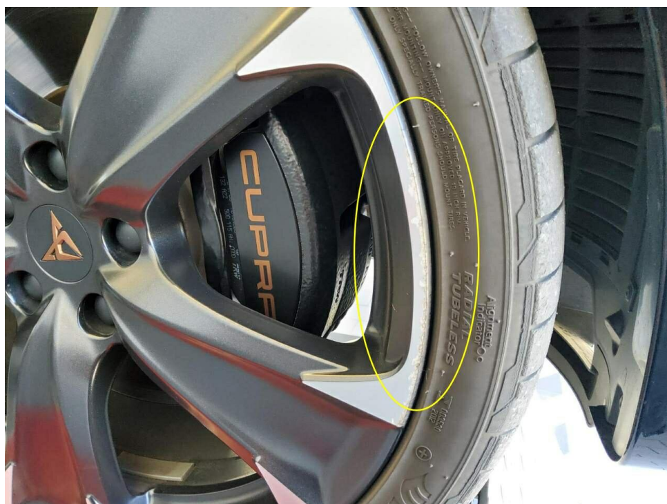
Bild 14 : Glanzgedrehte Alufelge verschrammt VR
