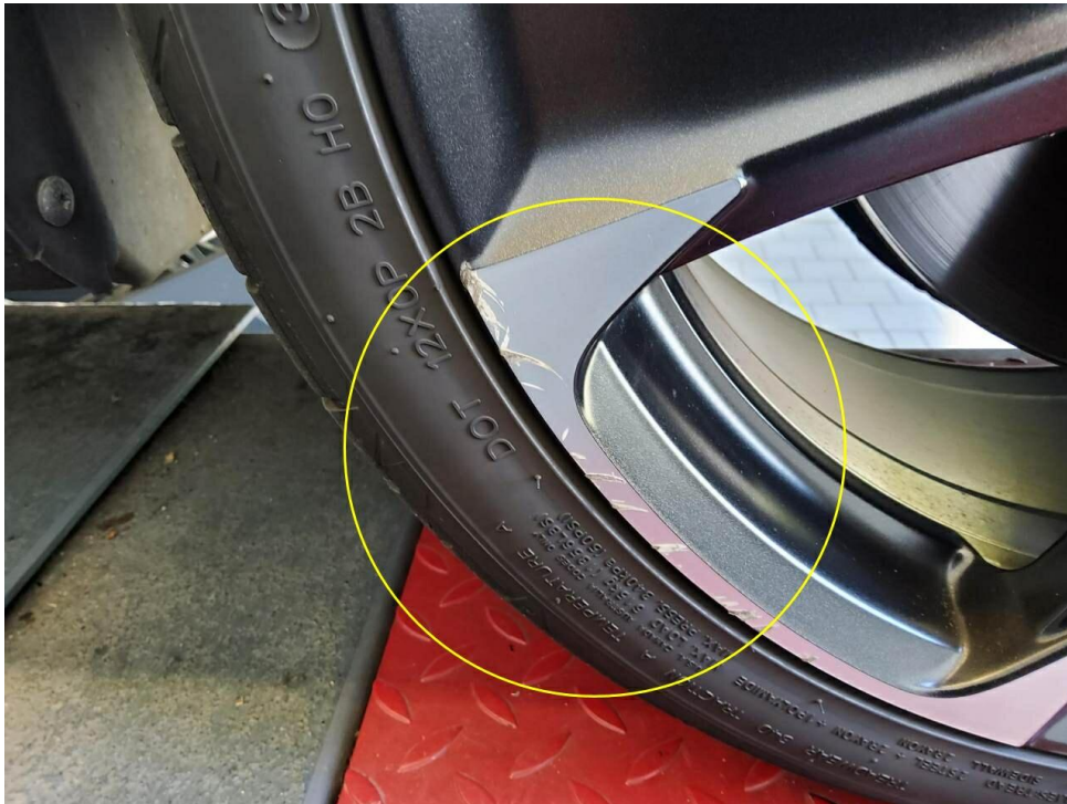
Bild 15 : Glanzgedrehte Alufelge verschrammt VR
