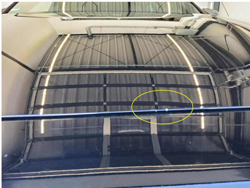
Bild 18 : Motorhaube Lackierung, Steinschlag, Gebrauchsspur
