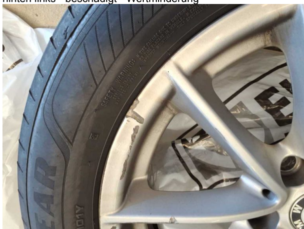
Beschädigung #5: 2.Radsatz: 1 Leichtmetallfelge - verkratzt / verschürft - Wertminderung
