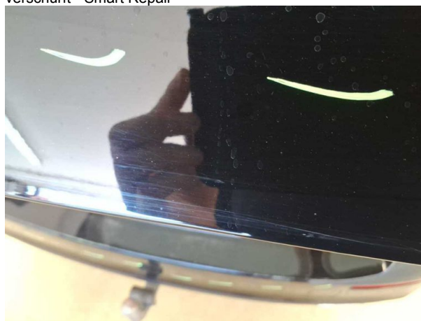
Beschädigung #8: Heckklappe/-tür: Heckklappe - verkratzt / verschürft - Smart Repair
