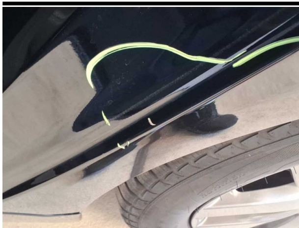
Beschädigung #6: Seitenwand links: Einstieg - verkratzt / verschürft - Smart Repair
