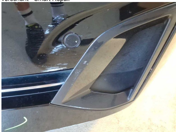
Beschädigung #7: Stossfänger vorn: Lufteinlassgitter - beschädigt - erneuern
