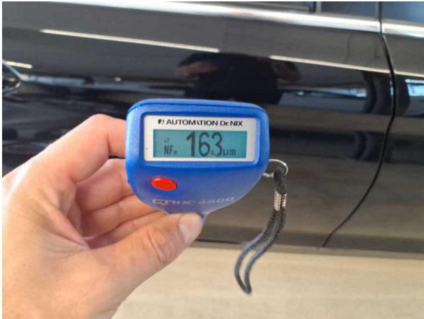
Nachlackierung 1: Schweller rechts, Tür hinten rechts
