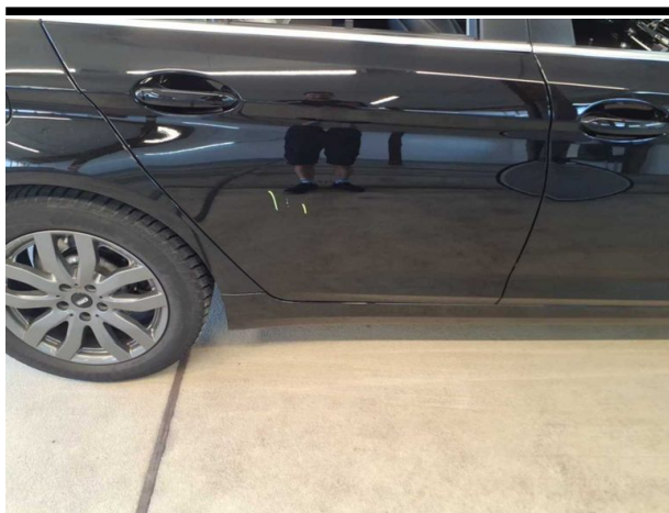
Beschädigung #10: Tür hinten rechts: Tür - Kratzer - instandsetz... und lackieren
