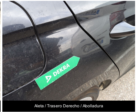
Ala / Trasero Derecho / Abolladura
