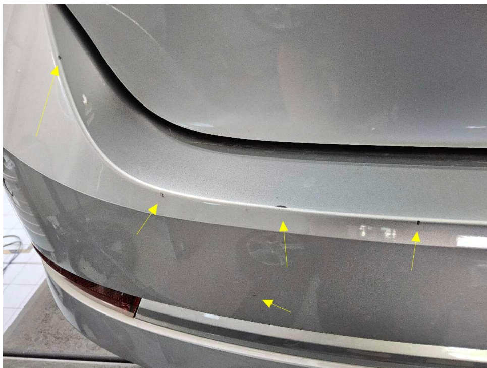
Bild 39 : Stoßfängerverkleidung hinten mehrfach verkratzt
