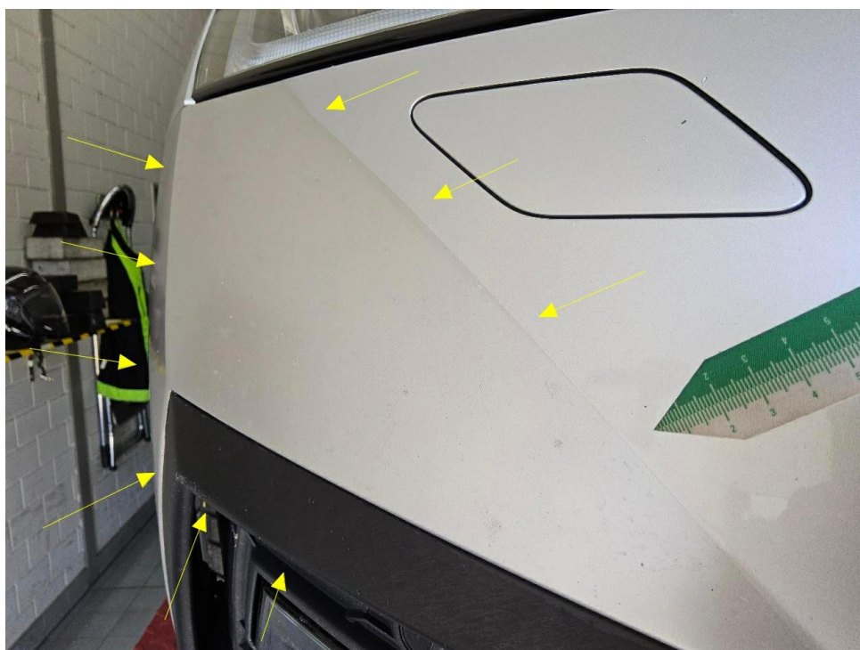
Bild 32 : Stoßfängerverkleidung vorne Restinstandsetzungsspuren
