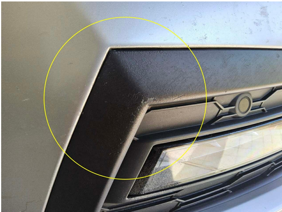
Bild 34 : Stoßfängerverkleidung vorne Restinstandsetzungsspuren
