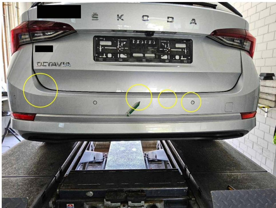
Bild 35 : Stoßfängerverkleidung hinten mehrfach verkratzt
