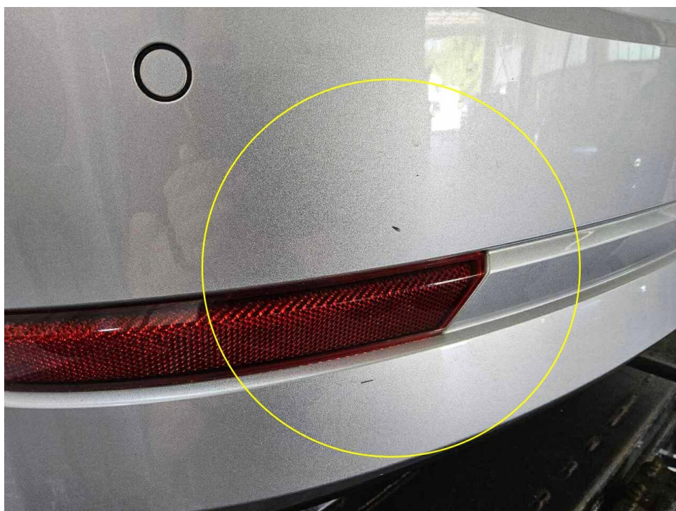
Bild 40 : Stoßfängerverkleidung hinten mehrfach verkratzt
