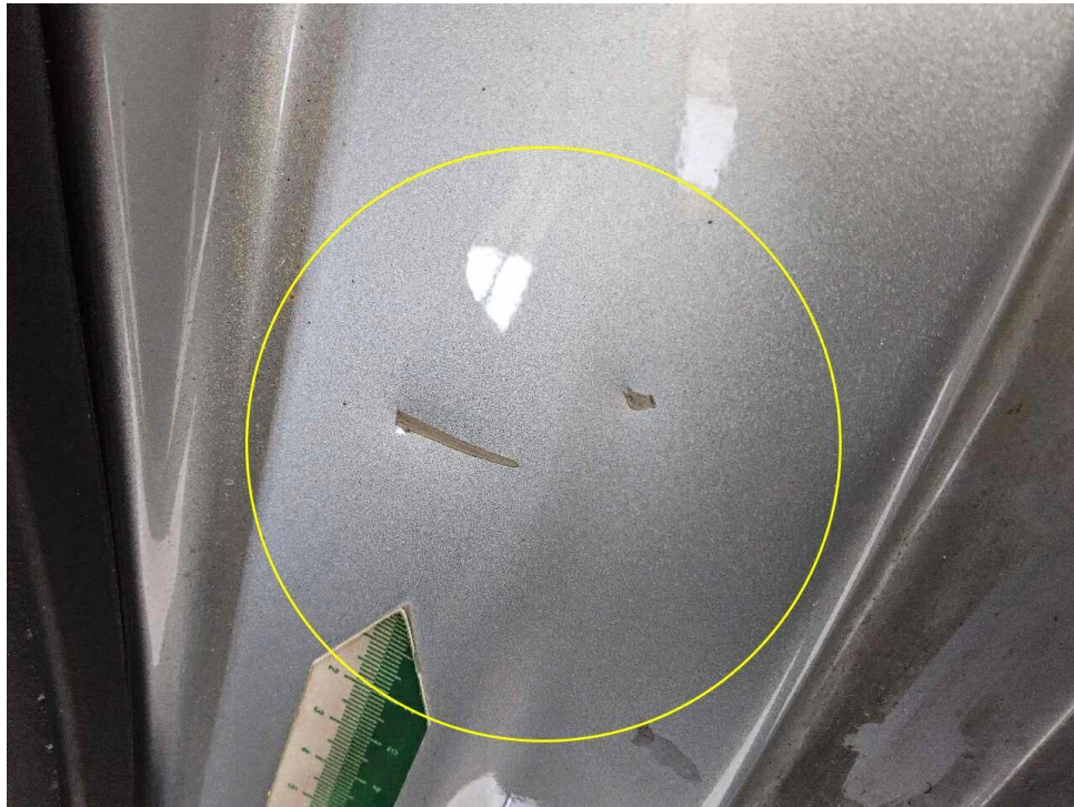
Bild 21 : Einstiegschweller hinten links verkratzt und verdellt
