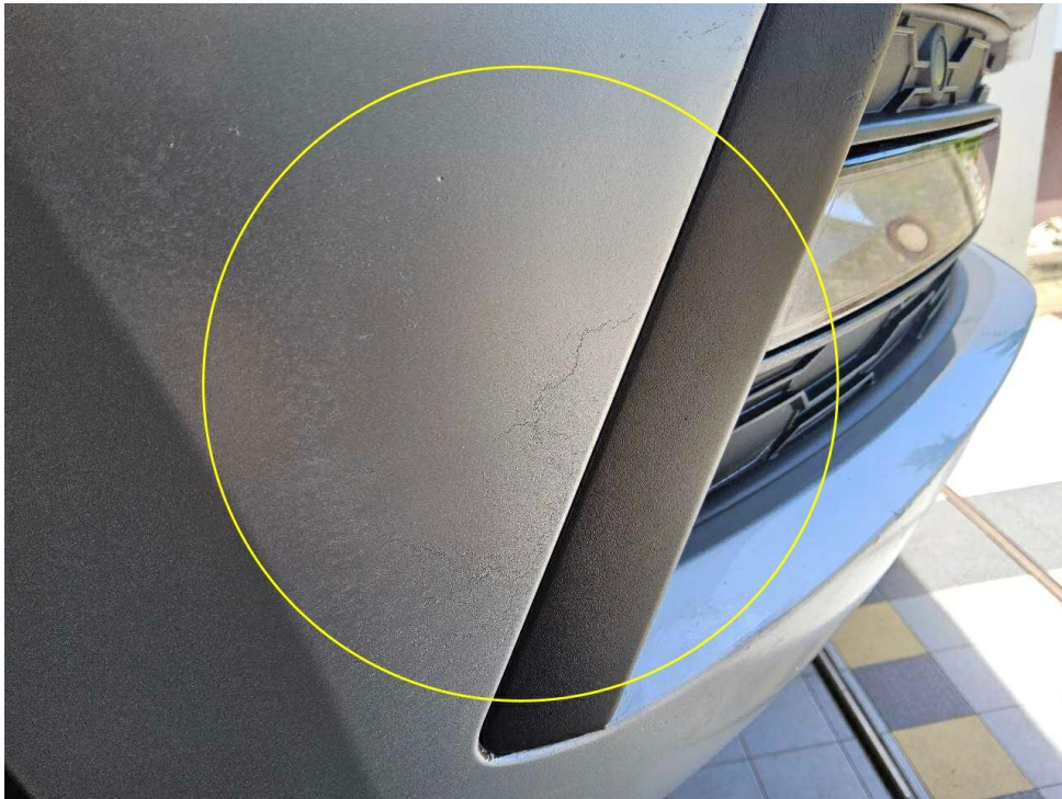
Bild 33 : Stoßfängerverkleidung vorne Restinstandsetzungsspuren
