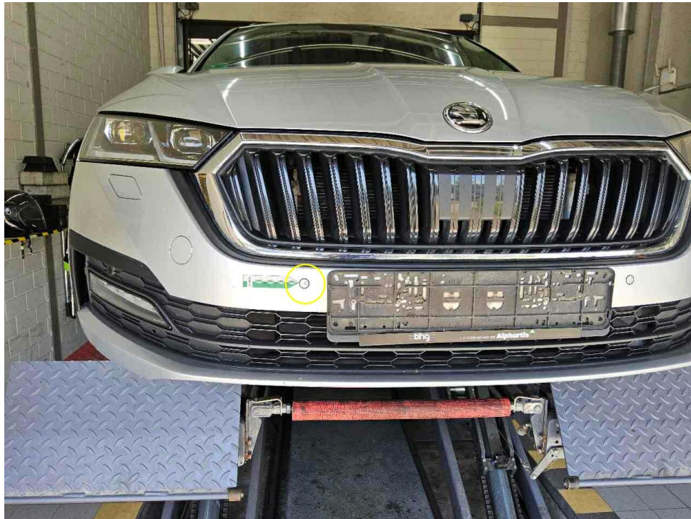
Bild 29 : Parksensor vorne mit Blasenbildung
