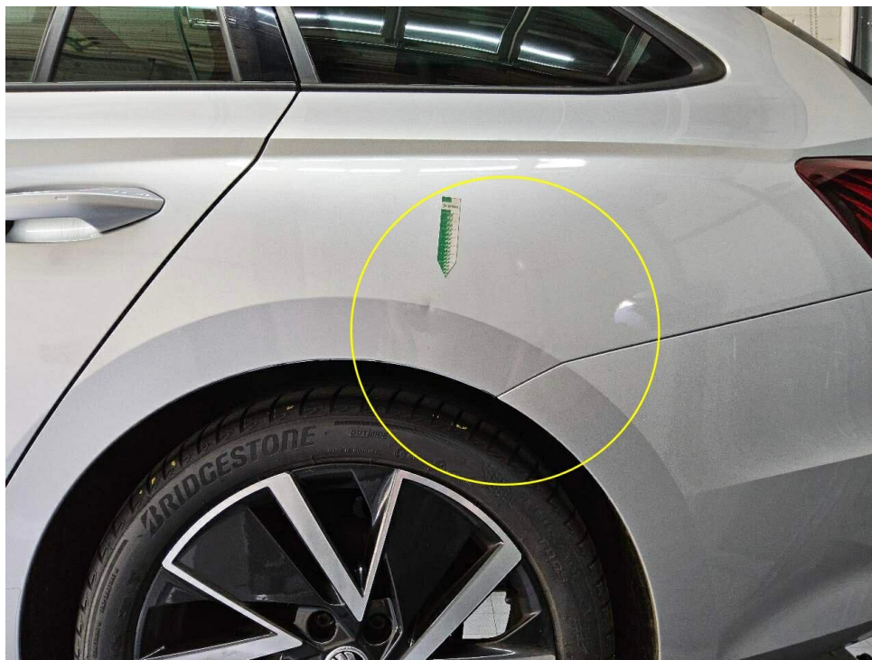
Bild 26 : Seitenwand links verkratzt und eingedellt
