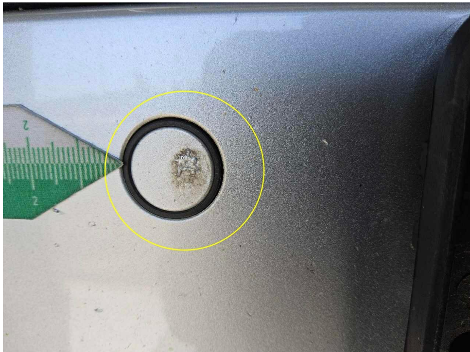
Bild 30 : Parksensor vorne mit Blasenbildung
