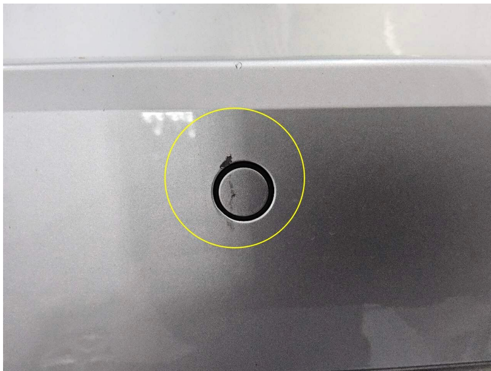
Bild 37 : Stoßfängerverkleidung hinten mehrfach verkratzt
