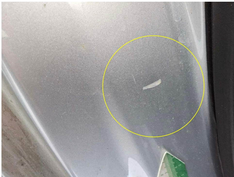
Bild 24 : Einstiegschweller hinten rechts verkratzt und verdellt
