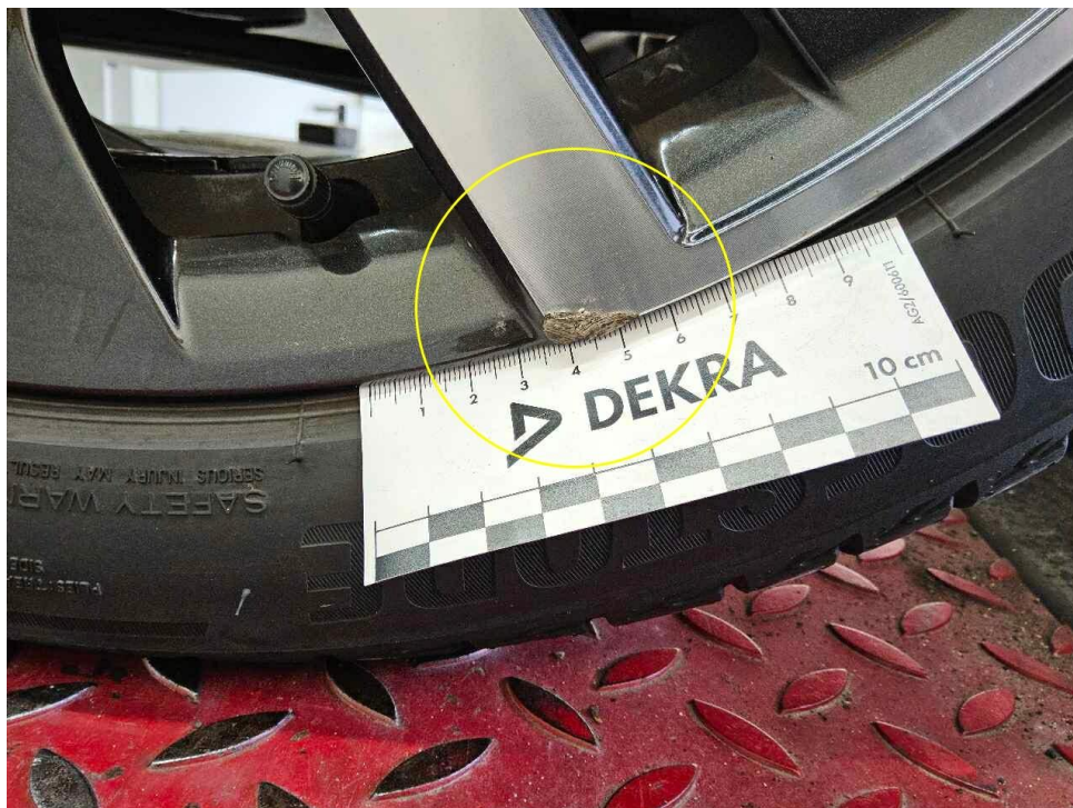
Bild 42 : Leichtmetall Felge vorne rechts verschrammt
