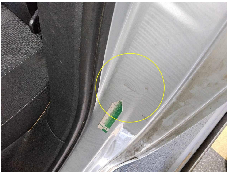
Bild 22 : Einstiegschweller hinten links verkratzt und verdellt
