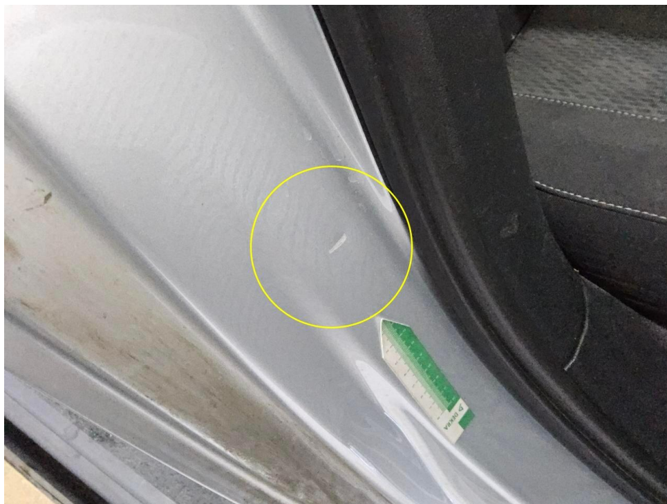
Bild 25 : Einstiegschweller hinten rechts verkratzt und verdellt
