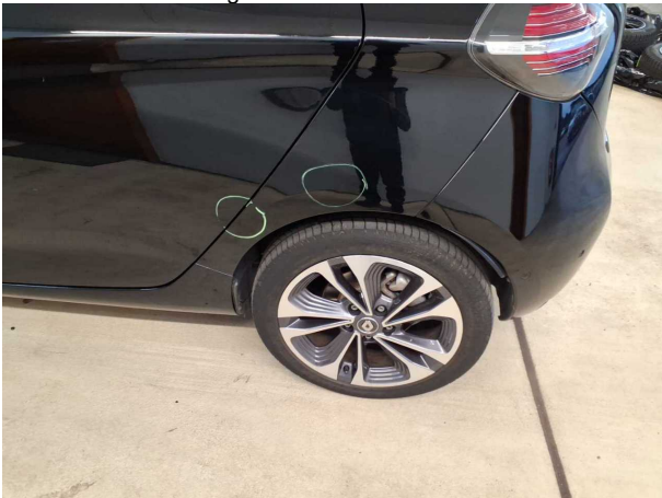
Beschädigung #4: Seitenwand links: Seitenwand - Delle(n) - sanft instandsetzen
