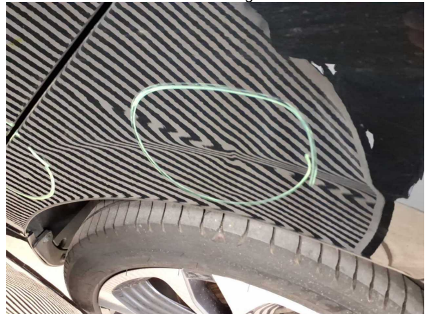
Beschädigung #4: Seitenwand links: Seitenwand - Delle(n) - sanft instandsetzen
