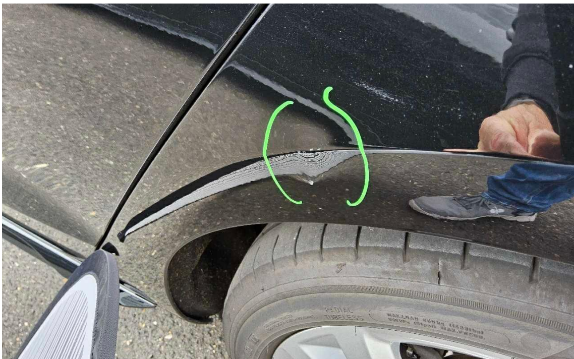
Bild 24 : Seitenteil hinten links, mehrfach eingedellt, instandsetzen und lackieren mit Lackaufbau
