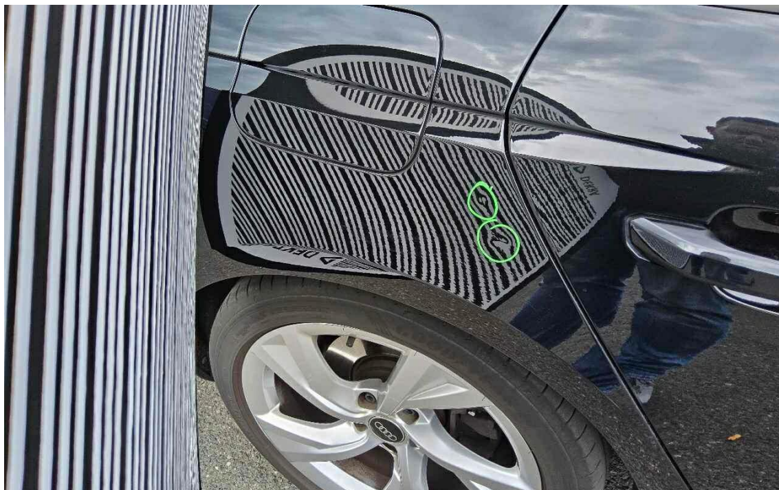
Bild 33 : Seitenteil hinten rechts, mehrfach eingedellt, drücken
