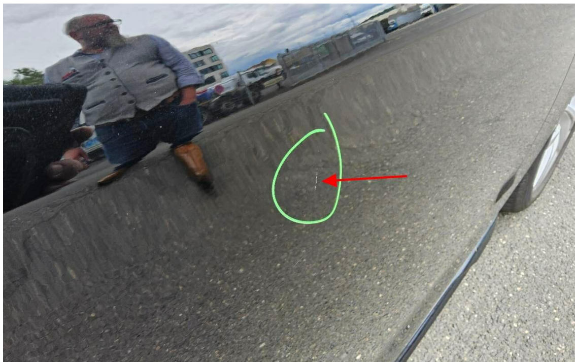
Bild 35 : Tür vorne rechts Lackierung, zerkratzt, Gebrauchsspur
