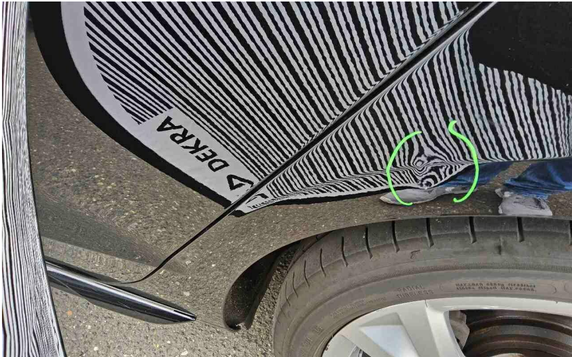
Bild 25 : Seitenteil hinten links, mehrfach eingeclippt, instandsetzen und lackieren mit Lackaufbau
