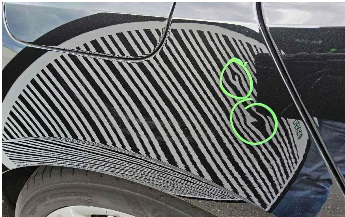
Bild 31 : Seitenteil hinten rechts, mehrfach eingedellt, drücken
