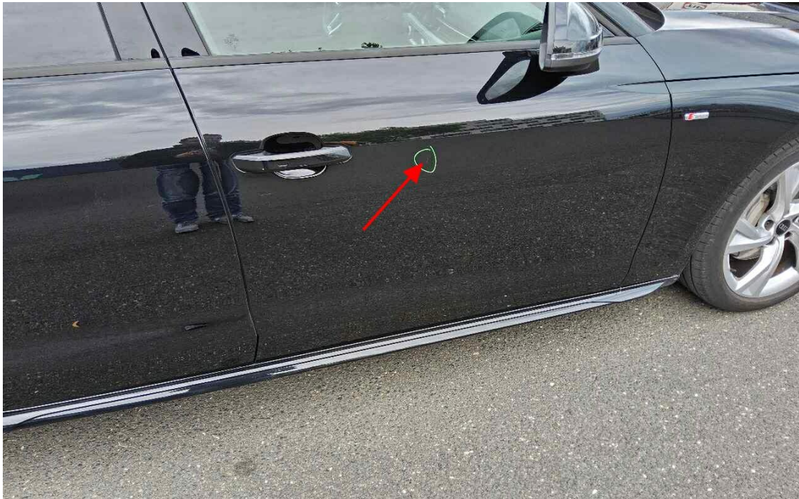
Bild 37 : Tür vorne rechts Lackierung, zerkratzt, Gebrauchsspur
