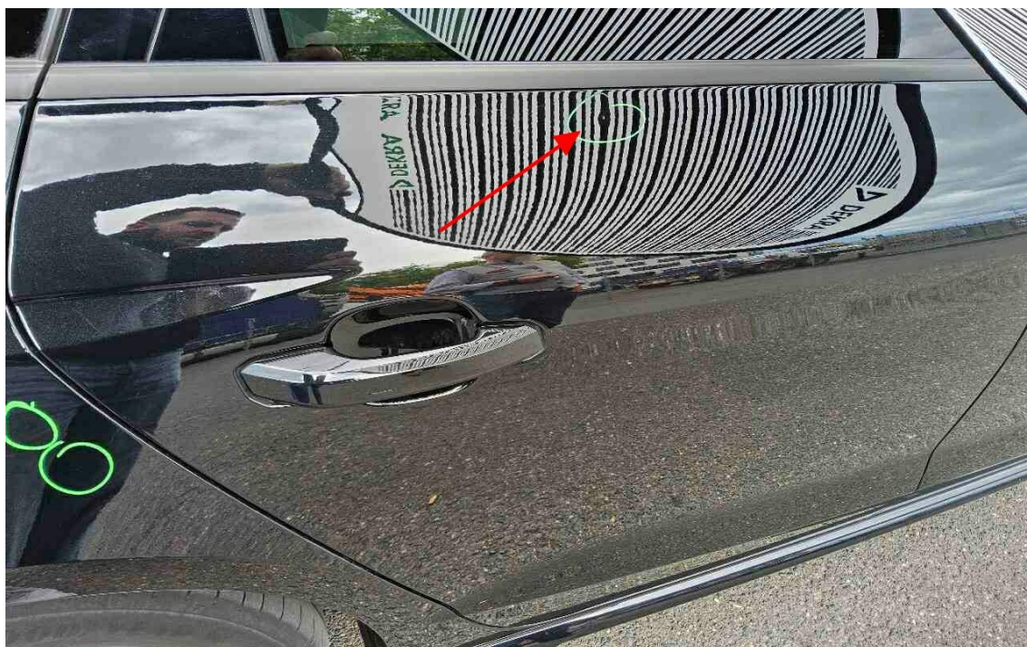
Bild 34 : Tür hinten rechts, eingedellt, drücken
