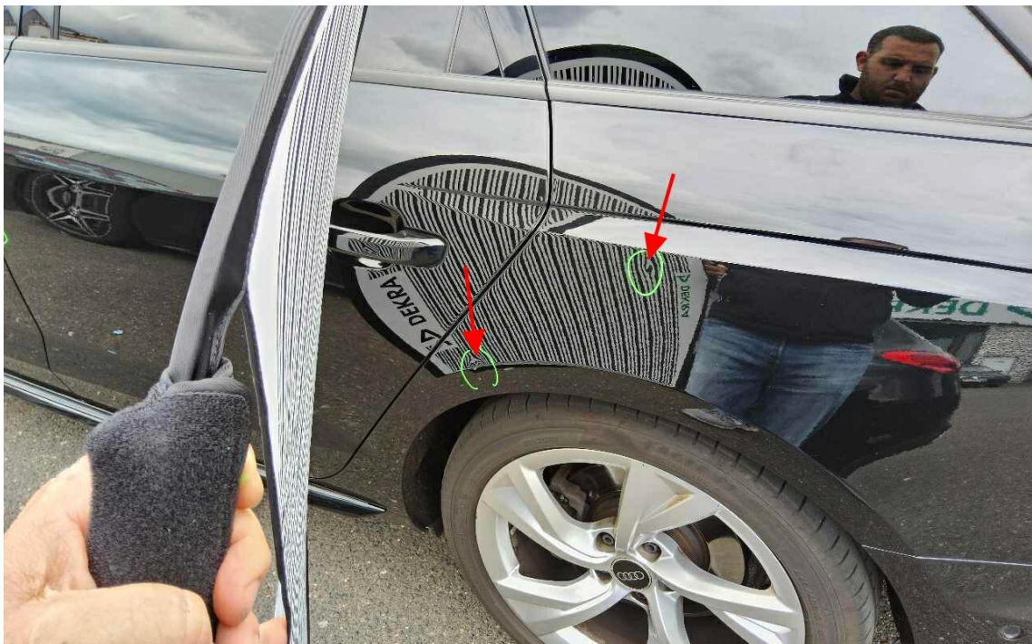
Bild 26 : Seitenteil hinten links, mehrfach eingeclippt, instandsetzen und lackieren mit Lackaufbau
