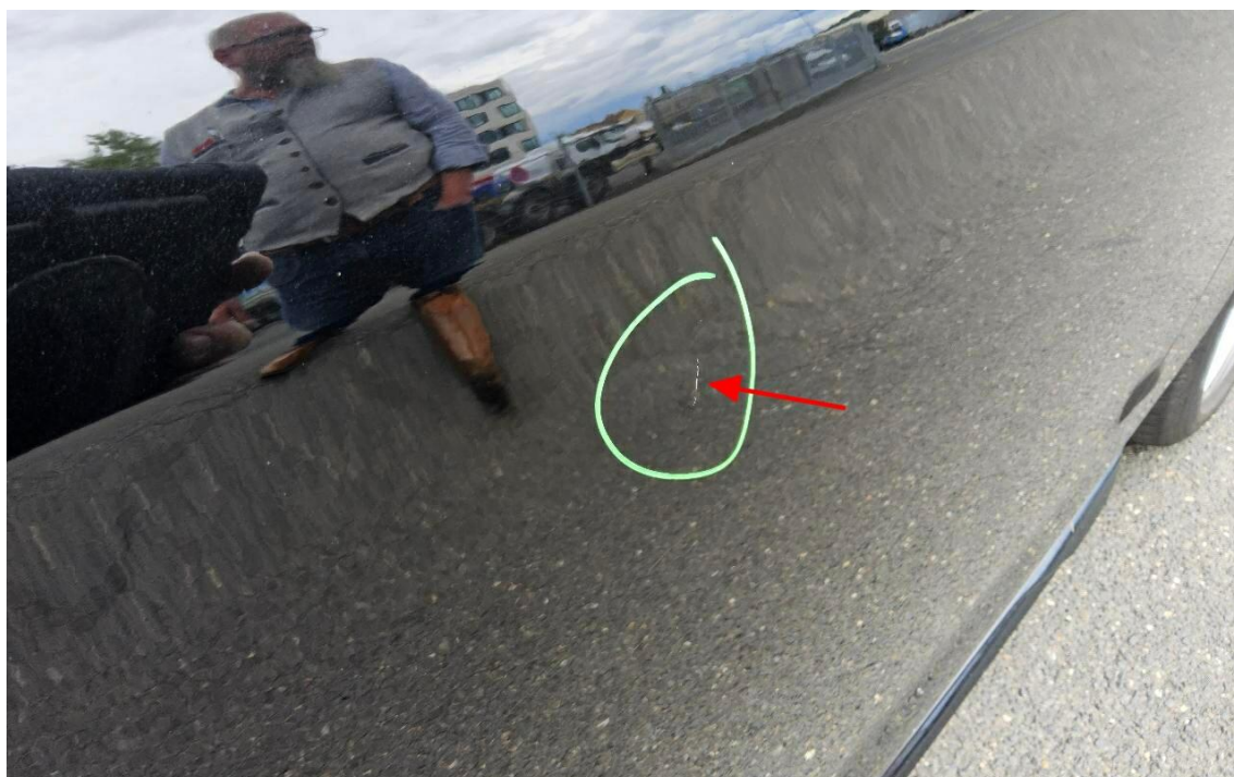
Bild 36 : Tür vorne rechts Lackierung, zerkratzt, Gebrauchsspur
