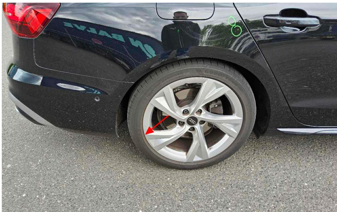
Bild 19 : Felge hinten rechts Lackierung, verschrammt, lackieren
