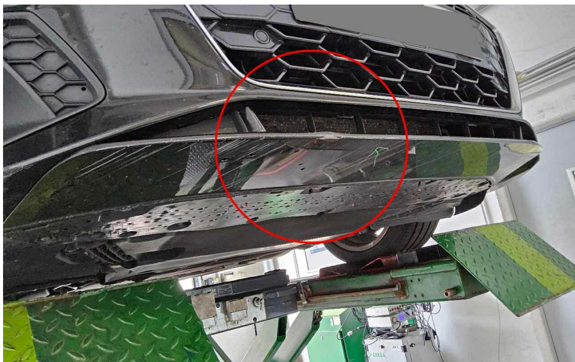
Bild 17 : Stoßfängerverkleidung vorne eingedellt/gerissen
