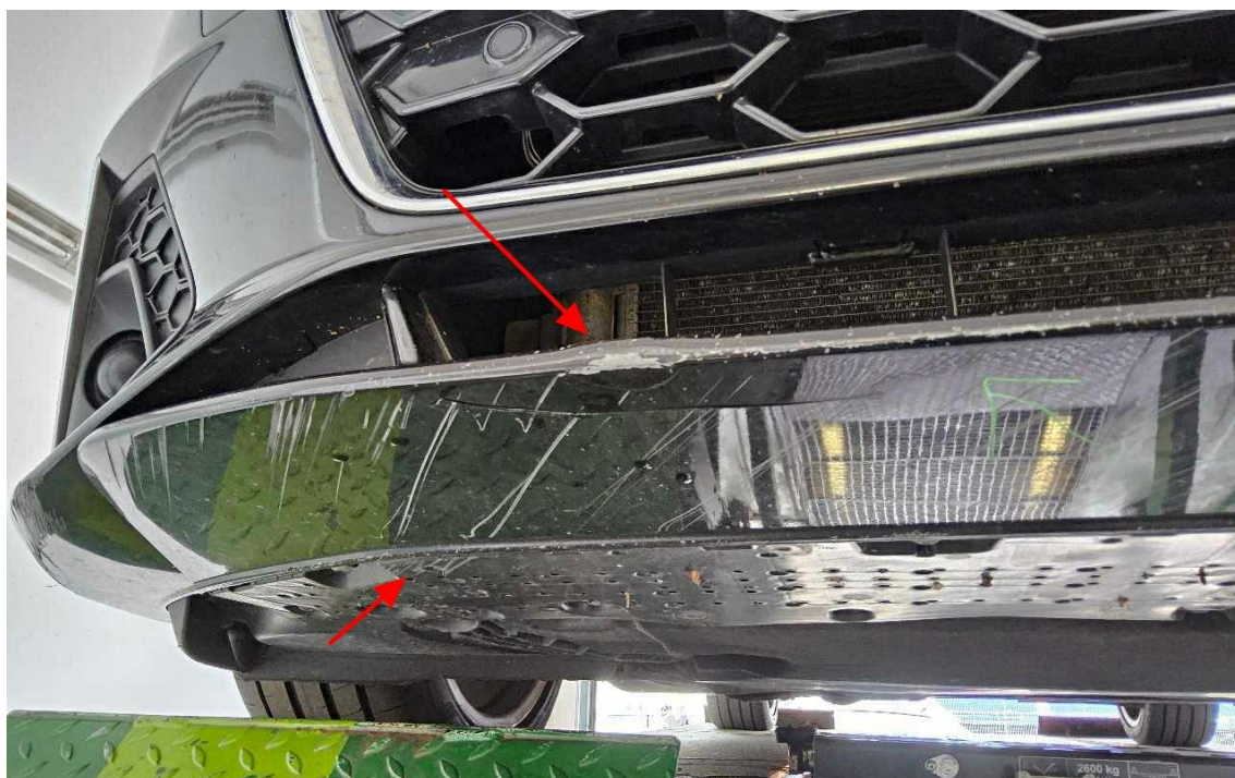
Bild 15 : Stoßfängerverkleidung vorne eingedellt/gerissen
