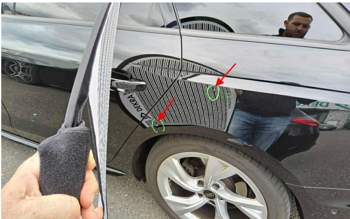
Bild 28 : Seitenteil hinten links, mehrfach eingedellt, instandsetzen und lackieren mit Lackaufbau
