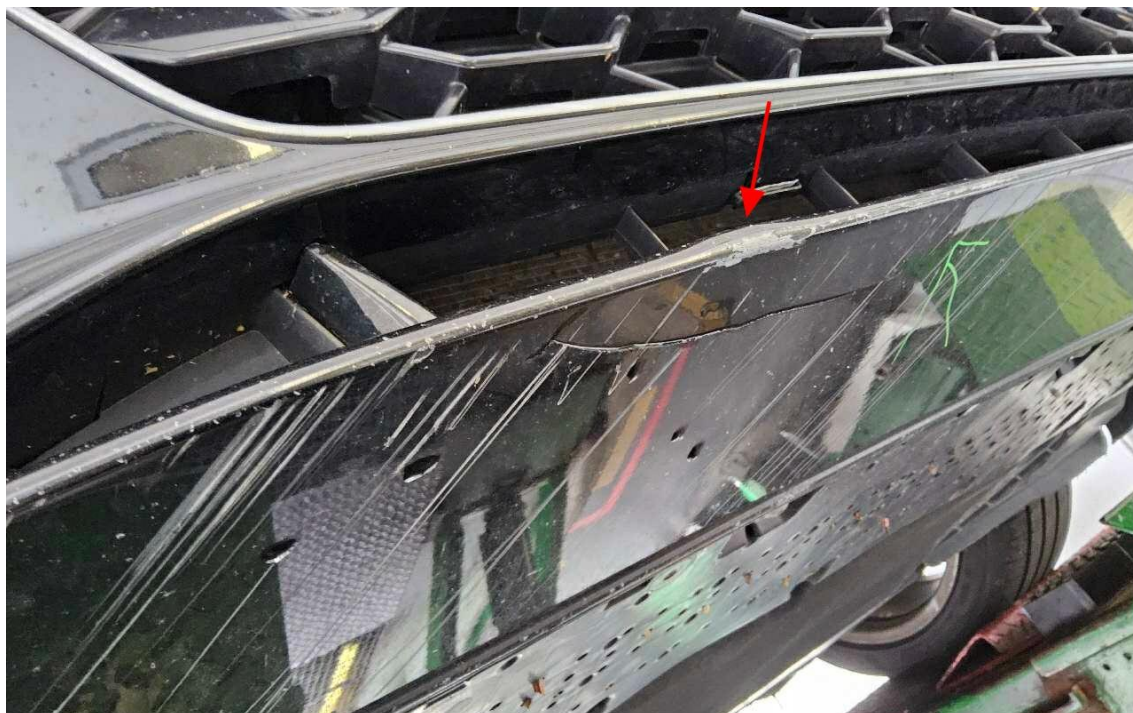
Bild 16 : Stoßfängerverkleidung vorne eingedellt/gerissen
