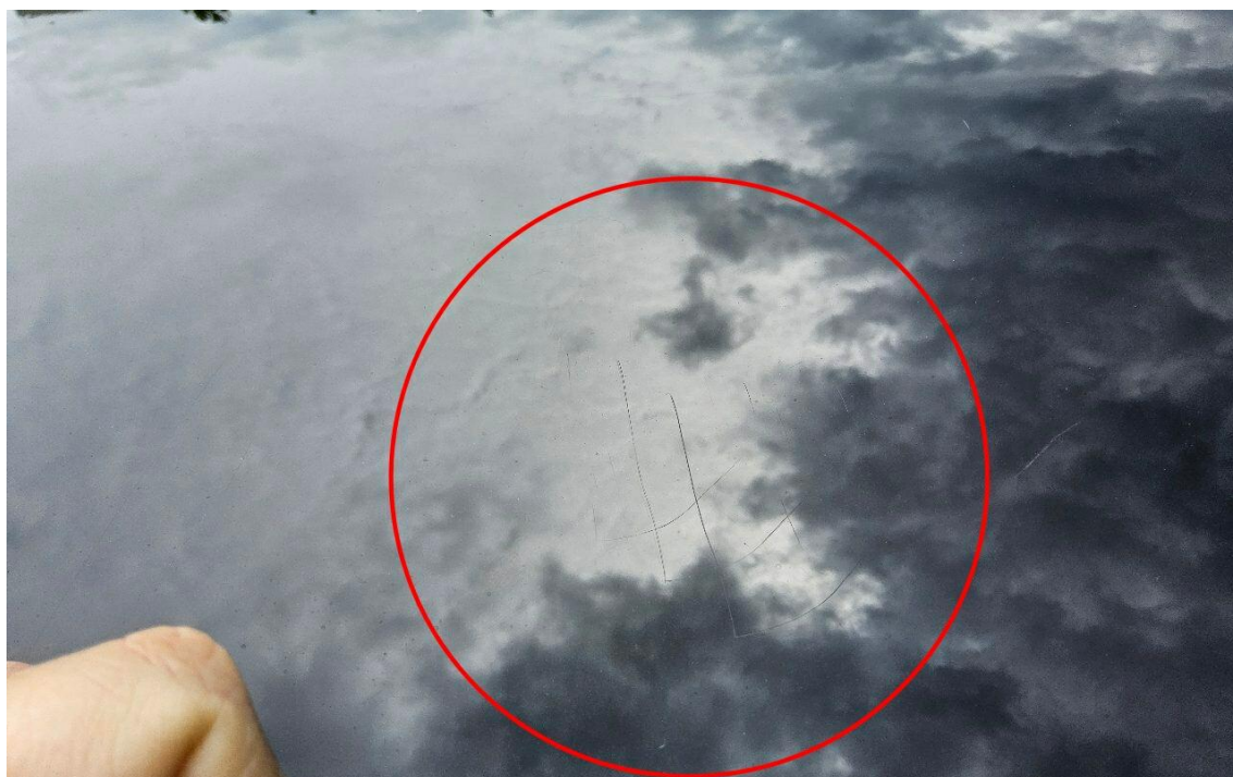
Bild 20 : Dach Lackierung, zerkratzt, polieren
