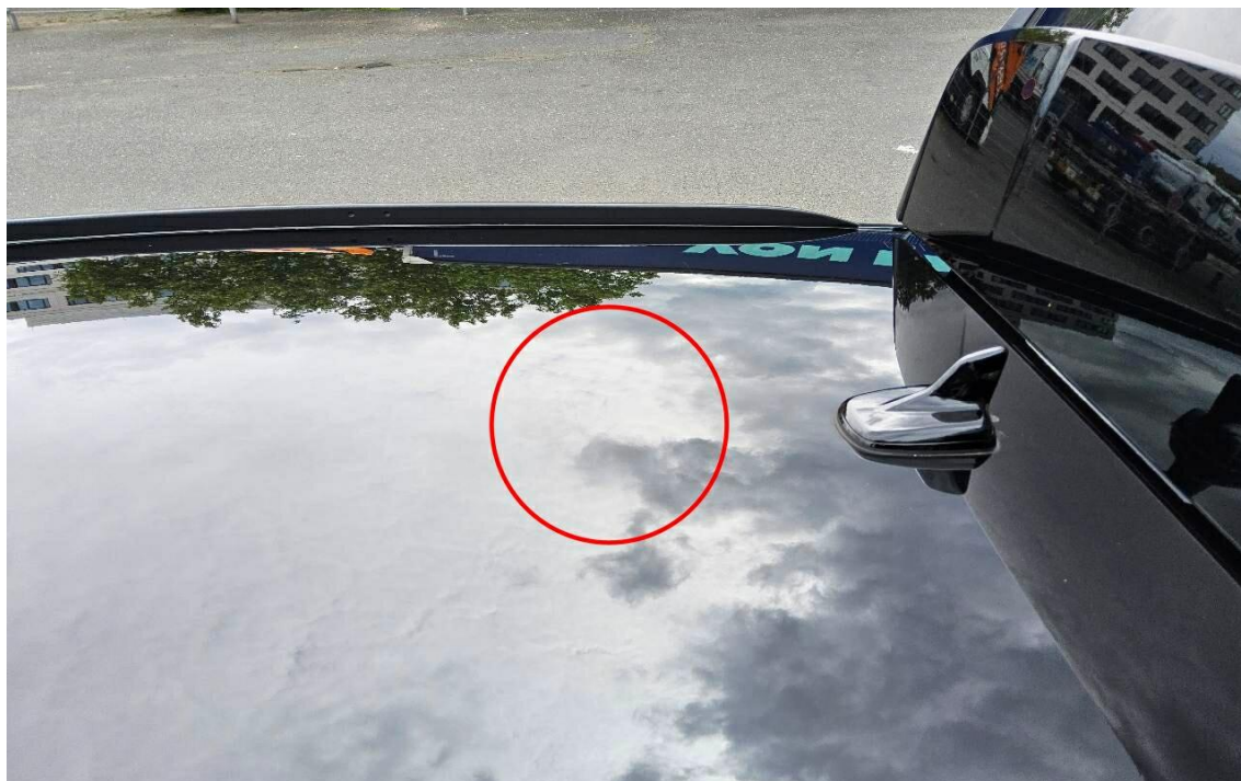
Bild 21 : Dach Lackierung, zerkratzt, polieren
