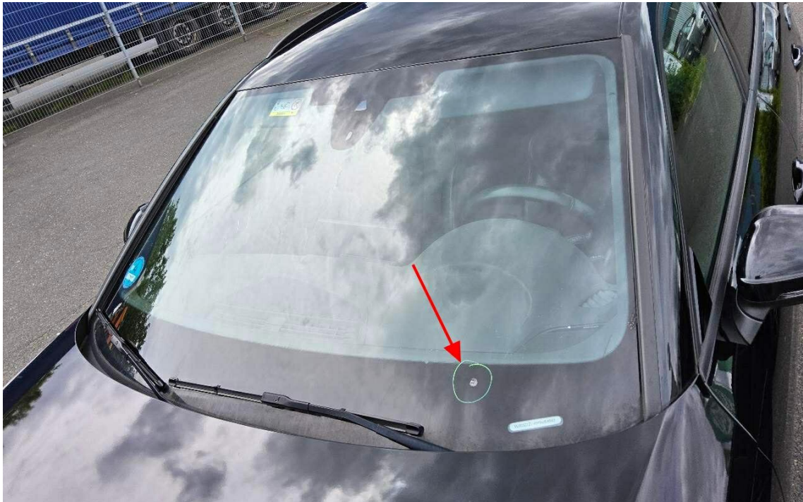
Bild 23 : Windschutzscheibe Steinschlag mit Rissbildung
