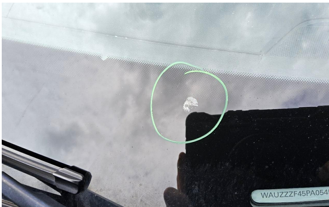
Bild 22 : Windschutzscheibe Steinschlag mit Rissbildung
