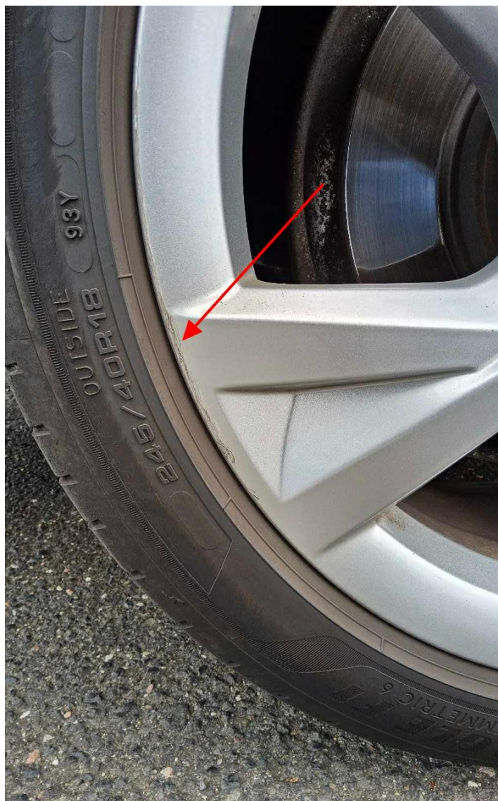
Bild 18 : Felge hinten rechts Lackierung, verschrammt, lackieren
