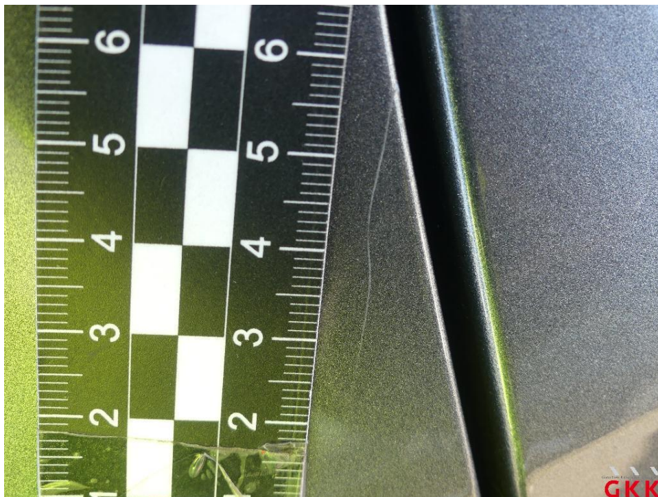
Bild 14. Tür vorne links, verkratzt, lackieren
