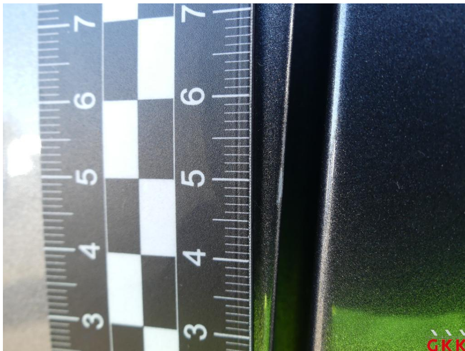
Bild 15. Tür vorne links, verkratzt, lackieren
