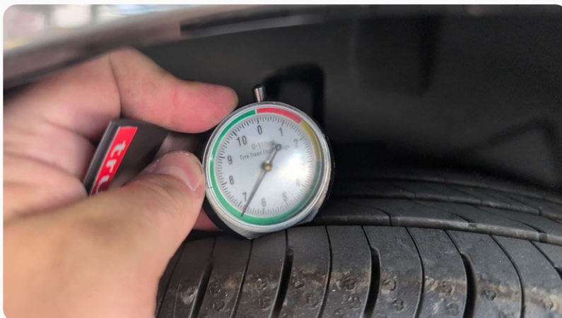
Photo mesure usure pneu arrière gauche
