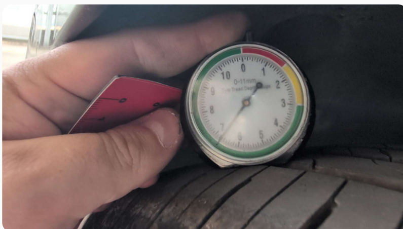
Photo mesure usure pneu avant gauche
