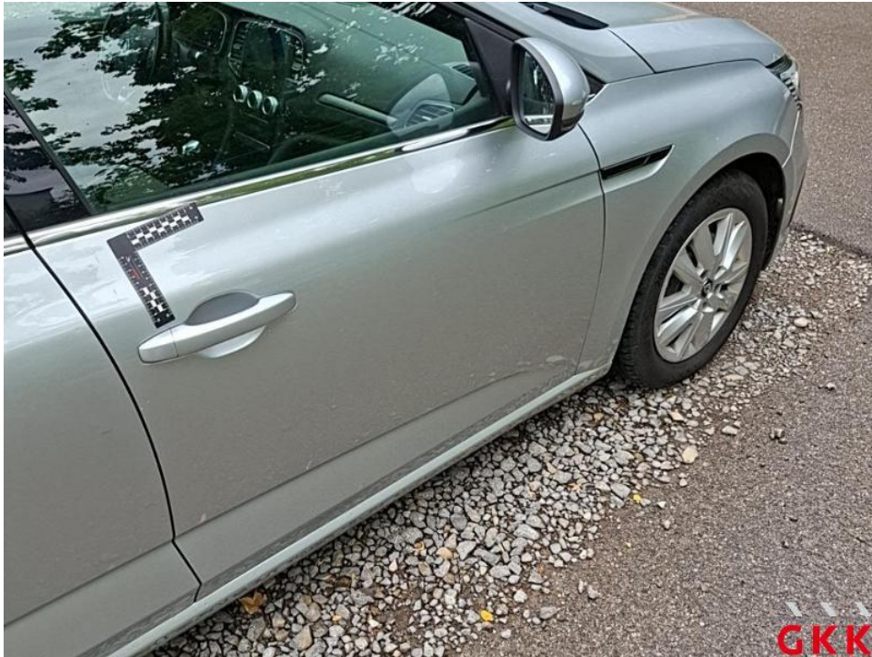
Bild 27. Tür vorne rechts, verkratzt, lackieren
