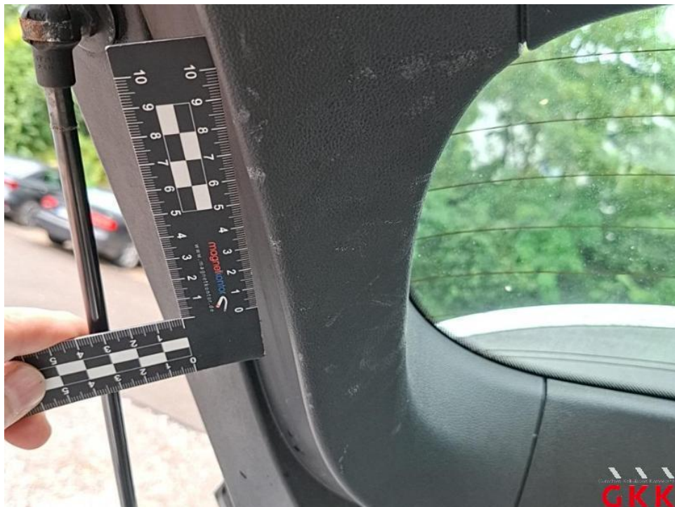
Bild 56. Heckklappe, Innenverkleidung, verkratzt, Smartrepair
