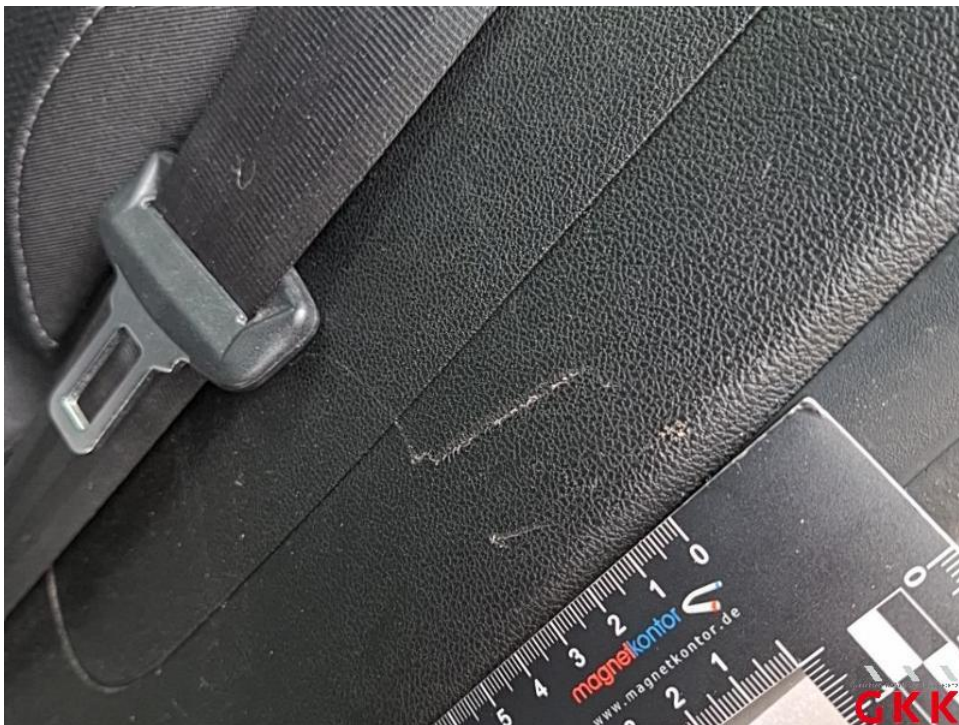
Bild 52. C- Säule links, Innenverkleidung -unterhalb-, beschädigt, ersetzen
