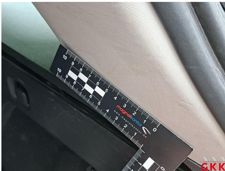
Bild 68. D- Säule rechts, Innenverkleidung, verkratzt, ersetzen
