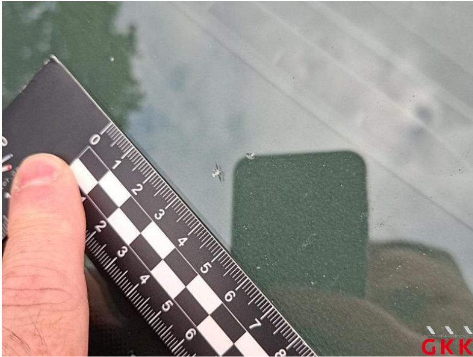
Bild 41. Frontscheibe, mit Regensensor und Frontkamera, Steinschlag im Sichtfeld, ersetzen
