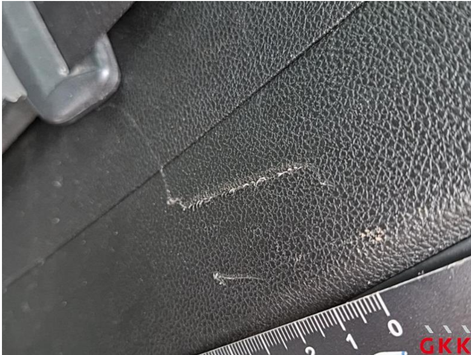
Bild 53. C- Säule links, Innenverkleidung -unterhalb-, beschädigt, ersetzen
