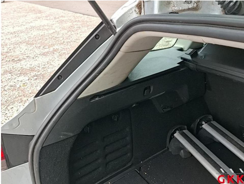
Bild 63. D- Säule links, Innenverkleidung, verkratzt, ersetzen
