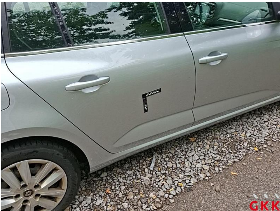
Bild 20. Tür vorne rechts, verkratzt, lackieren
