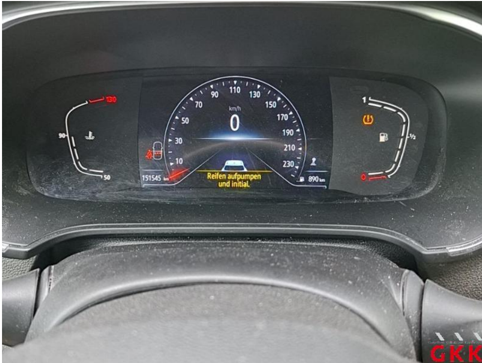
Bild 13. Reifen, Fehlerspeicher, aktiv, auslesen / prüfen
