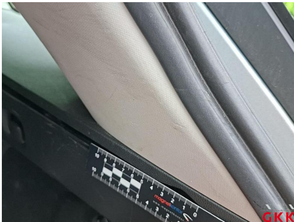
Bild 67. D- Säule rechts, Innenverkleidung, verkratzt, ersetzen
