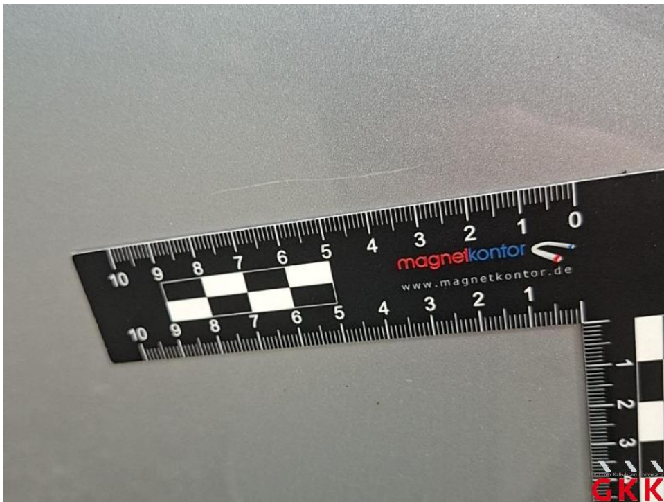
Bild 50. Tür hinten links, verkratzt, lackieren
