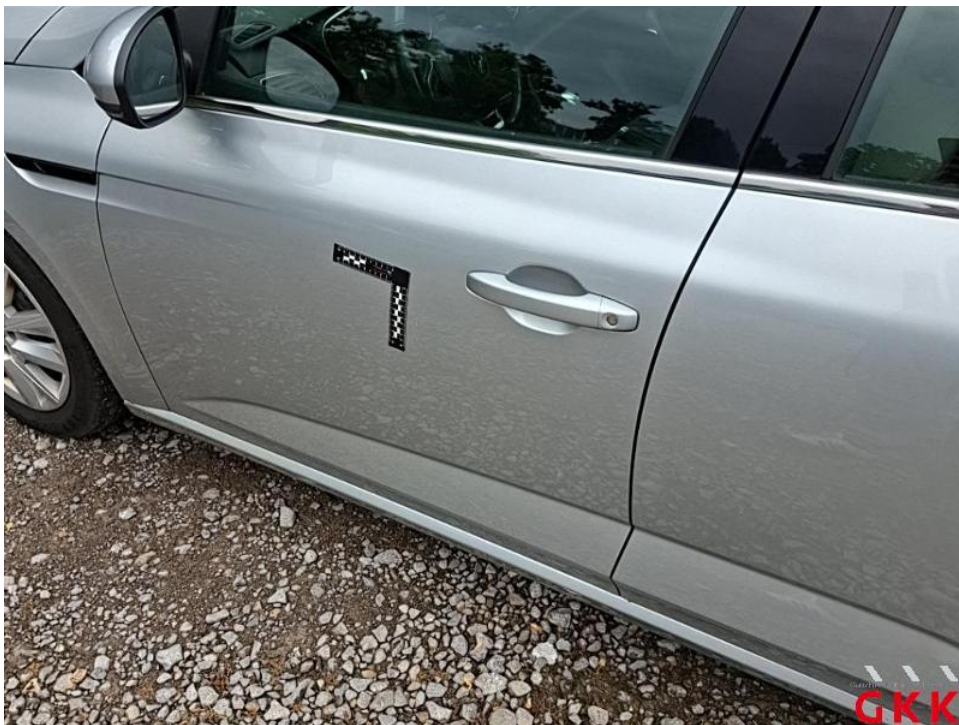
Bild 42. Tür vorne links, verkratzt, lackieren
