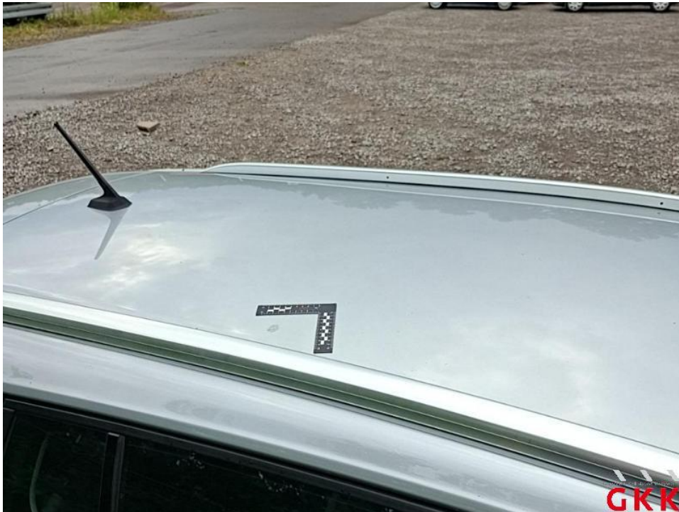
Bild 14. Dach, Lackierung abgeplatzt, lackieren
