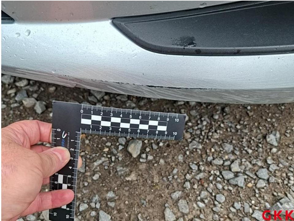
Bild 35. Stoßfänger vorne, Verkleidung -lackiert-, verkratzt, lackieren
