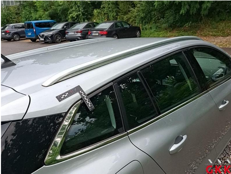
Bild 17. Dach, Holm rechts, verkratzt, lackieren
