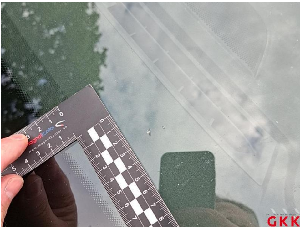
Bild 40. Frontscheibe, mit Regensensor und Frontkamera, Steinschlag im Sichtfeld, ersetzen
