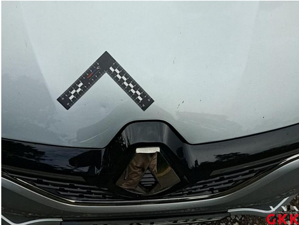
Bild 37. Motorhaube, bis 3 Dellen / Bauteil, instand setzen - lackieren
