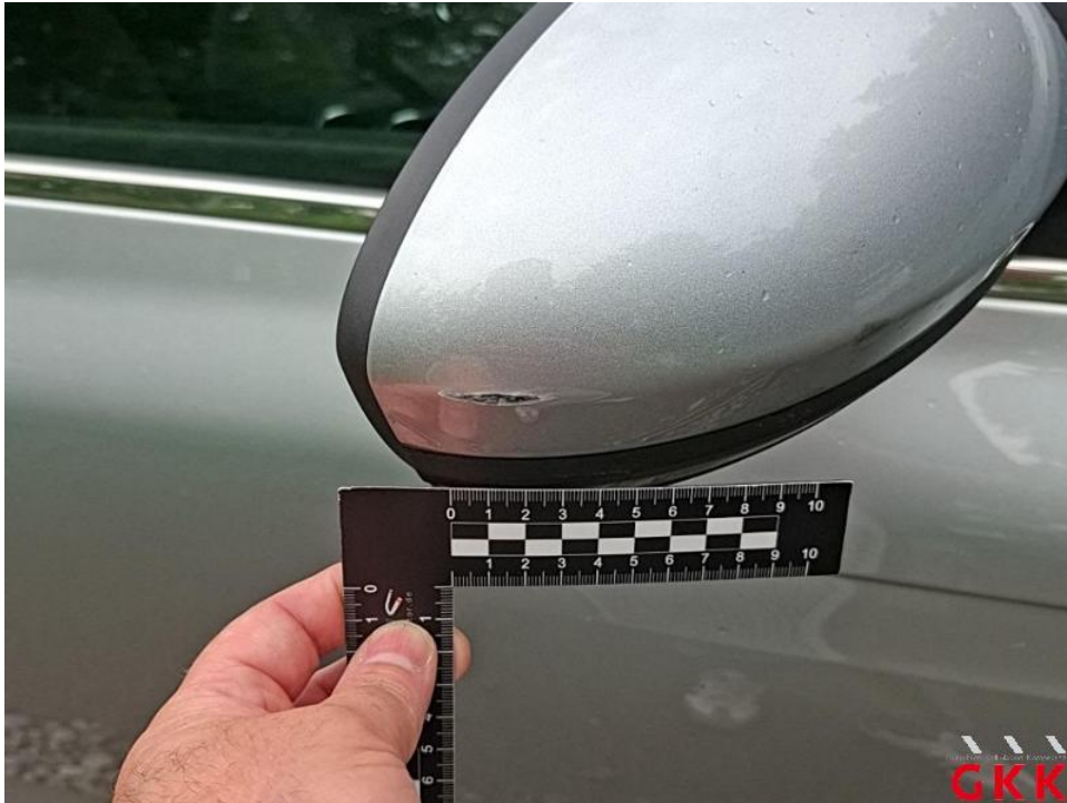
Bild 31. Spiegelgehäuse rechts, Kappe -lackiert-, verkratzt, lackieren
