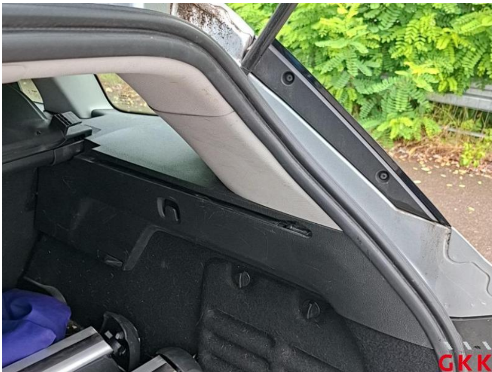
Bild 66. D- Säule rechts, Innenverkleidung, verkratzt, ersetzen
