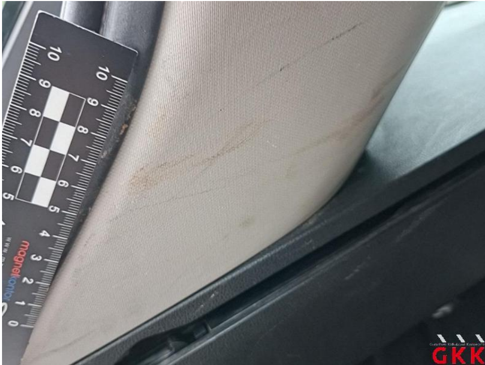
Bild 65. D- Säule links, Innenverkleidung, verkratzt, ersetzen
