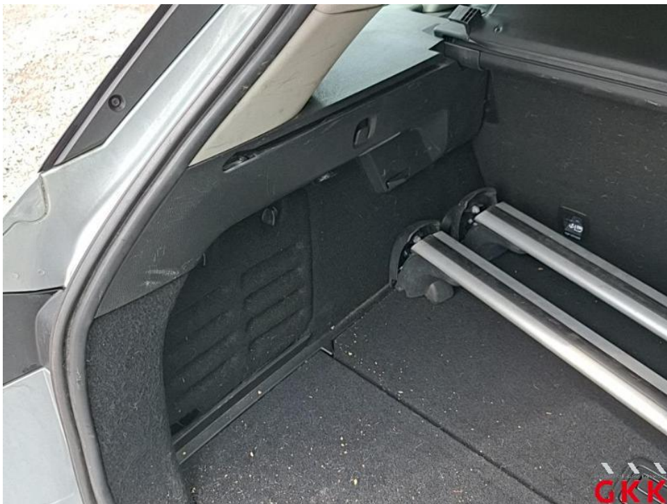
Bild 60. Seitenwand links, Innenverkleidung, verkratzt, Smartrepair
