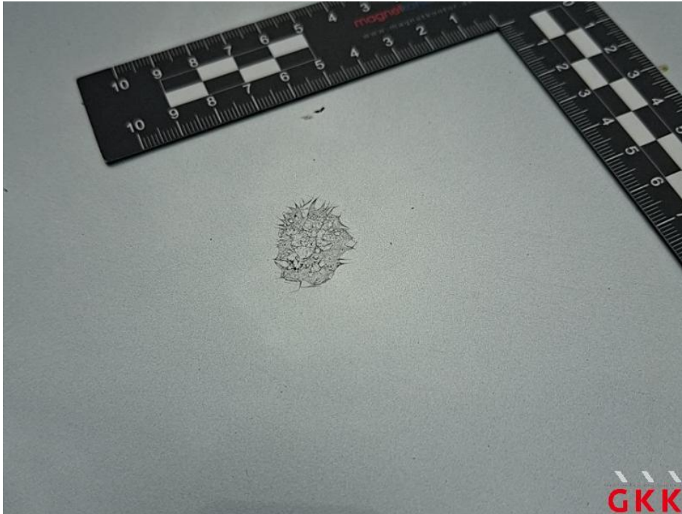
Bild 15. Dach, Lackierung abgeplatzt, lackieren
