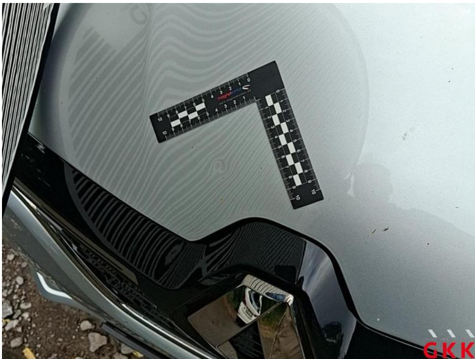
Bild 38. Motorhaube, bis 3 Dellen / Bauteil, instand setzen - lackieren
