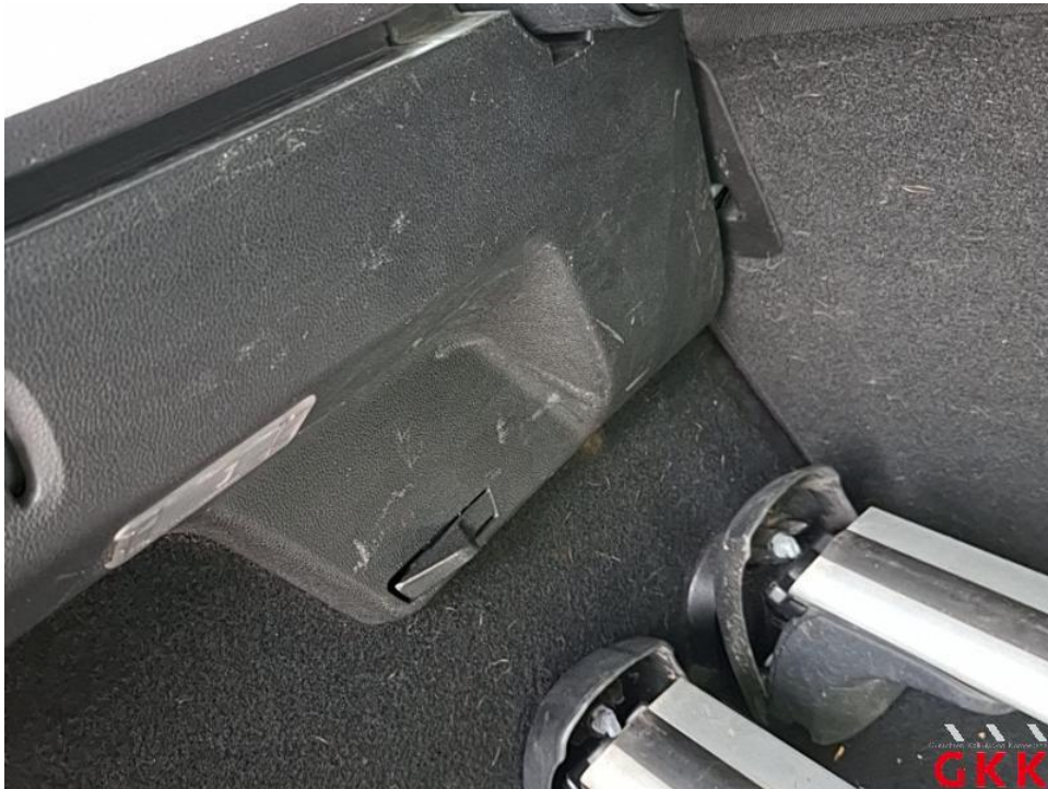
Bild 62. Seitenwand links, Innenverkleidung, verkratzt, Smartrepair
