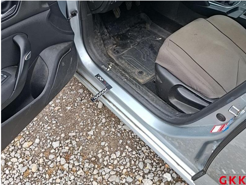
Bild 45. Tür vorne links, Einstieg, verkratzt, lackieren
