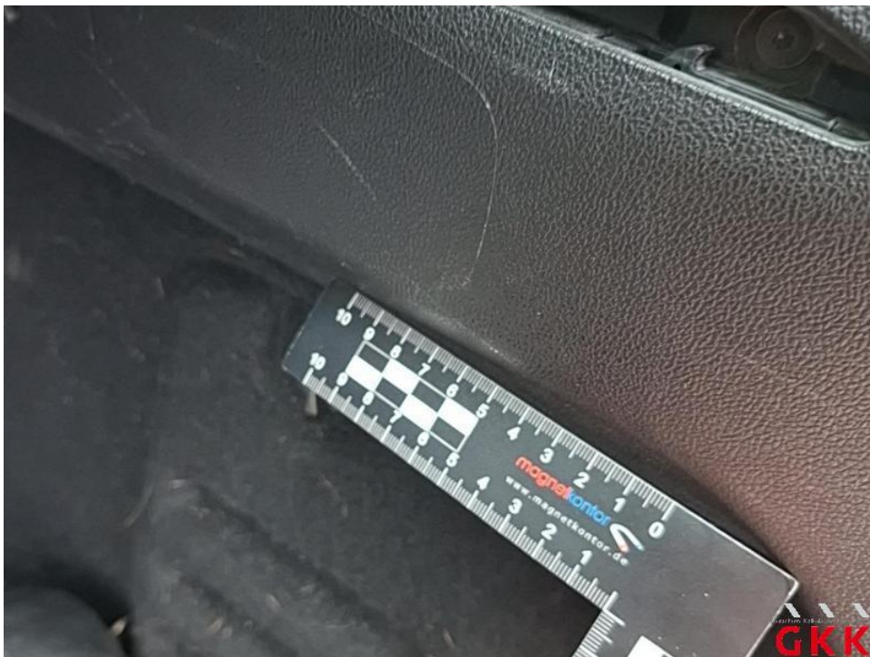
Bild 58. Seitenwand rechts, Innenverkleidung, verkratzt, Smartrepair
