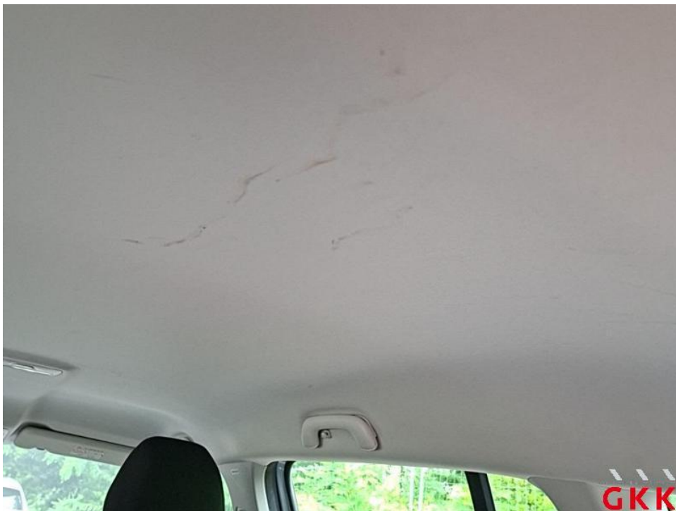
Bild 70. Himmel, verschmutzt, reinigen
