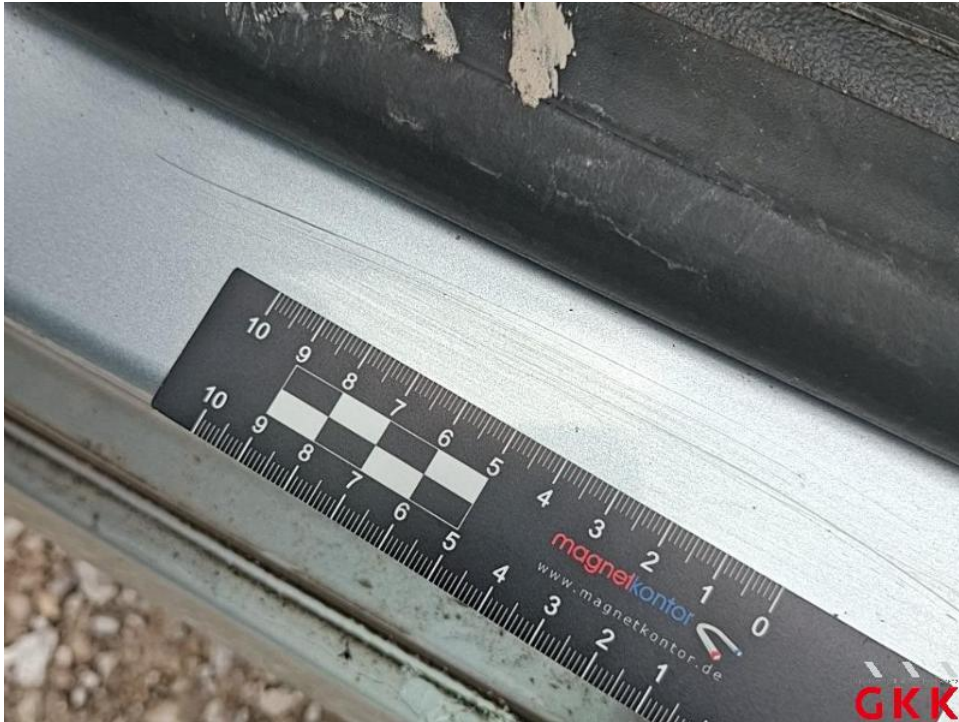
Bild 47. Tür vorne links, Einstieg, verkratzt, lackieren
