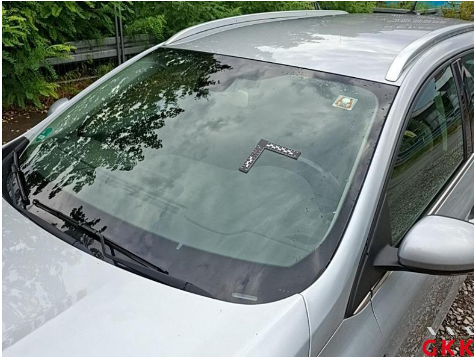
Bild 39. Frontscheibe, mit Regensensor und Frontkamera, Steinschlag im Sichtfeld, ersetzen
