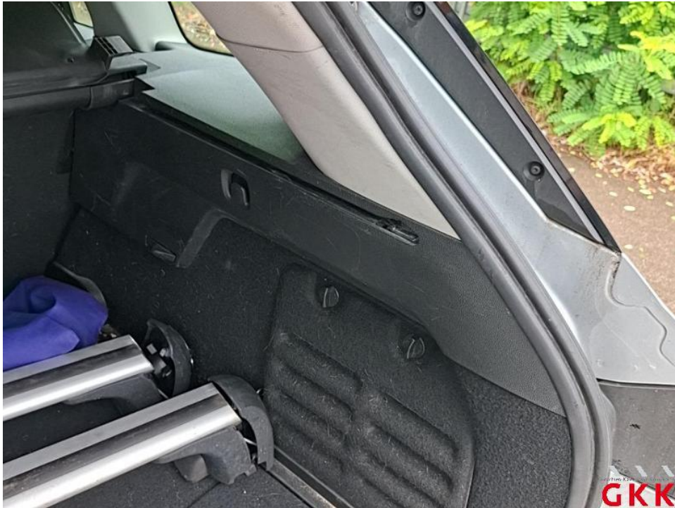
Bild 57. Seitenwand rechts, Innenverkleidung, verkratzt, Smartrepair
