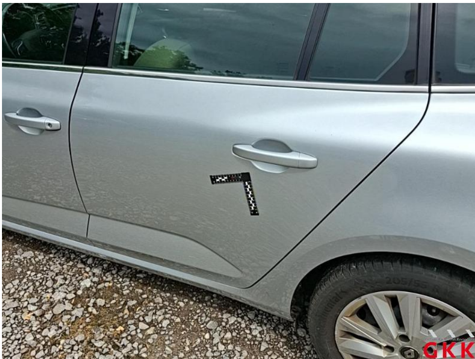
Bild 48. Tür hinten links, verkratzt, lackieren
