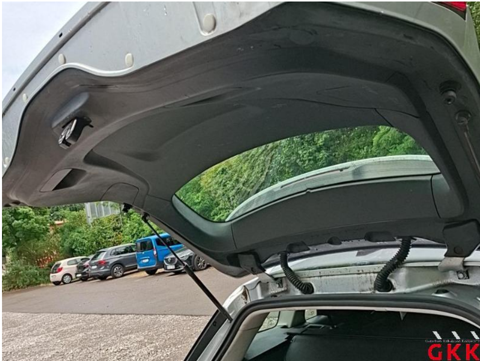
Bild 54. Heckklappe, Innenverkleidung, verkratzt, Smartrepair
