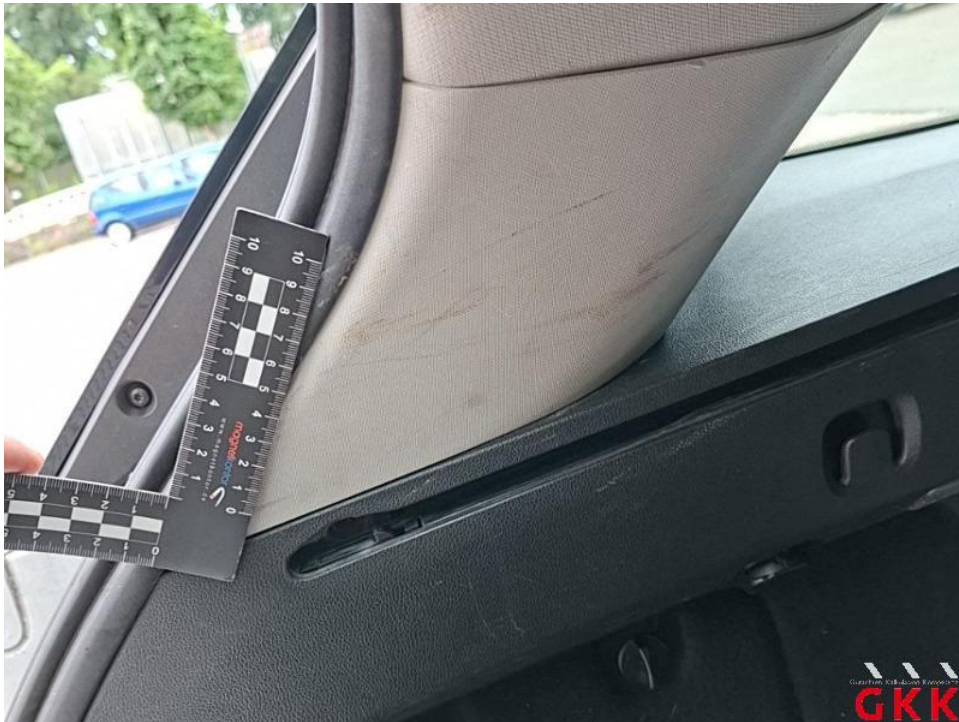
Bild 64. D- Säule links, Innenverkleidung, verkratzt, ersetzen
