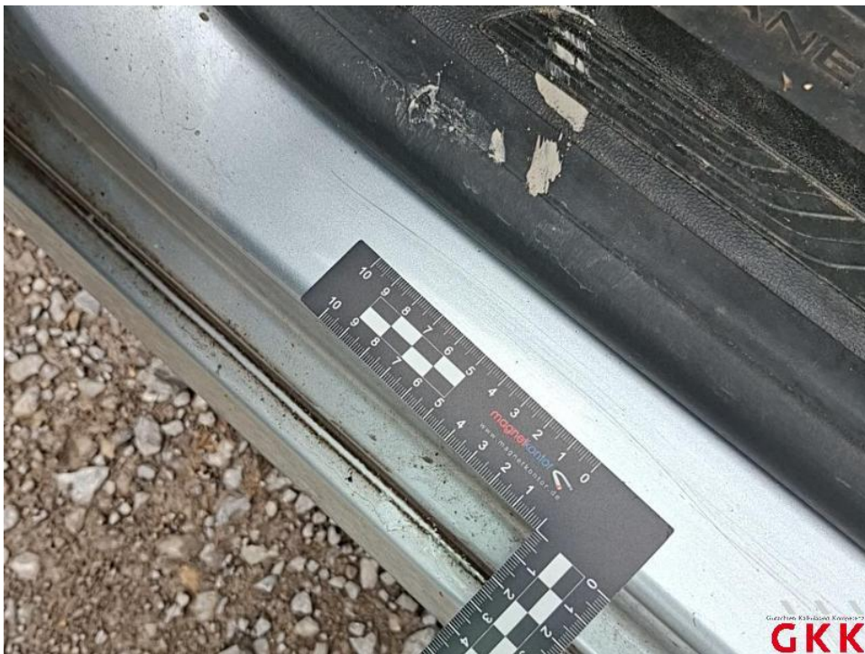
Bild 46. Tür vorne links, Einstieg, verkratzt, lackieren
