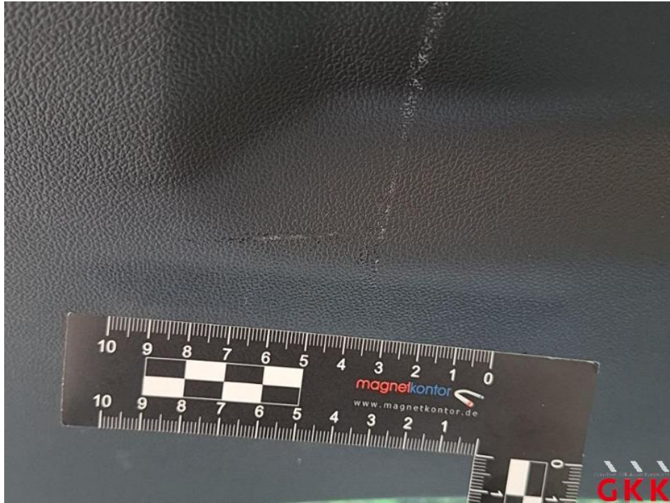
Bild 55. Heckklappe, Innenverkleidung, verkratzt, Smartrepair
