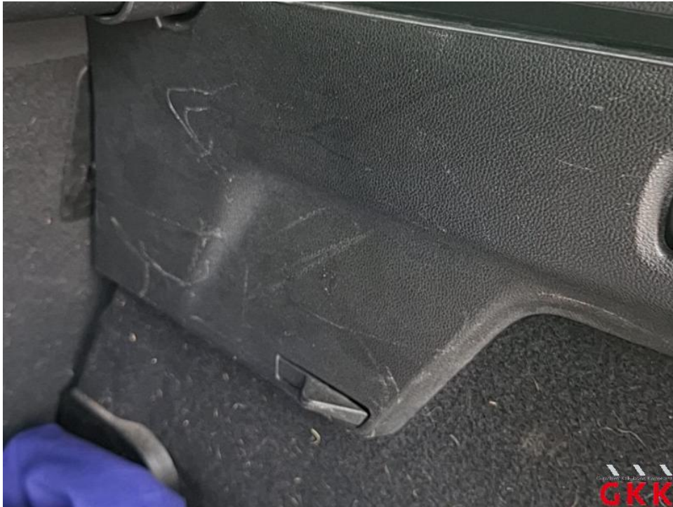
Bild 59. Seitenwand rechts, Innenverkleidung, verkratzt, Smartrepair
