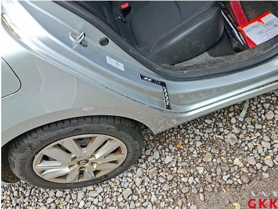
Bild 23. Tür hinten rechts, Einstieg, verkratzt, lackieren
