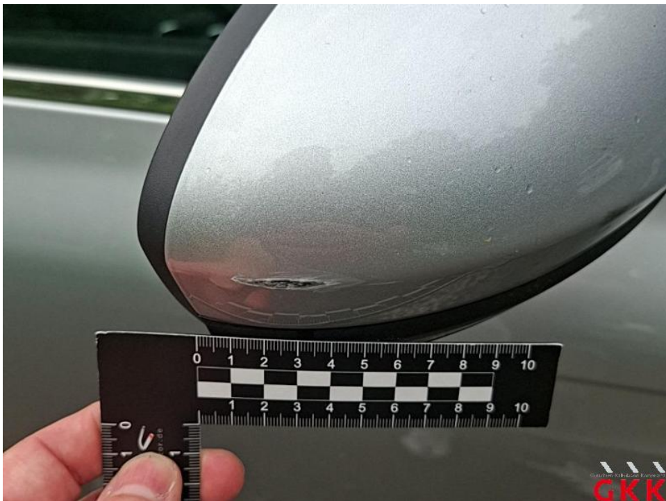
Bild 32. Spiegelgehäuse rechts, Kappe -lackiert-, verkratzt, lackieren
