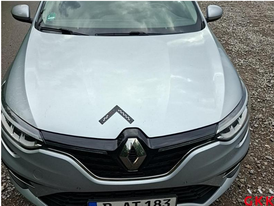
Bild 36. Motorhaube, bis 3 Dellen / Bauteil, instand setzen - lackieren
