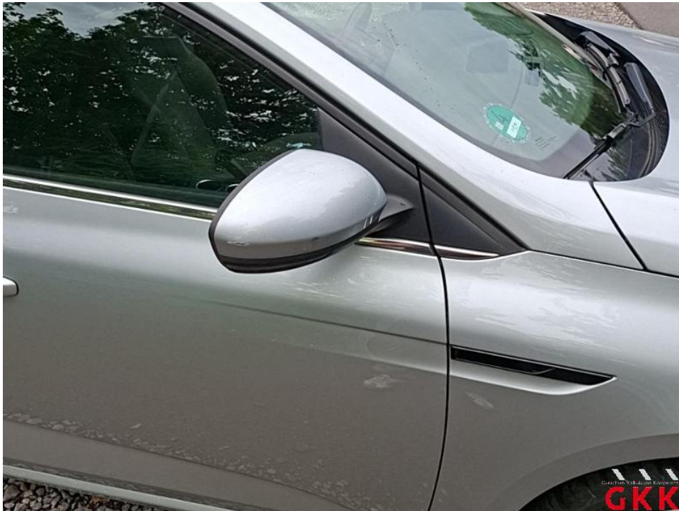
Bild 30. Spiegelgehäuse rechts, Kappe -lackiert-, verkratzt, lackieren
