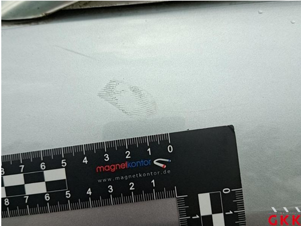
Bild 19. Dach, Holm rechts, verkratzt, lackieren
