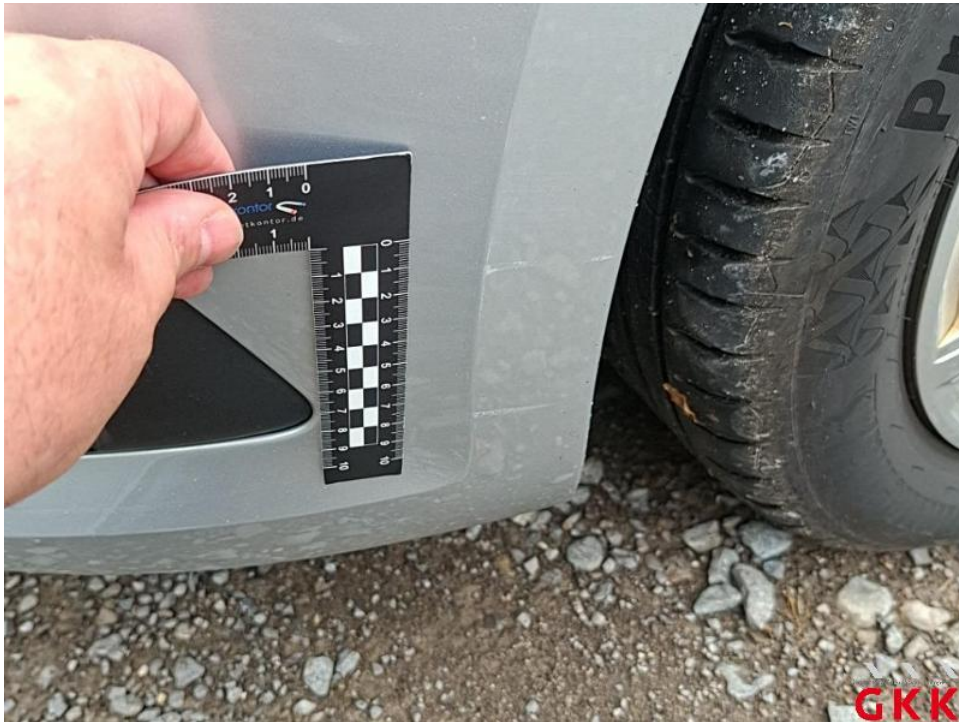
Bild 34. Stoßfänger vorne, Verkleidung -lackiert-, verkratzt, lackieren
