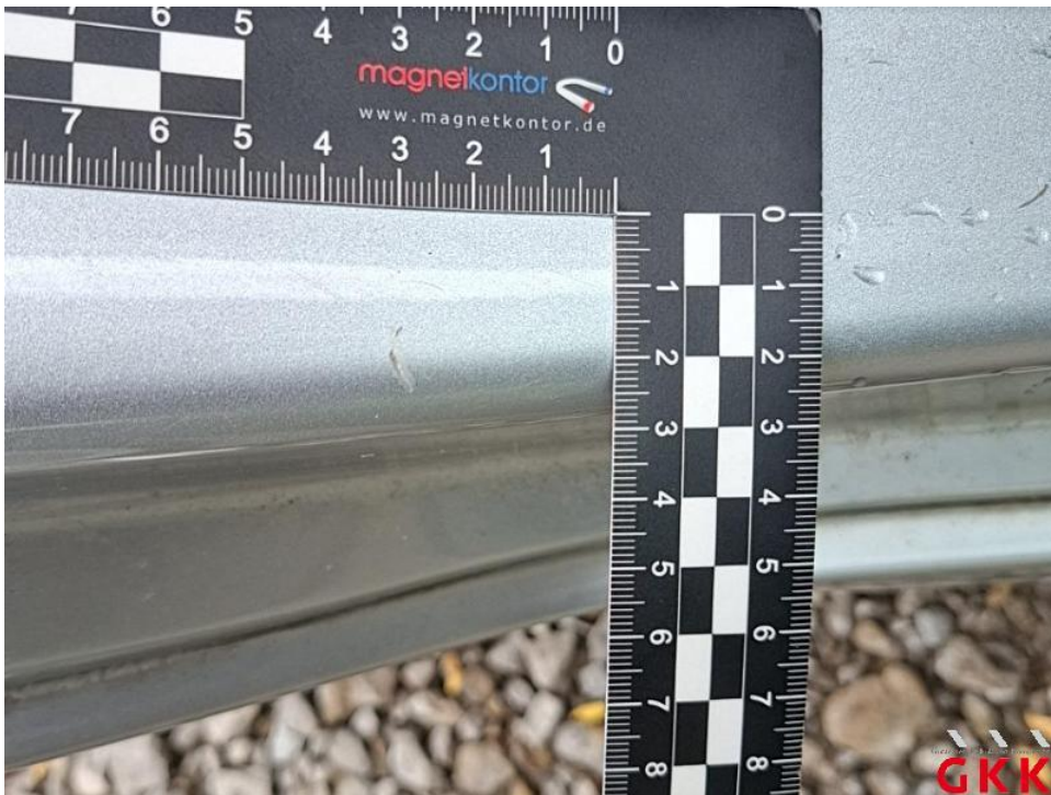
Bild 24. Tür hinten rechts, Einstieg, verkratzt, lackieren
