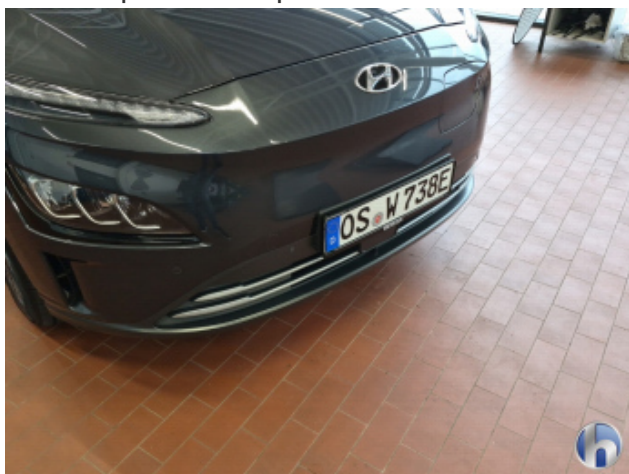
6. Frontspoiler Abschürfung - Smart Repair
