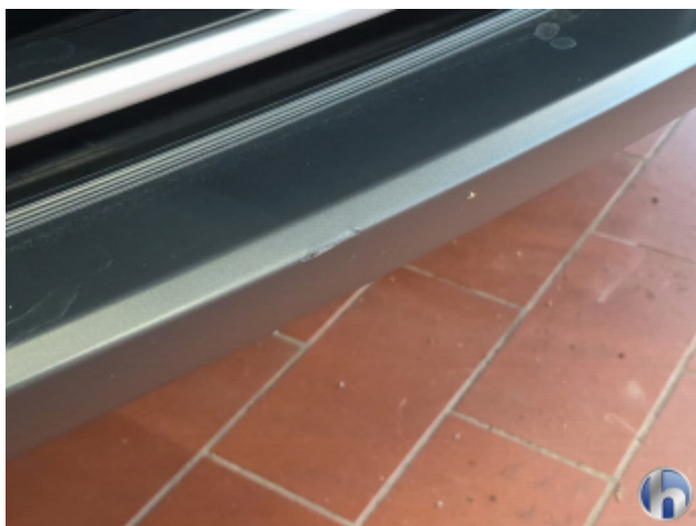
6. Frontspoiler Abschürfung - Smart Repair
