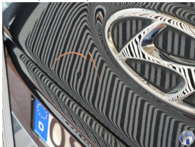
3. Heckklappe Gebrauchsspuren - Ohne Reparatur
