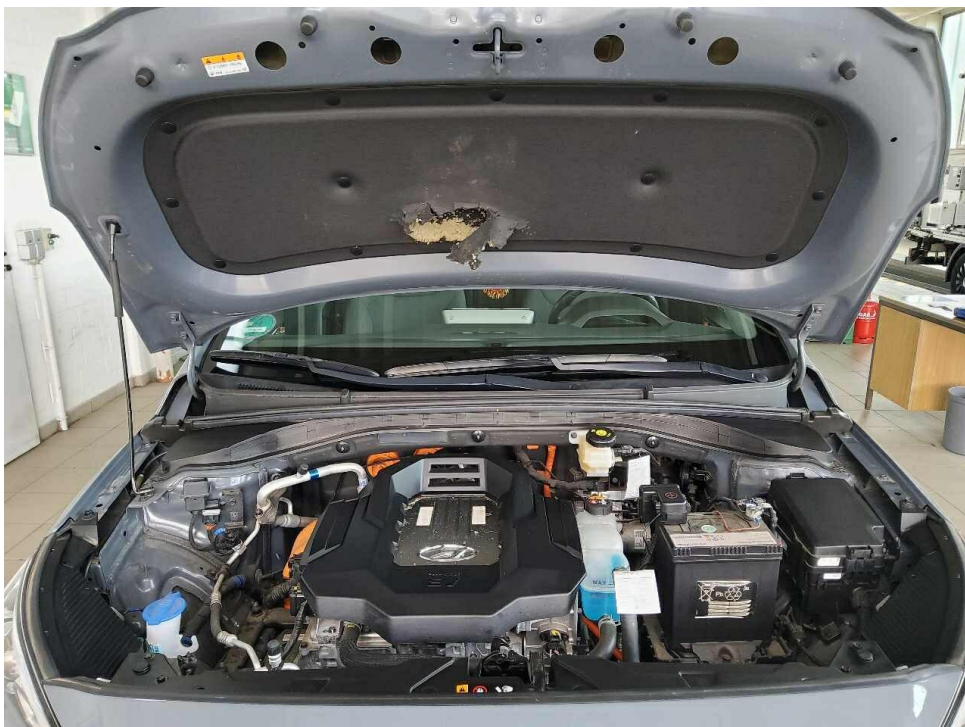
Bild 24 : Dämmung Motorhaube Marderbiss
