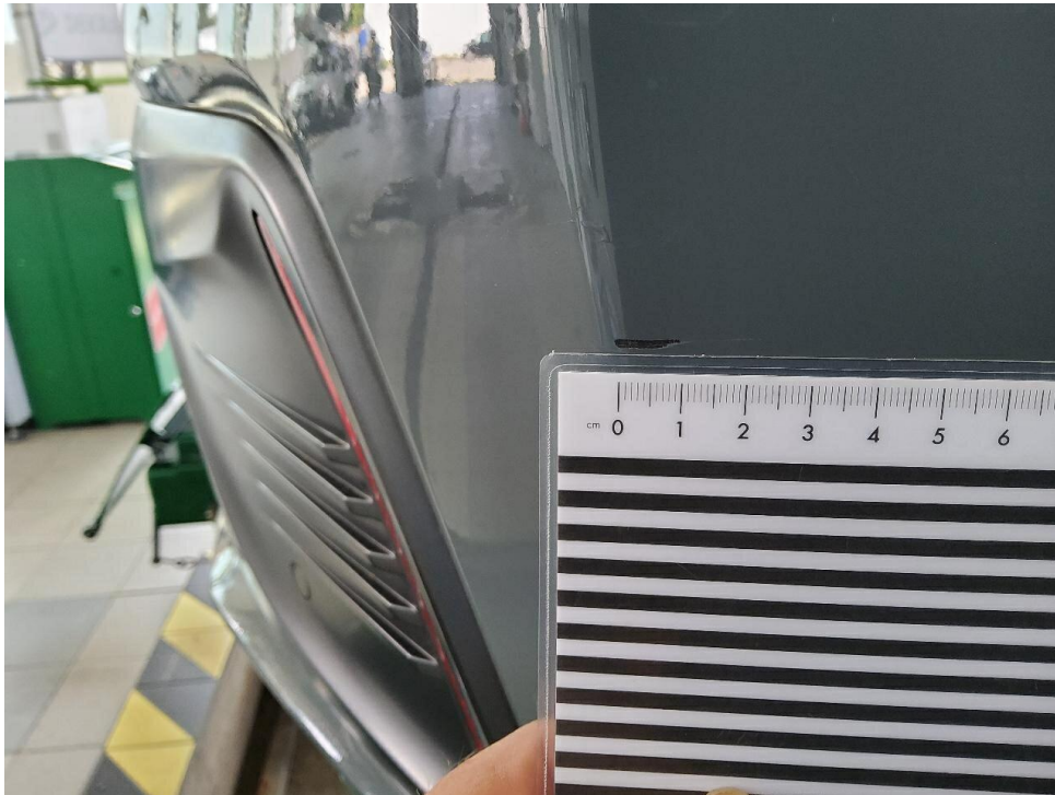
Bild 21 : Stoßfänger hinten rechts verschrammt
