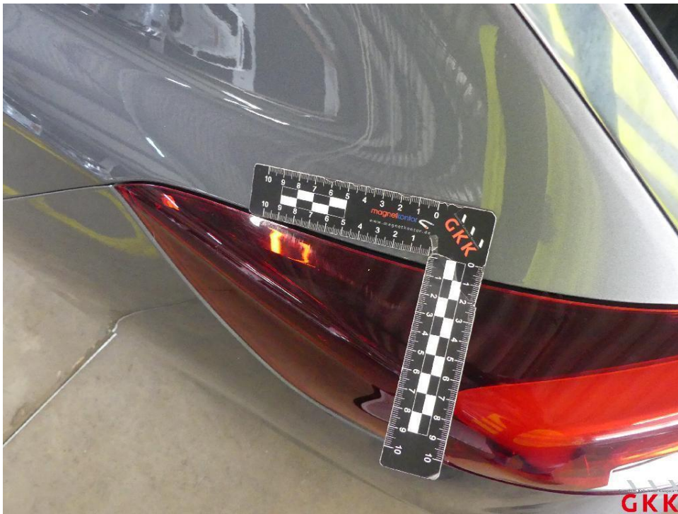
Bild 28 Rückleuchte links, Glas, verkratzt, ersetzen
