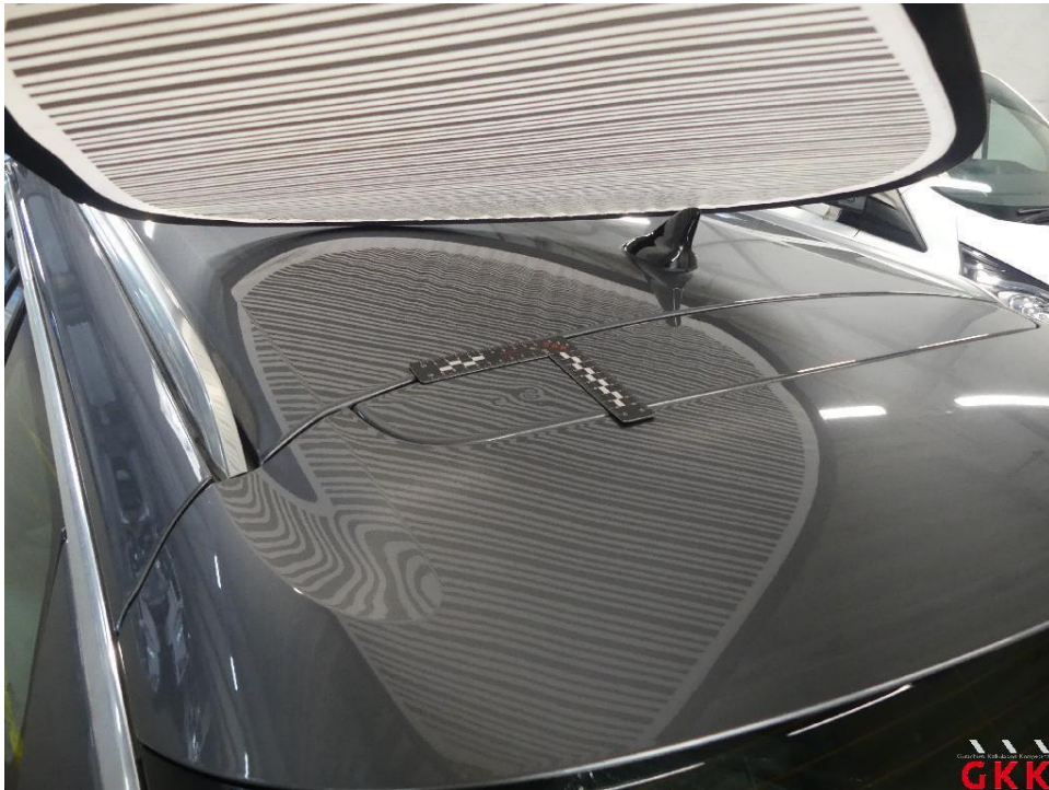
Bild 25 Heckklappe, oberhalb, beschädigt, instand setzen - lackieren
