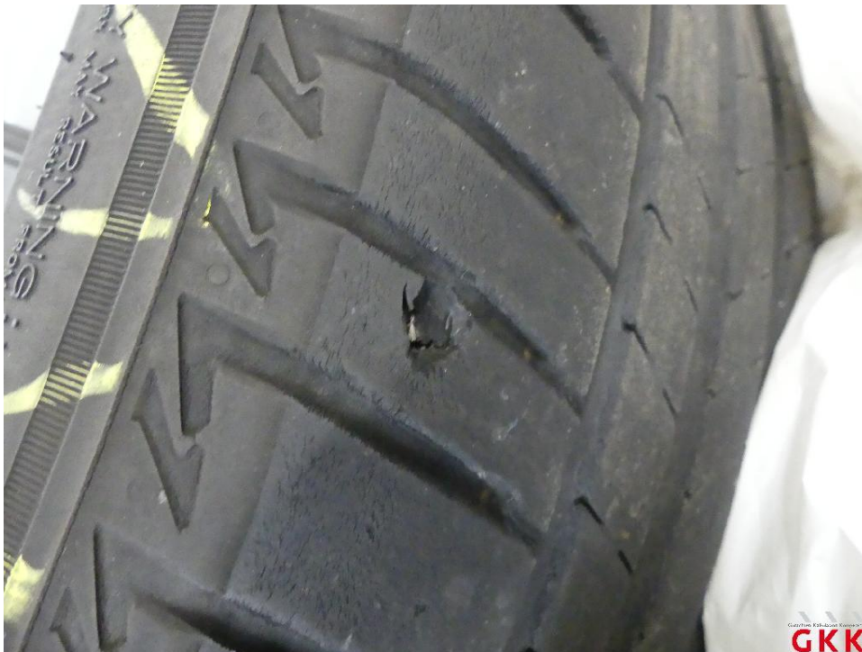
Bild 34 Reifen, 1 x beiliegend, beschädigt, ersetzen
