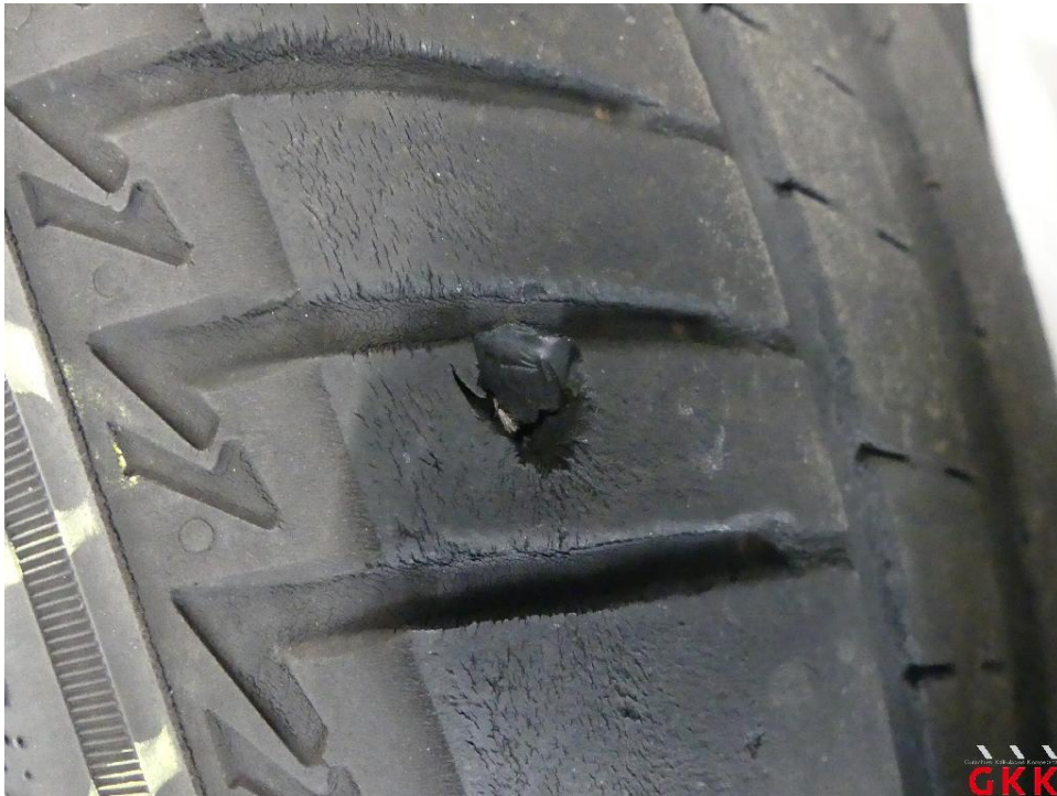
Bild 35 Reifen, 1 x beiliegend, beschädigt, ersetzen
