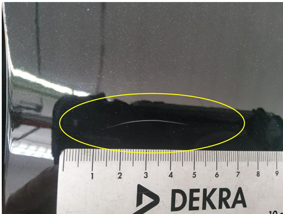
Bild 22 : Seitenteil hinten links Lackierung, zerkratzt, lackieren mit Lackaufbau
