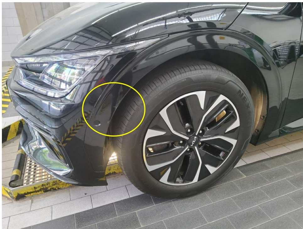
Bild 25 : Kotflügel vorne links Zierleiste Lackierung, zerkratzt, lackieren mit Lackaufbau
