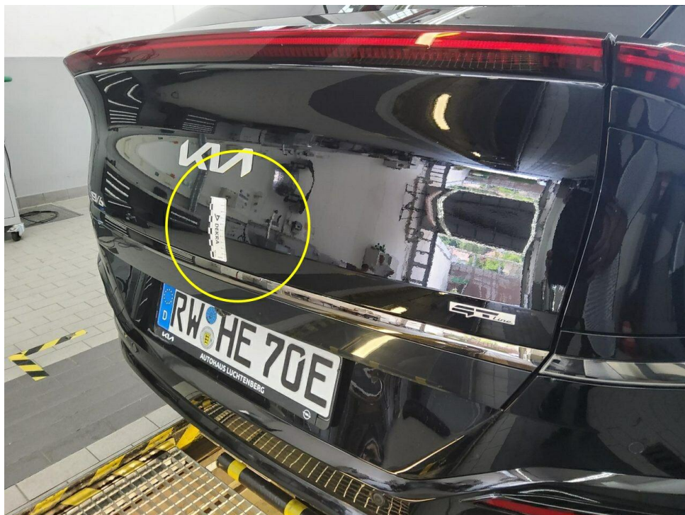
Bild 20 : Heckklappe, eingedellt, smart repair
