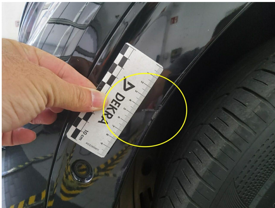
Bild 24 : Kotflügel vorne links Zierleiste Lackierung, zerkratzt, lackieren mit Lackaufbau
