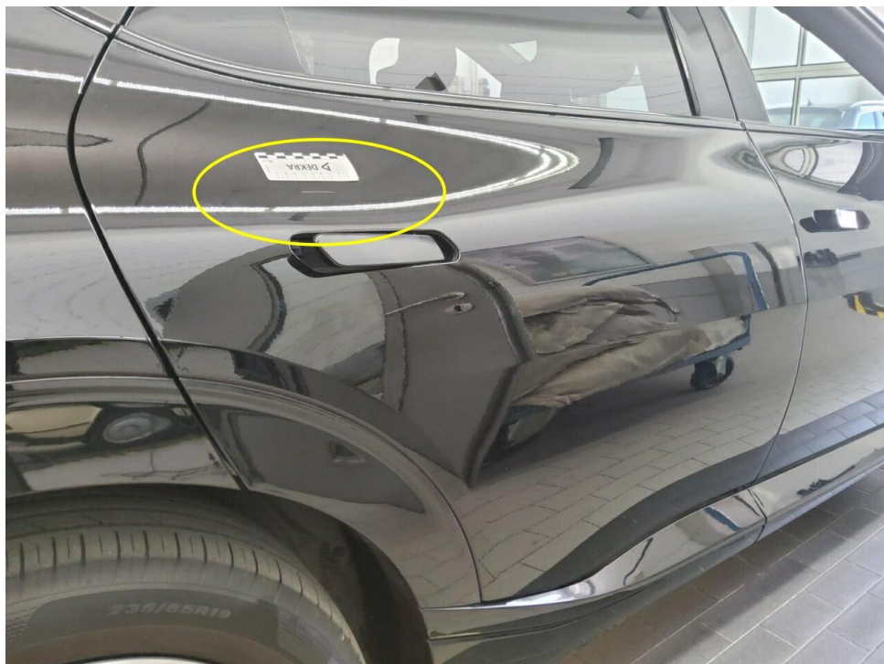
Bild 16 : Tür hinten rechts Lackierung, zerkratzt, lackieren mit Lackaufbau
