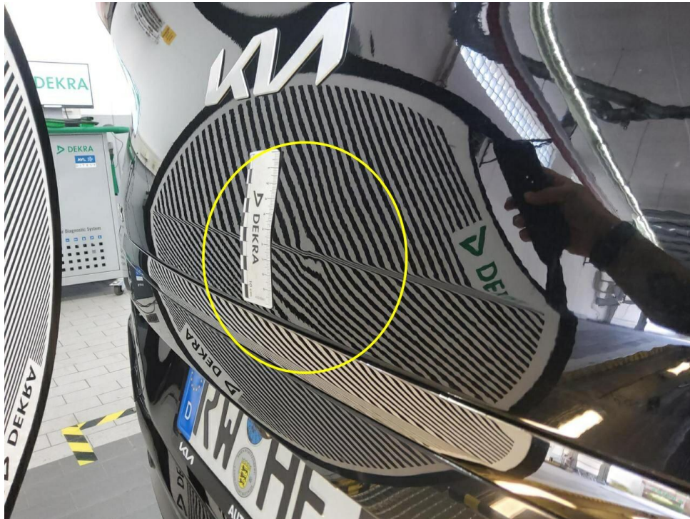
Bild 19 : Heckklappe, eingedellt, smart repair
