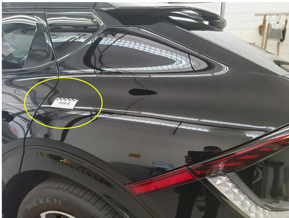
Bild 23 : Seitenteil hinten links Lackierung, zerkratzt, lackieren mit Lackaufbau
