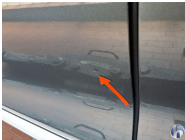
5. Tür Vorne - Links 1 Delle - Sanft Instandsetzen
