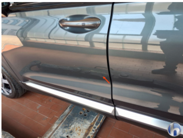
5. Tür Vorne - Links 1 Delle - Sanft Instandsetzen
