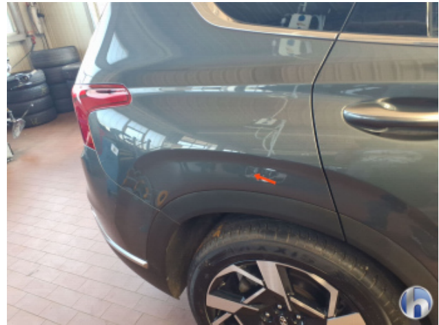
2. Seitenwand - Hinten - Rechts Gebrauchsspuren - Ohne Reparatur
