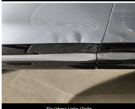
Tür / Vorne Links / Delle
