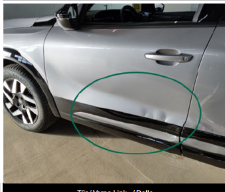
Tür / Vorne Links / Delle
