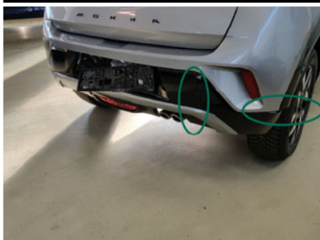
Stoßfängerleiste / Hinten / Gebrochen
