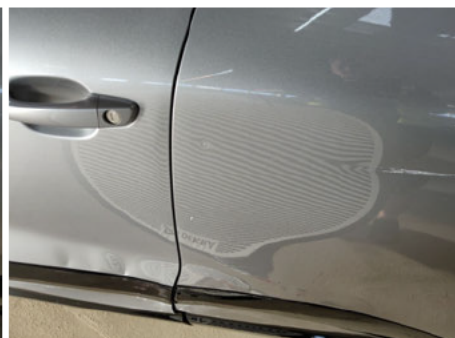
Tür / Hinten Links / Delle
