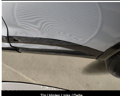
Tür / Hinten Links / Delle
