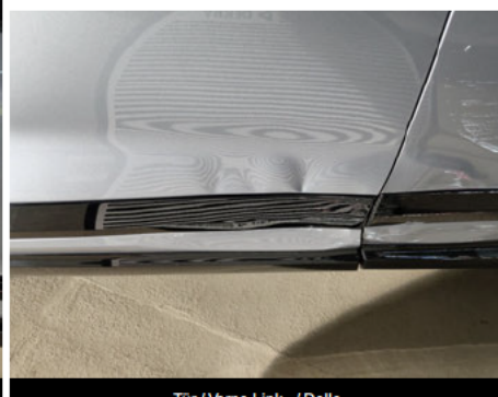
Tür / Vorne Links / Delle
