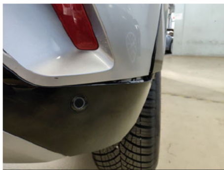
Stoßfängerleiste / Hinten / Gebrochen
