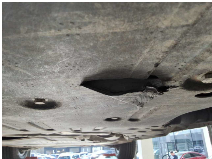
Beschädigung 7: Karosserie: Unterbodenverkleidung - beschädigt - erneuern
