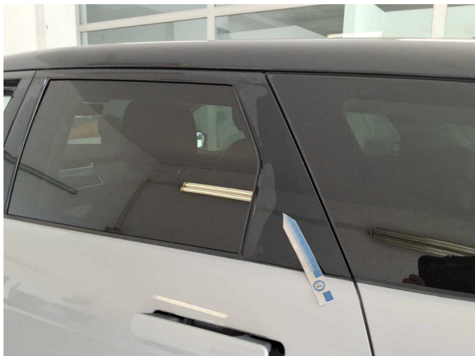
Beschädigung 13: Verglasung: Türscheibe hinten links (Blende) - Lackmangel - erneuern
