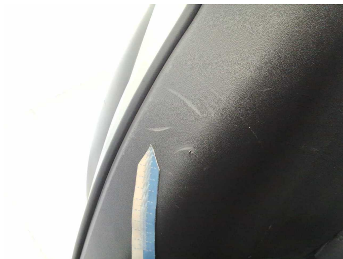
Beschädigung 8: Verkleidungen/Abdeckungen: C-Säule rechts Verkleidung innen - verkratzt / verschürft - erneuern
