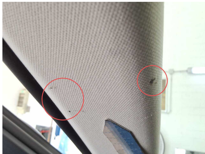
Beschädigung 5: Verkleidungen/Abdeckungen: A-Säule links Verkleidung innen - Brandloch - erneuern
