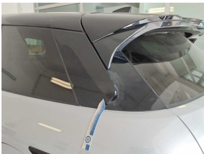
Beschädigung 12: Verglasung: Seitenscheibe hinten links (Blende) - Lackmangel - erneuern
