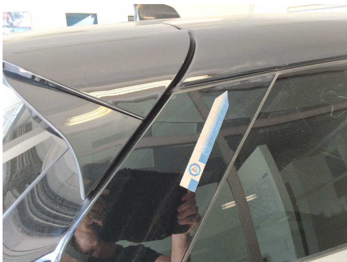
Beschädigung 14: Verglasung: Seitenscheibe hinten rechts (Blende) - Lackmangel - erneuern
