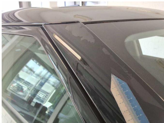
Beschädigung 10: Verglasung: Frontscheibe (Blende rechte Seite) - Lackmangel - erneuern
