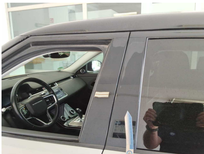
Beschädigung 15: Verglasung: Türscheibe hinten links (Blende) - Lackmangel - erneuern
