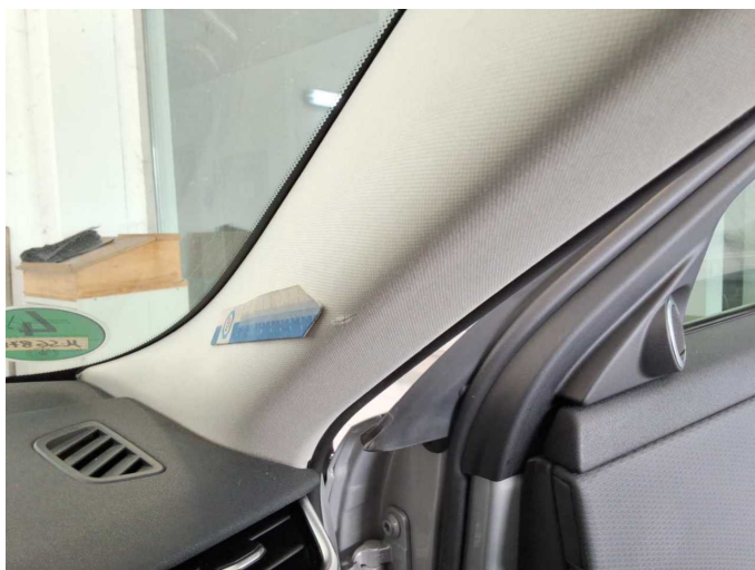
Beschädigung 6: Verkleidungen/Abdeckungen: A-Säule rechts Verkleidung innen - beschädigt - erneuern
