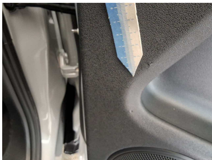
Beschädigung 4: Verkleidungen/Abdeckungen: Türverkleidung hinten rechts - beschädigt - Wertminderung
