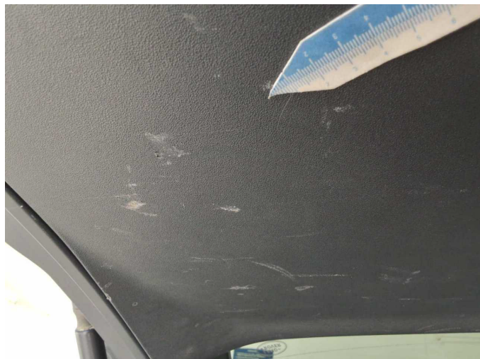
Beschädigung 3: Verkleidungen/Abdeckungen: Heckdeckel, Innenverkleidung - verkratzt / verschürft - Smart Repair
