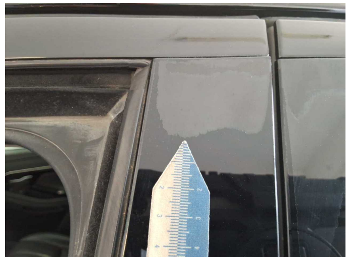
Beschädigung 2: Verglasung: Türscheibe vorn links (Blende) - Lackmangel - erneuern
