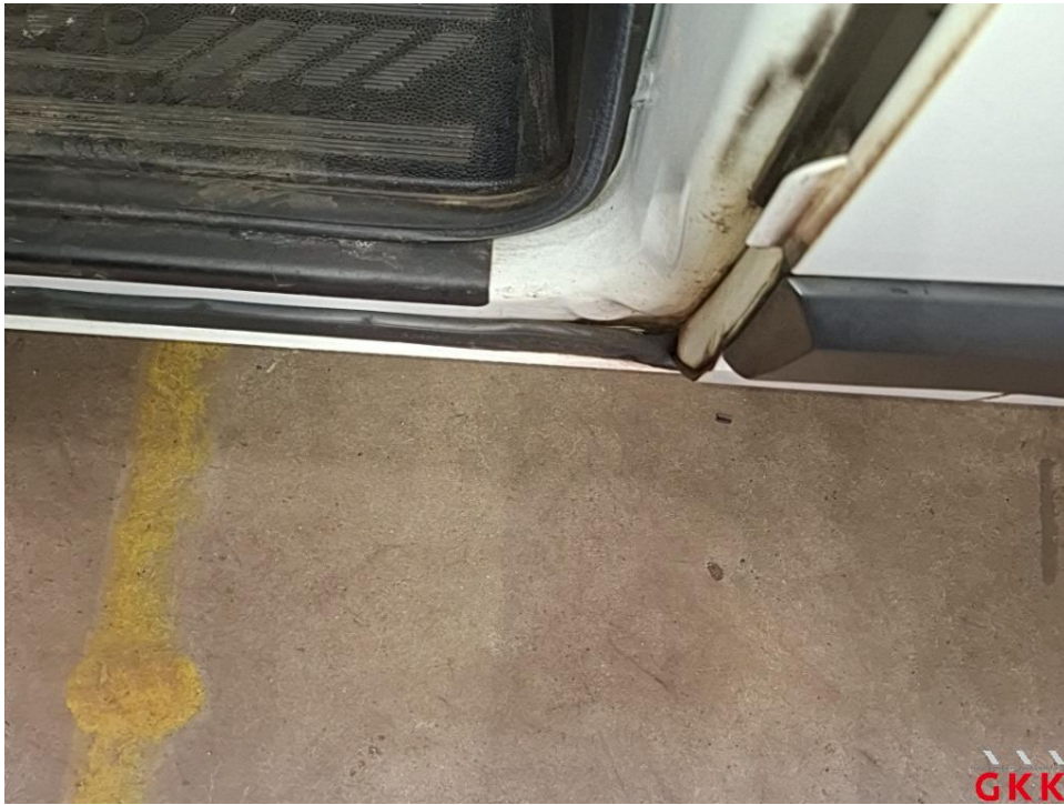
Bild 29 Tür vorne links, Dichtung -Einstieg-, beschädigt, ersetzen
