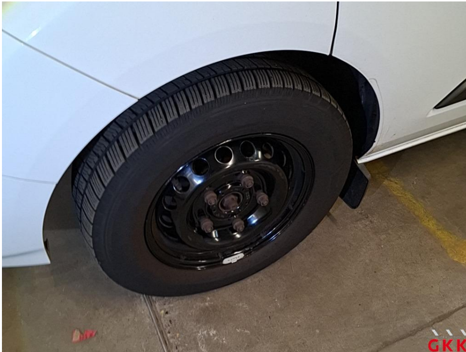
Bild 17 Radkappe(n), vorne links, fehlt, ersetzen
