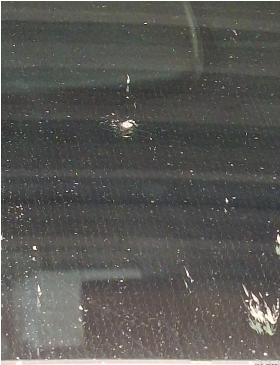
Bild 24 Frontscheibe, beheizt, Steinschlag mit Rissbildung, ersetzen
