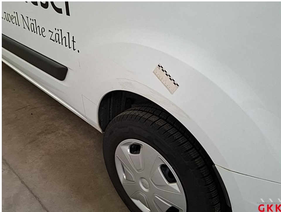
Bild 33 Seitenwand links, beschädigt, instand setzen - lackieren
