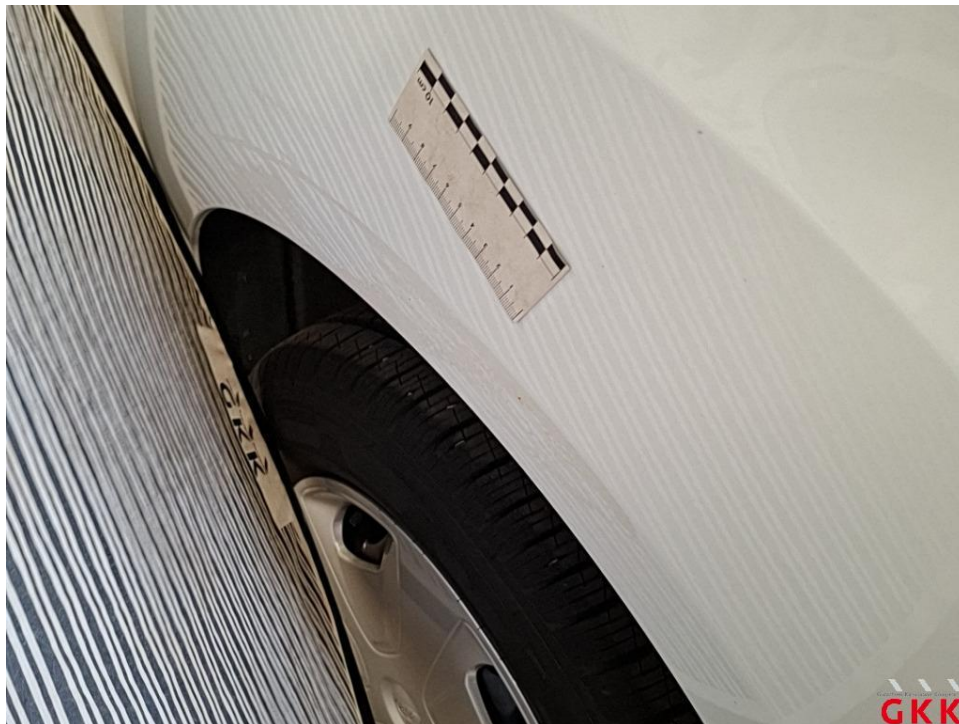
Bild 34 Seitenwand links, beschädigt, instand setzen - lackieren
