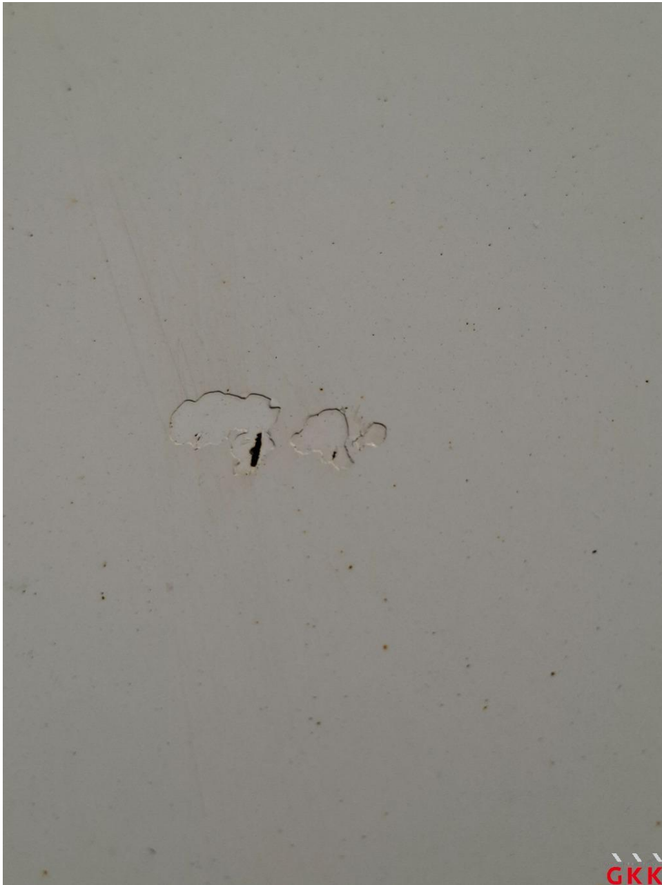
Bild 28 Motorhaube, beschädigt, instand setzen - lackieren
