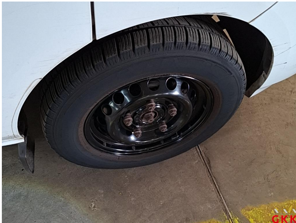
Bild 16 Radkappe(n), vorne rechts, fehlt, ersetzen
