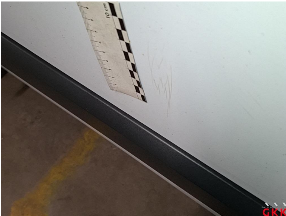
Bild 32 Tür vorne links, verkratzt, lackieren
