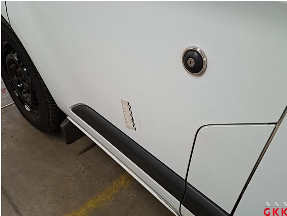
Bild 31 Tür vorne links, verkratzt, lackieren
