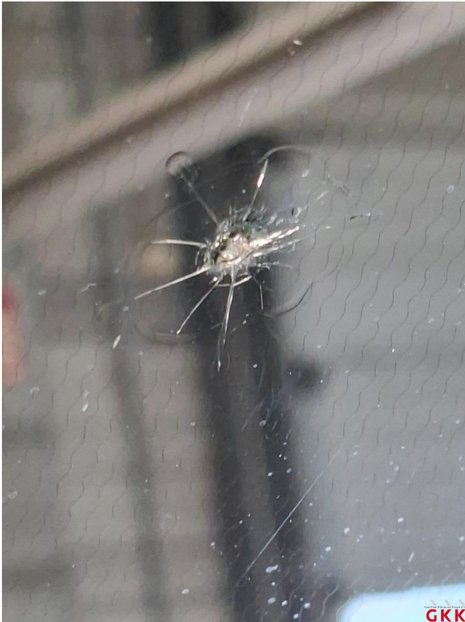
Bild 25 Frontscheibe, beheizt, Steinschlag mit Rissbildung, ersetzen
