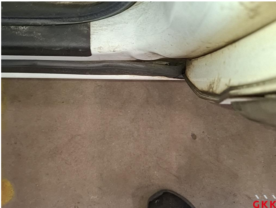
Bild 30 Tür vorne links, Dichtung -Einstieg-, beschädigt, ersetzen
