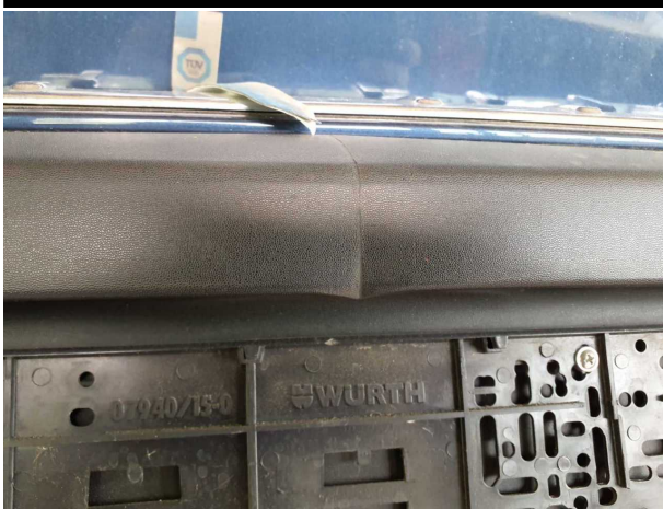
Beschädigung #2: Stossfänger hinten: Stossfänger mit Parktronic (unlackiert) - verformt - erneuern
