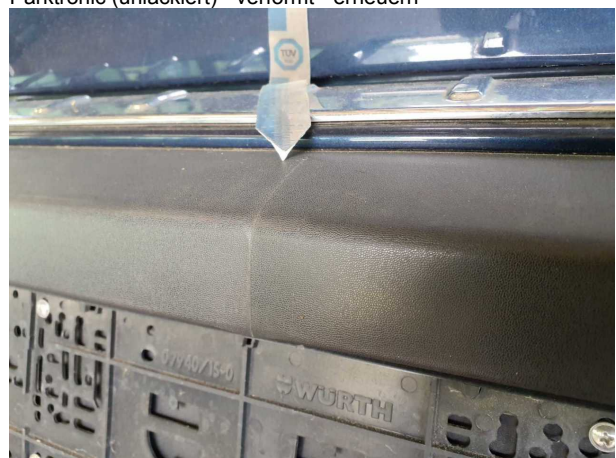
Beschädigung #2: Stossfänger hinten: Stossfänger mit Parktronic (unlackiert) - verformt - erneuern
