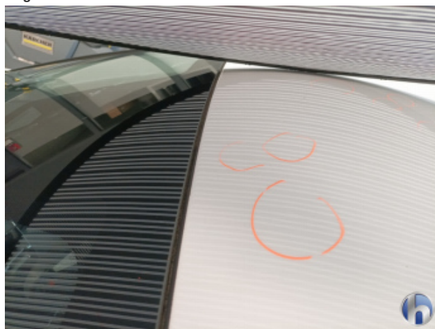
1. Dach Hagelschaden - Sanft Instandsetzen
