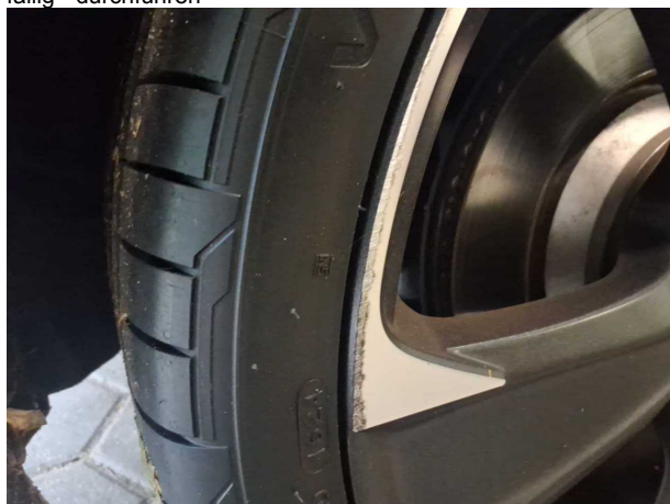
Beschädigung #2: Rad/Reifen: Leichtmetallfelge hinten rechts (Materialabrieb) - verkratzt / verschürft - erneuern
