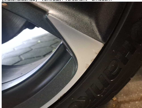
Beschädigung #2: Rad/Reifen: Leichtmetallfelge hinten rechts (Materialabrieb) - verkratzt / verschürft - erneuern
