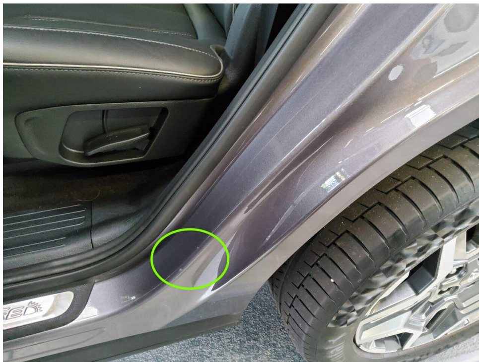
Bild 9 : Türeinstieg hinten links, verschrammt
