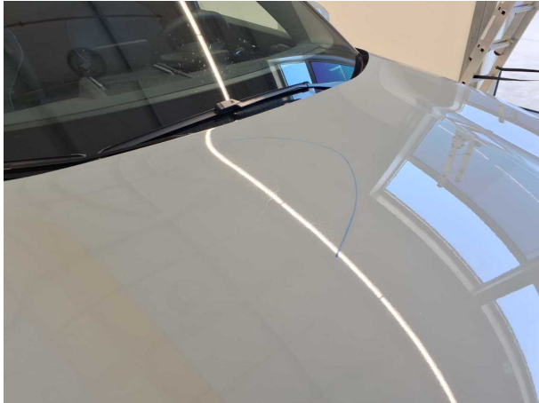
Beschädigung #1: Motorhaube: Motorhaube (Anätzung) - verschmutzt - auslegen / polieren
