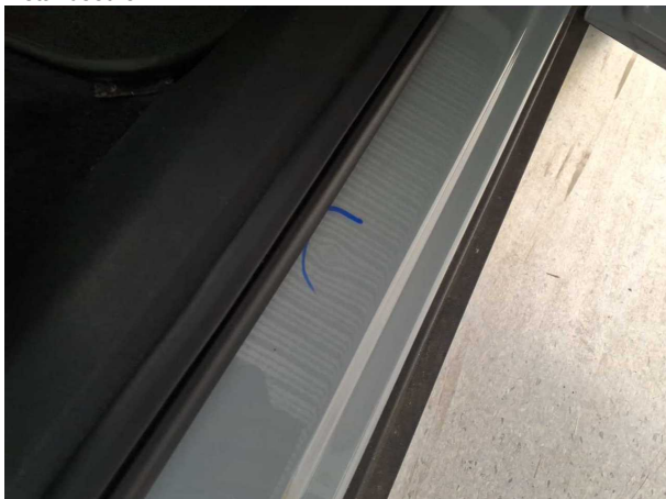
Beschädigung #6: Schweller rechts: Einstieg (1x) - Delle(n) - sanft instandsetzen
