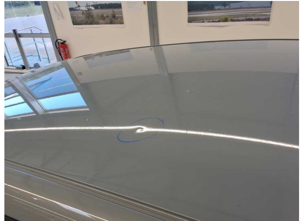
Beschädigung #5: Fahrzeugdach: Dach (1x) - Delle(n) - sanft instandsetzen
