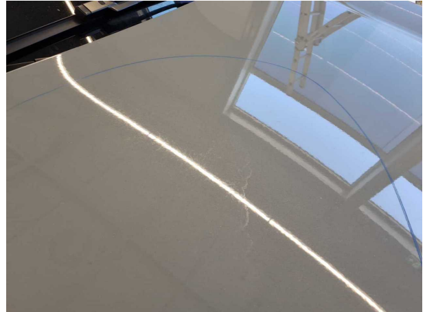
Beschädigung #1: Motorhaube: Motorhaube (Anätzung) - verschmutzt - auslegen / polieren
