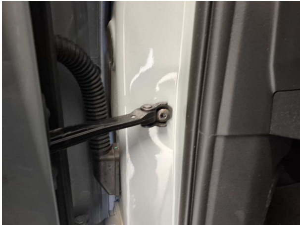
Beschädigung #4: Tür vorn links: Fangband / Feststeller (Knackt und ist;lose) - lose - befunden ggf. instandsetzen
