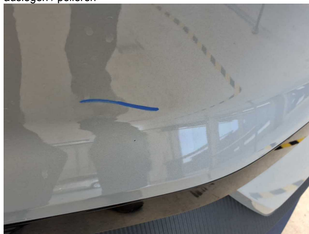
Beschädigung #3: Stossfänger vorn: Stossfänger vorn - Kratzer - auslegen / polieren
