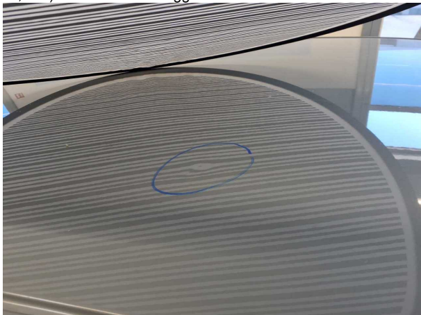
Beschädigung #5: Fahrzeugdach: Dach (1x) - Delle(n) - sanft instandsetzen
