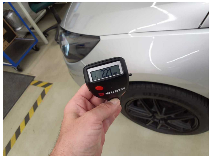
Mudguard - left side: 221 µm
