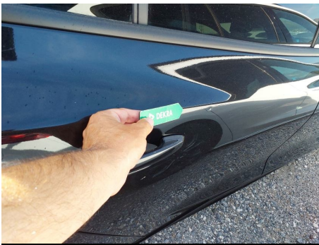
Puerta / Trasero Derecho / Abolladura
