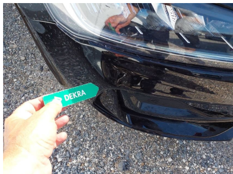
Paragolpes / Delantero / Abolladura
