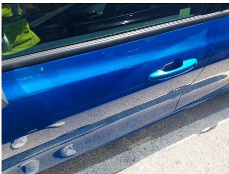
Puerta / Delantero Izquierdo / Abolladura
