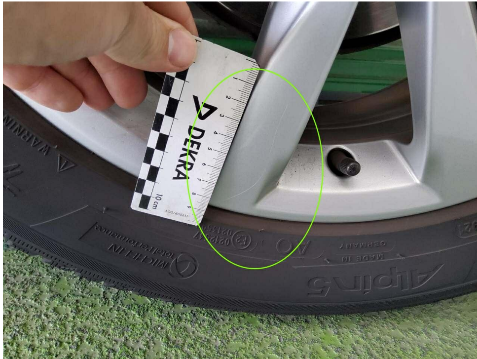
Bild 15 : Felge hinten links Lackierung, zerkratzt, polieren
