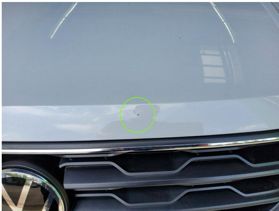
Bild 14 : Motorhaube Lackierung, Steinschlag, Gebrauchsspur
