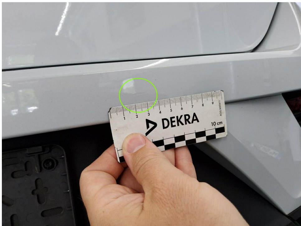
Bild 16 : Stoßfänger hinten Lackierung, zerkratzt, polieren
