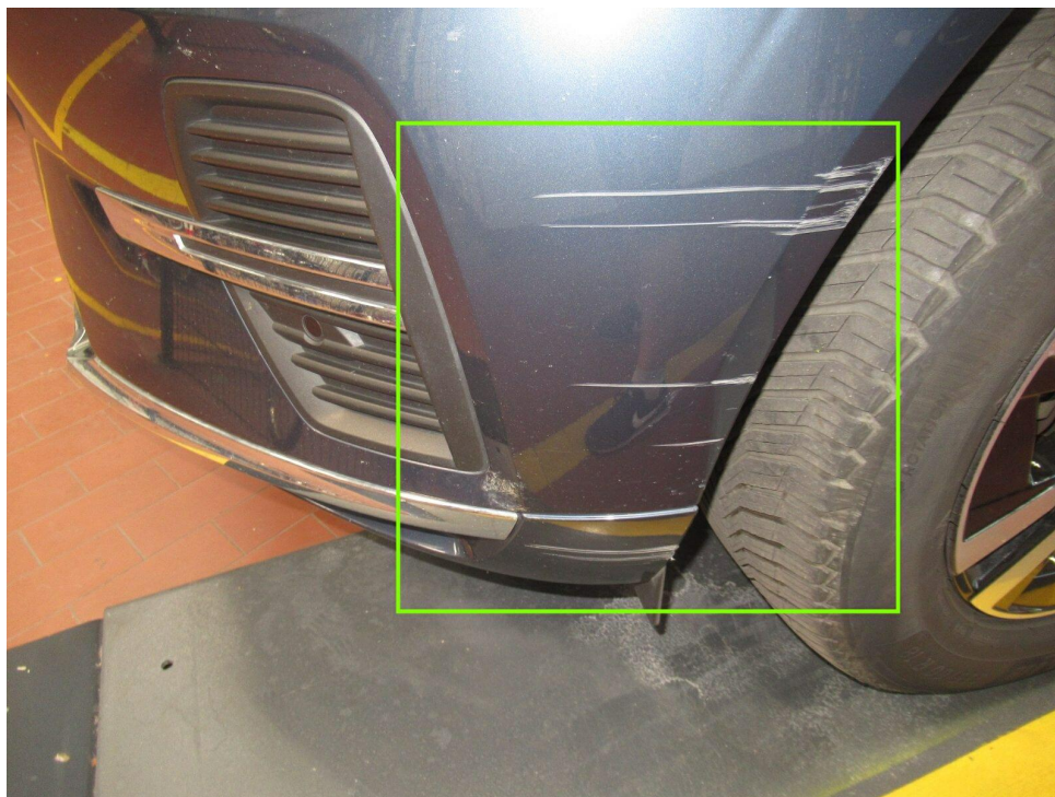
Bild 9 : Stoßfänger vorne verschrammt
