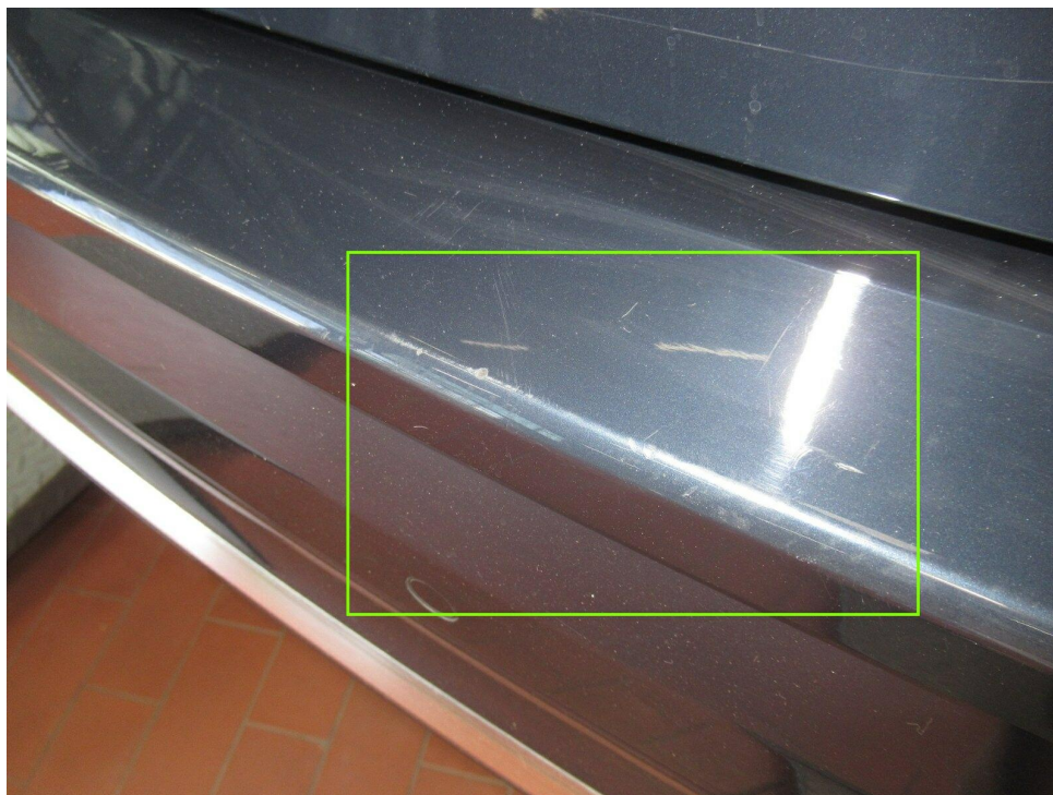
Bild 11 : Stoßfänger hinten zerkratzt, eingekerbt
