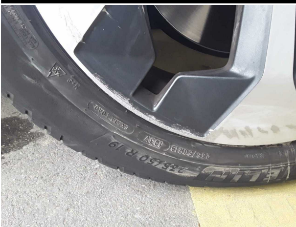
Beschädigung #4: Rad/Reifen: Leichtmetallfelge vorn rechts - verkratzt / verschürft - erneuern
