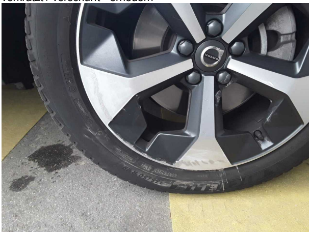
Beschädigung #4: Rad/Reifen: Leichtmetallfelge vorn rechts - verkratzt / verschürft - erneuern
