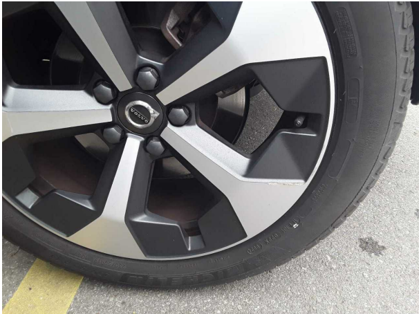
Beschädigung #2: Rad/Reifen: Leichtmetallfelge hinten links - verkratzt / verschürft - erneuern
