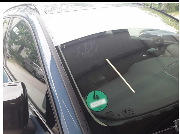
Beschädigung #5: Verglasung: Frontscheibe - gebrochen / gerissen - erneuern
