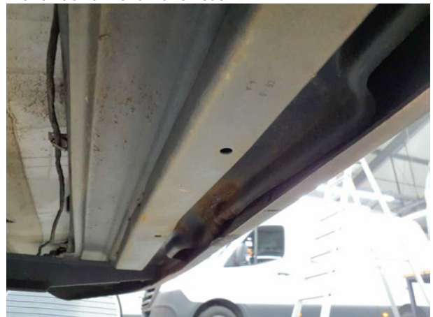
Beschädigung #7: Stossfänger hinten: Träger Stossfänger Auftritt mit Parktronic - verformt - erneuern
