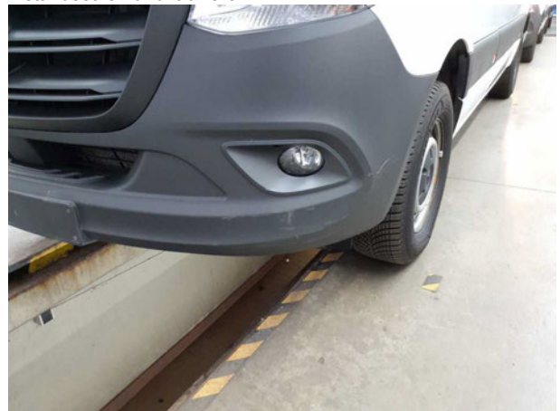
Beschädigung #11: Stossfänger vorn: Stossfänger vorn - Kratzer - erneuern
