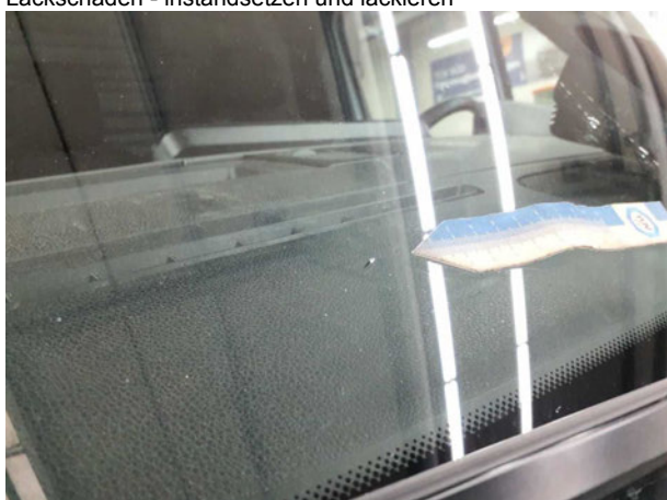
Beschädigung #14: Verglasung: Frontscheibe - Steinschlag - erneuern
