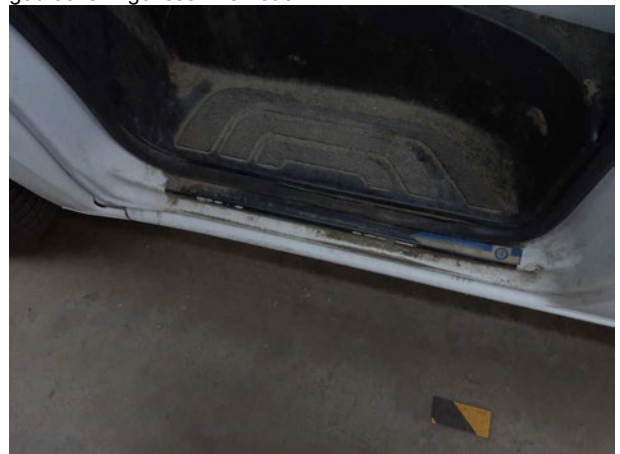
Beschädigung #6: Schweller links: Einstieg - Lackmangel - lackieren
