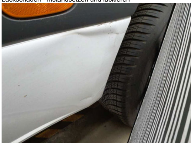
Beschädigung #13: Seitenwand links: Seitenwand - Delle / Lackschaden - instandsetzen und lackieren
