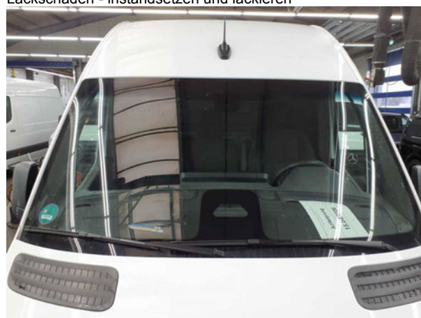
Beschädigung #14: Verglasung: Frontscheibe - Steinschlag - erneuern
