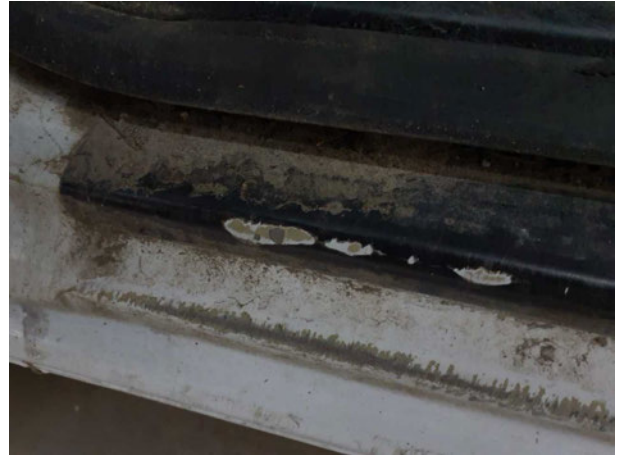
Beschädigung #6: Schweller links: Einstieg - Lackmangel - lackieren
