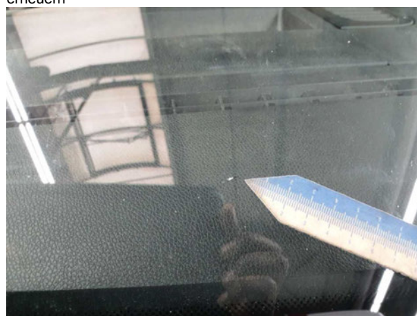
Beschädigung #14: Verglasung: Frontscheibe - Steinschlag - erneuern
