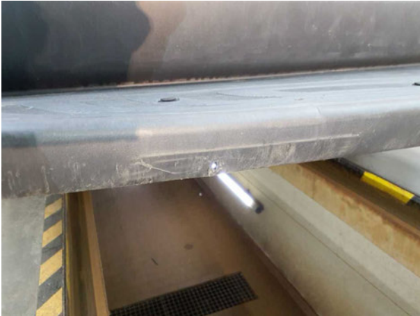
Beschädigung #9: Stossfänger hinten: Verkl. Stossfänger Auftritt mit Parktronic - gebrochen / gerissen - erneuern
