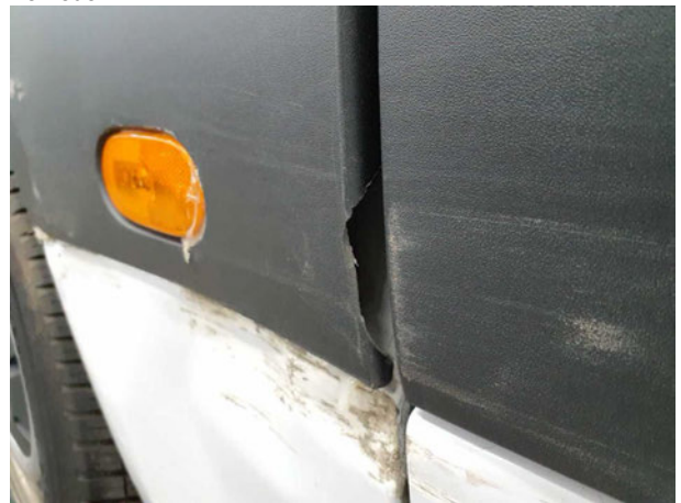
Beschädigung #3: Seitenwand rechts: Schutzleiste - gebrochen / gerissen - erneuern
