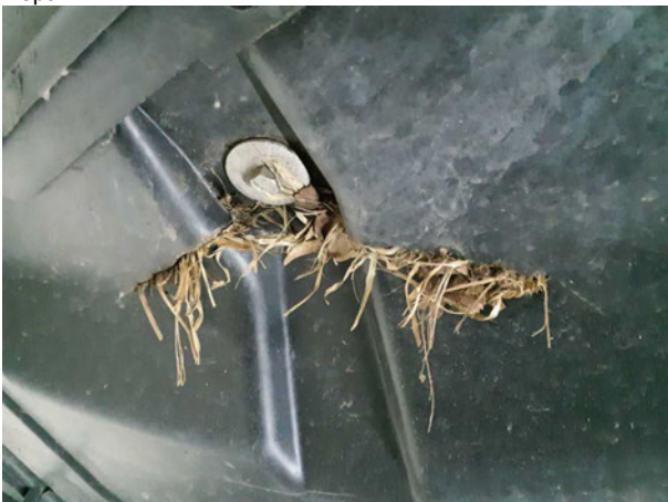
Beschädigung #5: Motor: Motorverkleidung unten vorn - gebrochen / gerissen - erneuern
