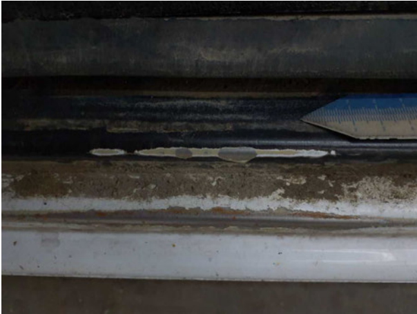
Beschädigung #6: Schweller links: Einstieg - Lackmangel - lackieren
