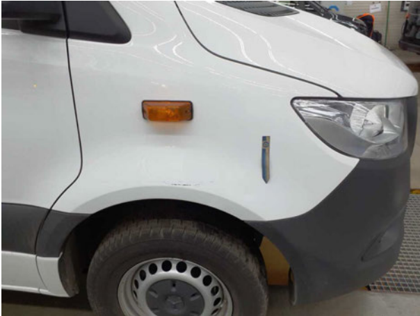
Beschädigung #4: Kotflügel rechts: Kotflügel rechts - Delle(n) - Smart Repair
