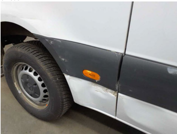
Beschädigung #3: Seitenwand rechts: Schutzleiste - gebrochen / gerissen - erneuern
