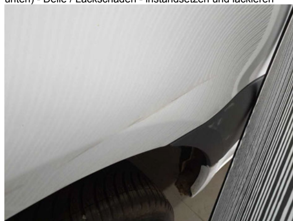
Beschädigung #8: Seitenwand rechts: Seitenwand (Bepankung unten) - Delle / Lackschaden - instandsetzen und lackieren
