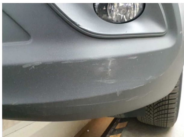
Beschädigung #11: Stossfänger vorn: Stossfänger vorn - Kratzer - erneuern
