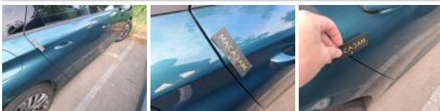
Door RR, Scratch(es), Acceptable
