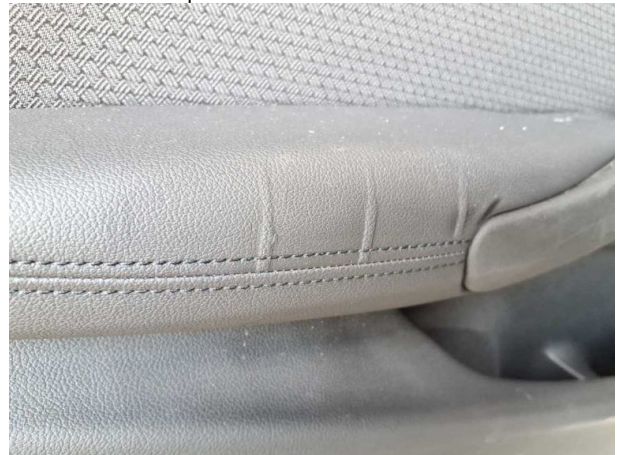
Beschädigung #2: Verkleidungen/Abdeckungen: Türverkleidung hinten links (Armlehne) - Delle(n) - erneuern
