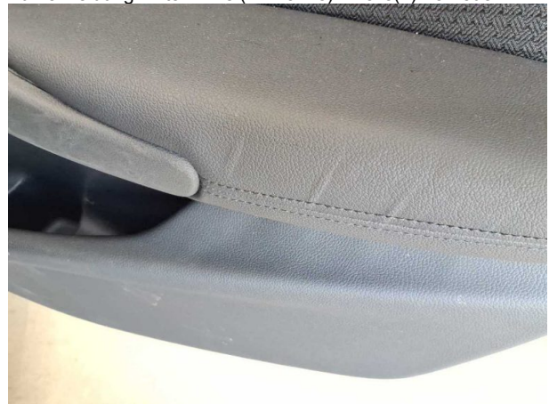
Beschädigung #3: Verkleidungen/Abdeckungen: Türverkleidung hinten rechts (Armlehne) - Delle(n) - erneuern
