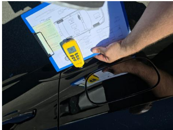
Nachlackierung 1: Dachholm rechts, Seitenwand rechts
