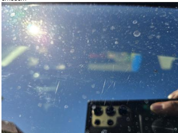
Beschädigung #1: Verglasung: Türscheibe hinten links - Kratzer - erneuern
