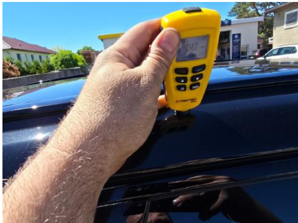
Nachlackierung 1: Dachholm rechts, Seitenwand rechts
